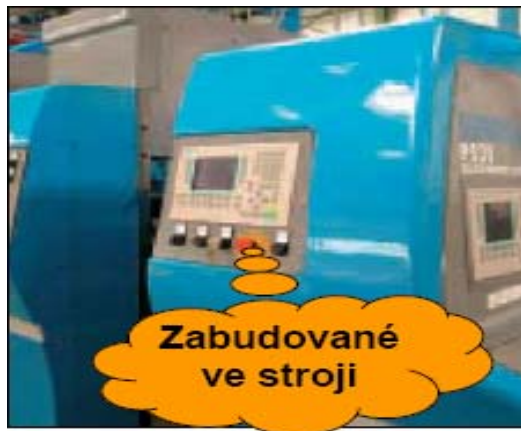
Obr. 28 Panel SIMATIC HMI zabudovaný ve stroji
