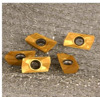
Obr. 9: . Porovnání povlaků při testech frézování nástrojové oceli
