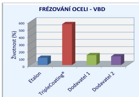
Obr. 9: . Porovnání povlaků při testech frézování nástrojové oceli
