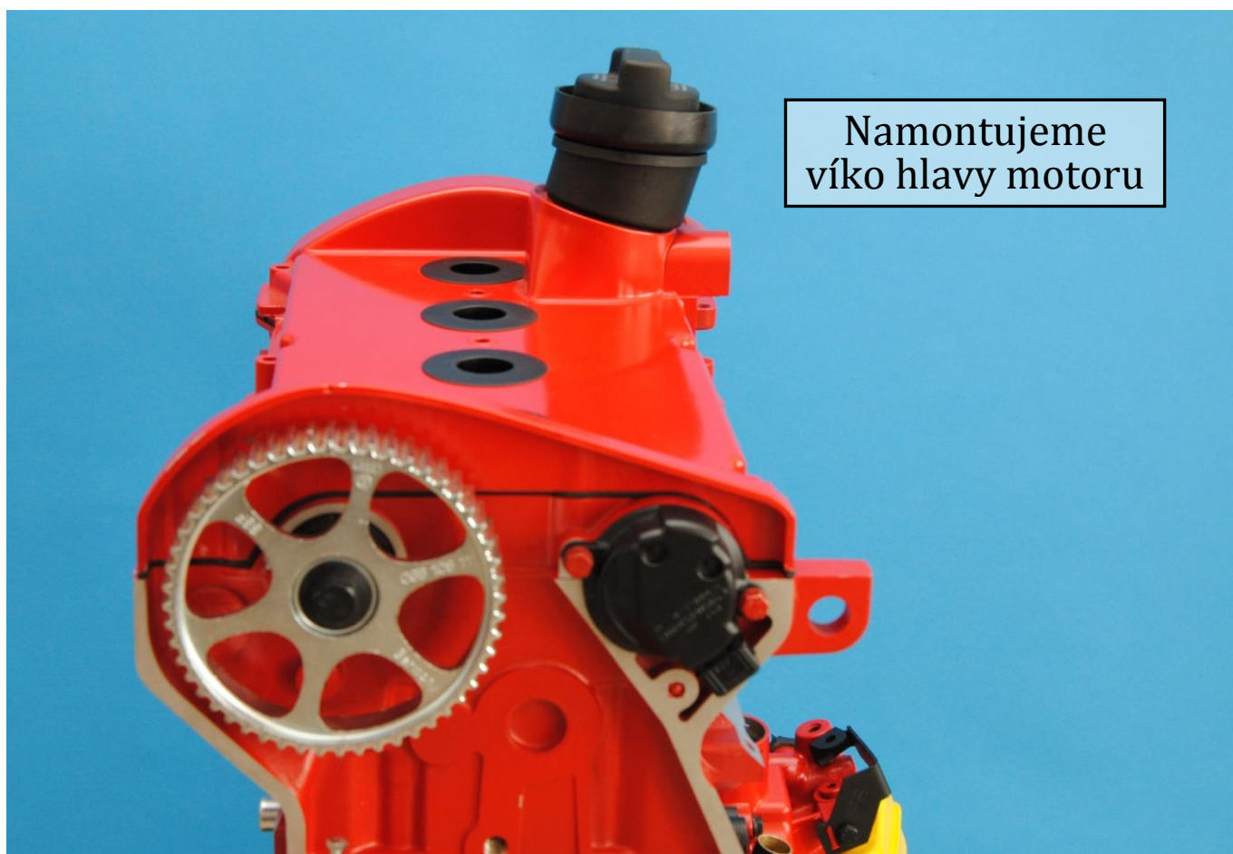
Obr. 24: Montáž víka hlavy motoru
