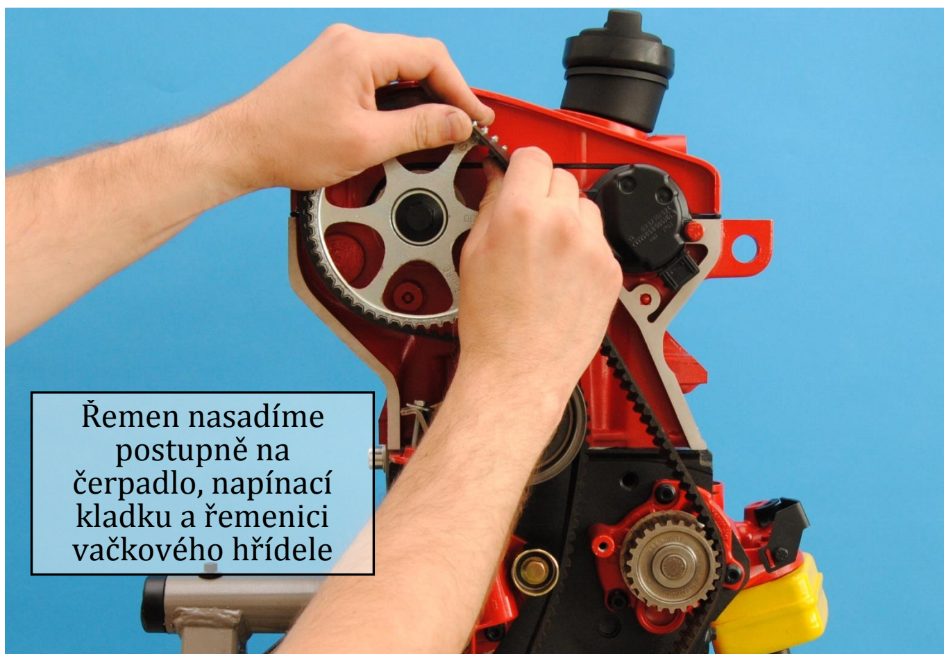
Obr. 20: Nasazení rozvodového řemene
