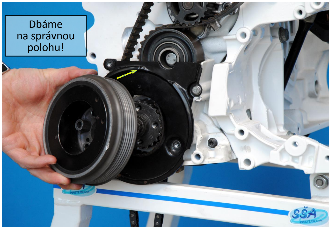
Obr. 42: Montáž řemenice klikové hřídele
