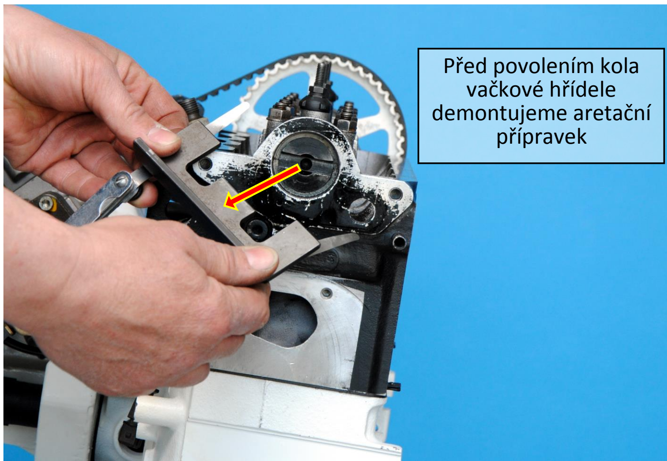
Obr. 9: Demontáž aretačního přípravku
