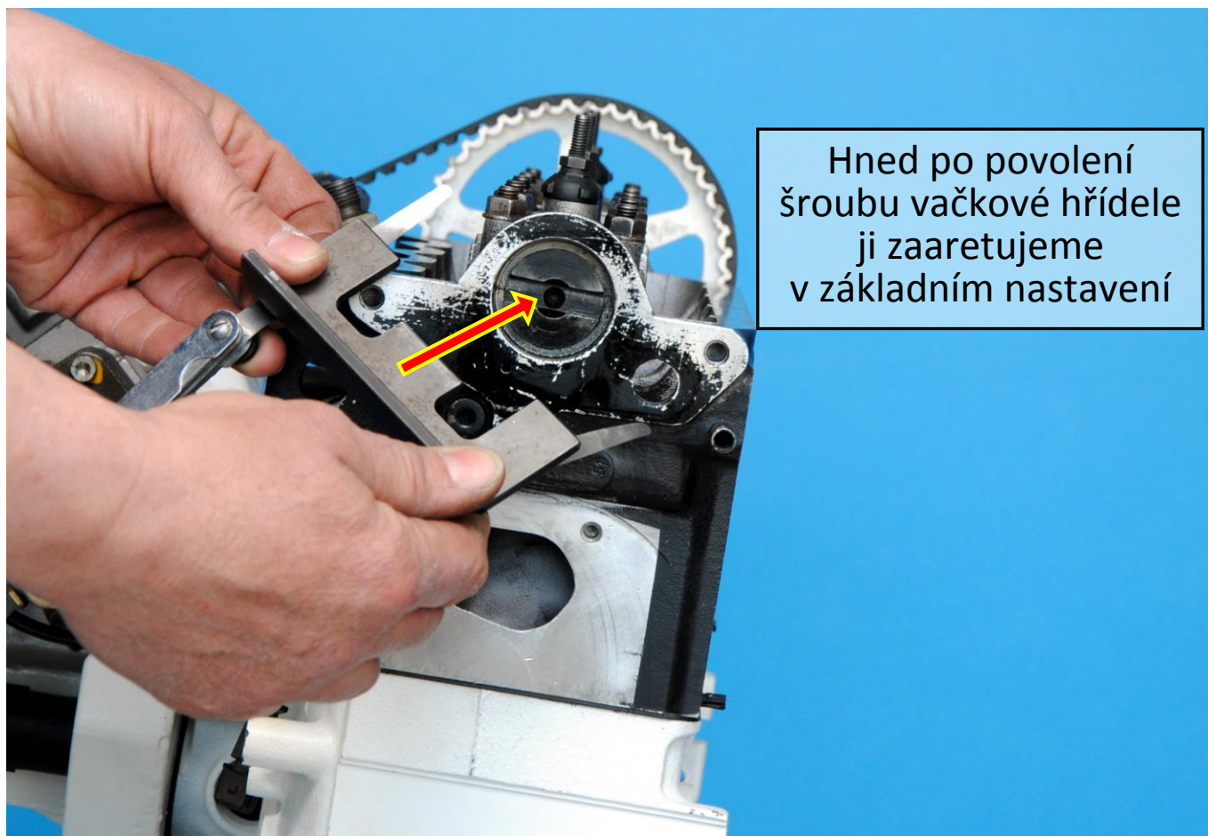
Obr. 11: Aretace vačkové hřídele v základním nastavení
