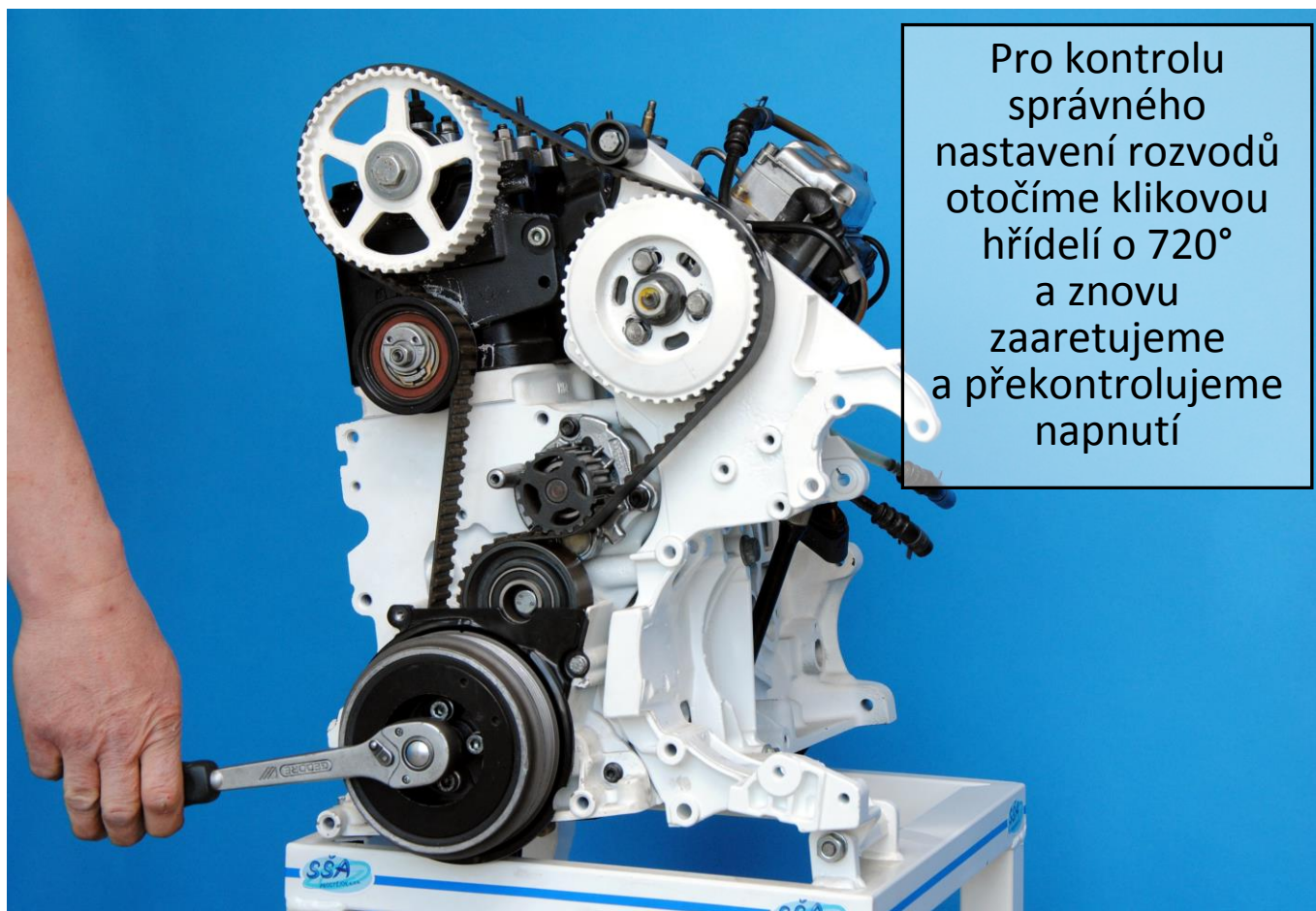
Obr. 52: Kontrola správného nastavení rozvodů
