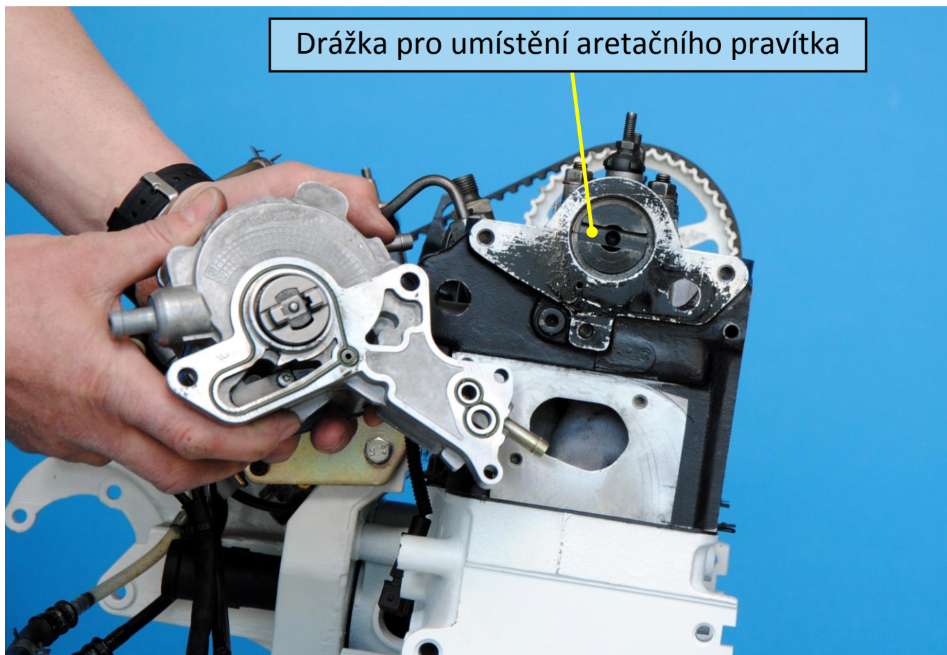
Obr. 4: Drážka pro pohon vývěvy a pro umístění přípravku na aretaci vačkové hřídele
