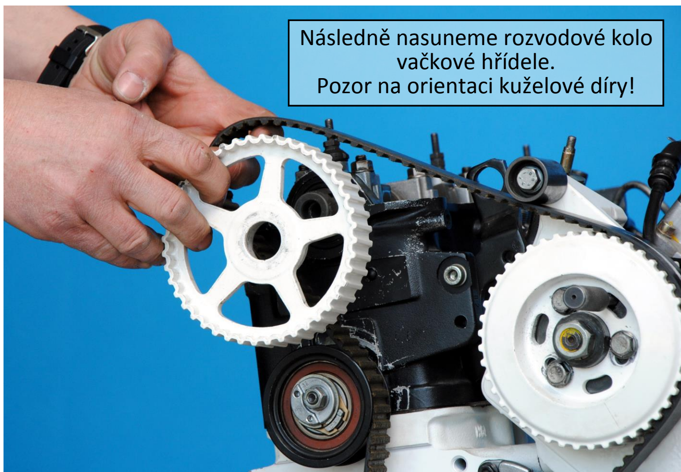
Obr. 44: Montáž rozvodového kola vačkové hřídele
