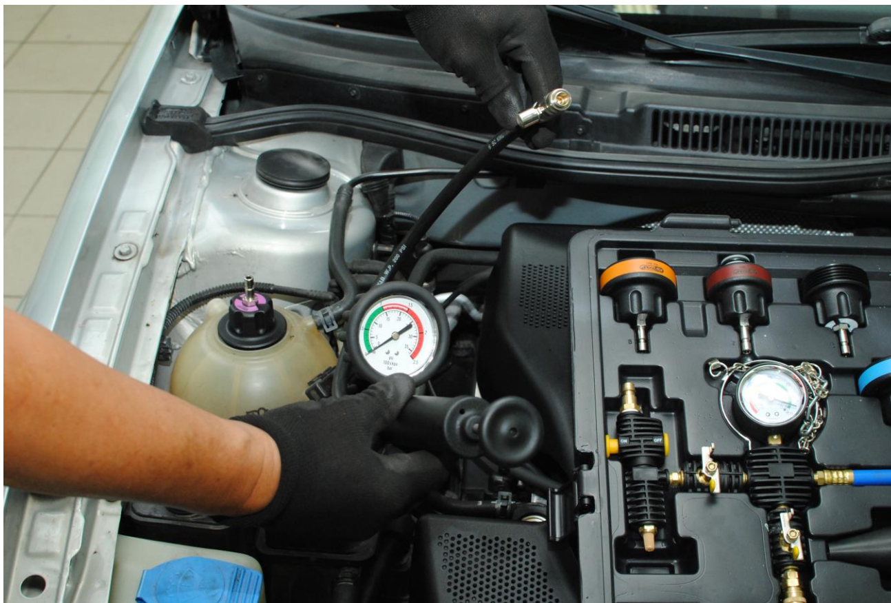
Obr. 6: Pro natlakování systému použijeme mechanickou pumpu
