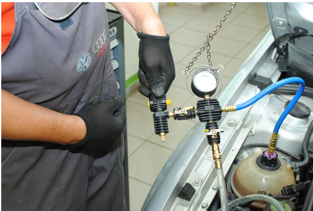
Obr. 26: Podtlak se zvyšuje a hladina kapaliny v expanzní nádobě stoupá
