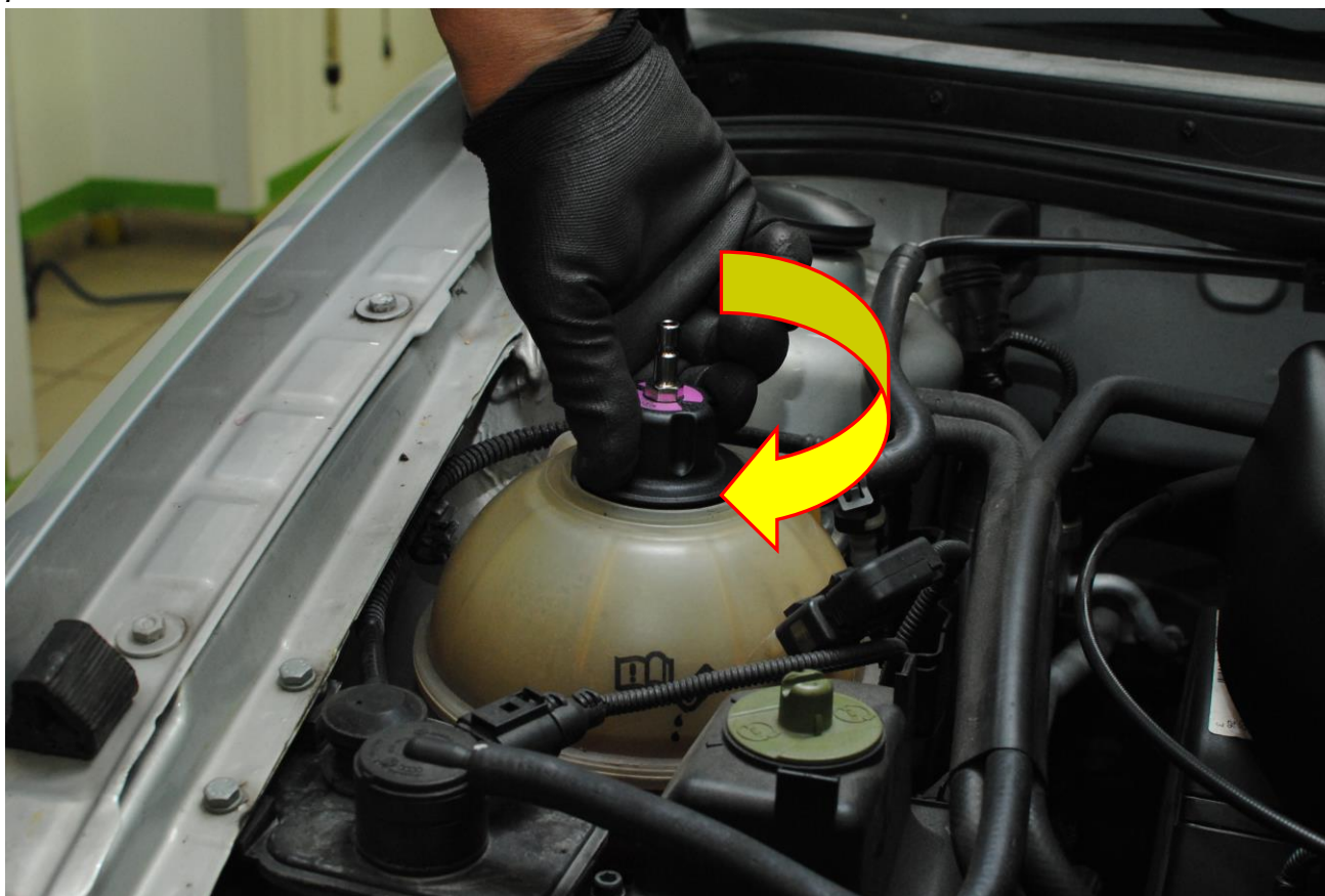
Obr. 5: Měřicí víčko pevně dotáhneme
