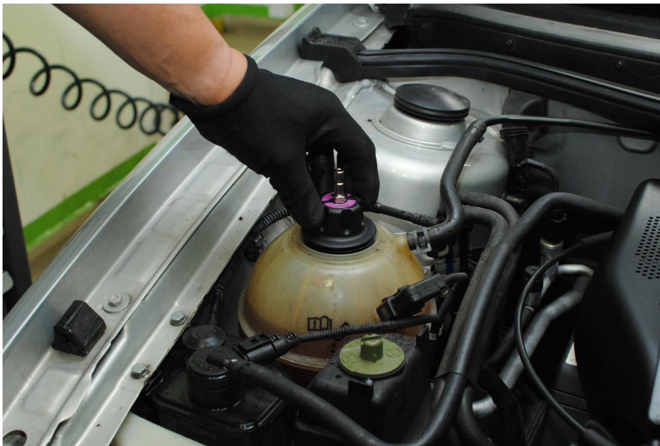
Obr. 14: Přes měřící víčko můžeme doplnit chladicí kapalinu
