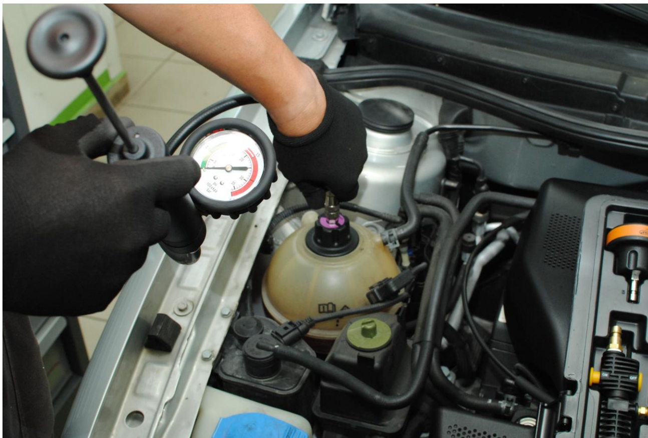
Obr. 13: Po vypuštění tlaku odpojíme pumpu
