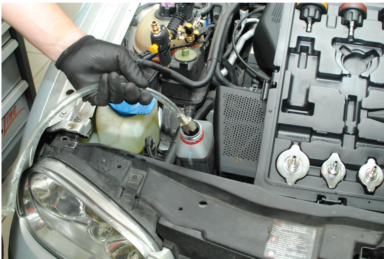
Obr. 20: Do nádoby s chladicí kapalinou umístíme sací hadici
