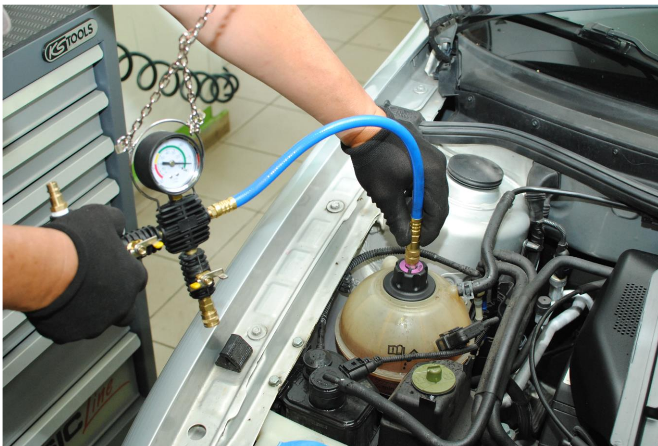
Obr. 17: Pomocí rychlospojky připojíme přístroj k měřicímu víčku
