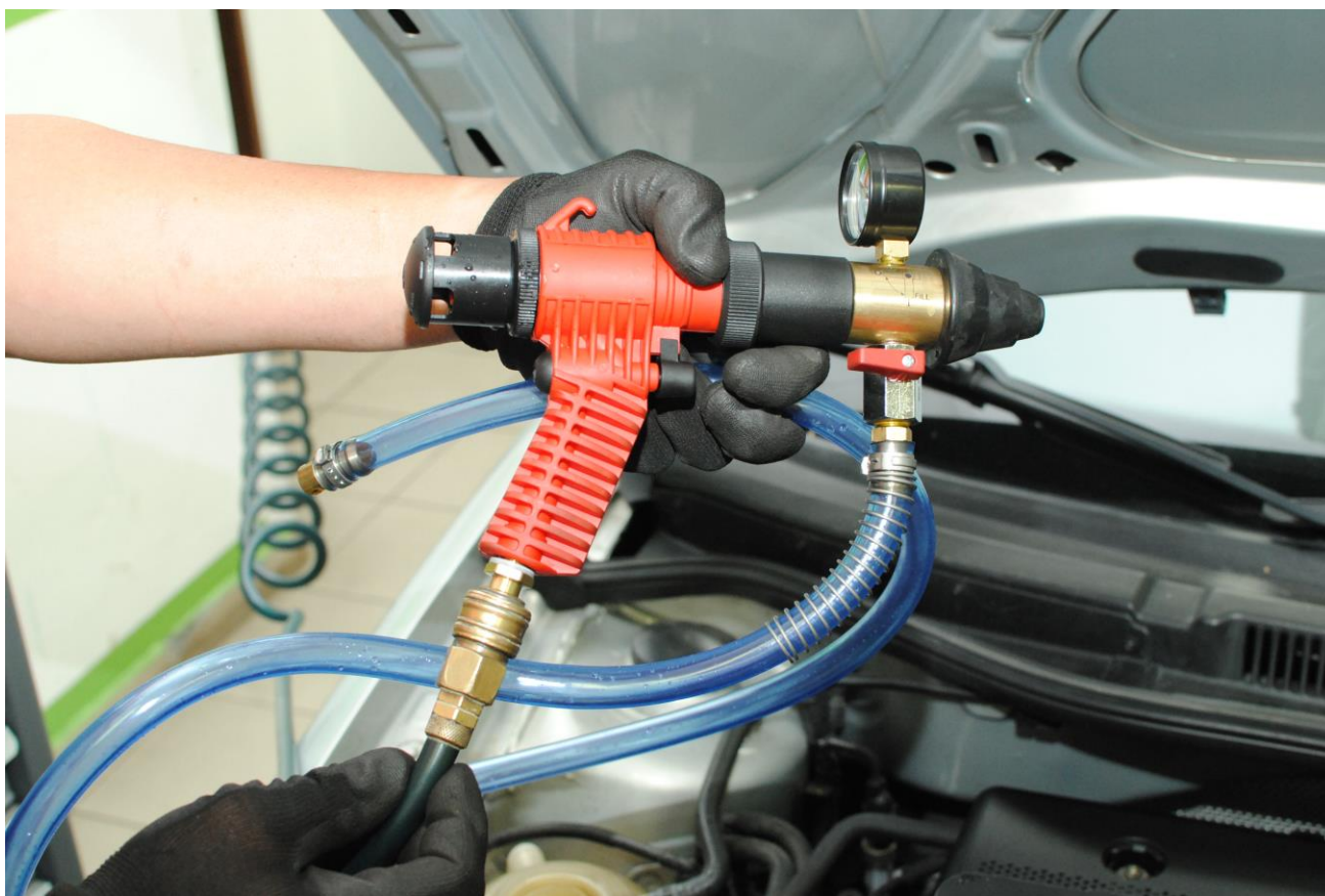
Obr. 35: Připojíme tlakový vzduch a překontrolujeme připojení rychlospojky
