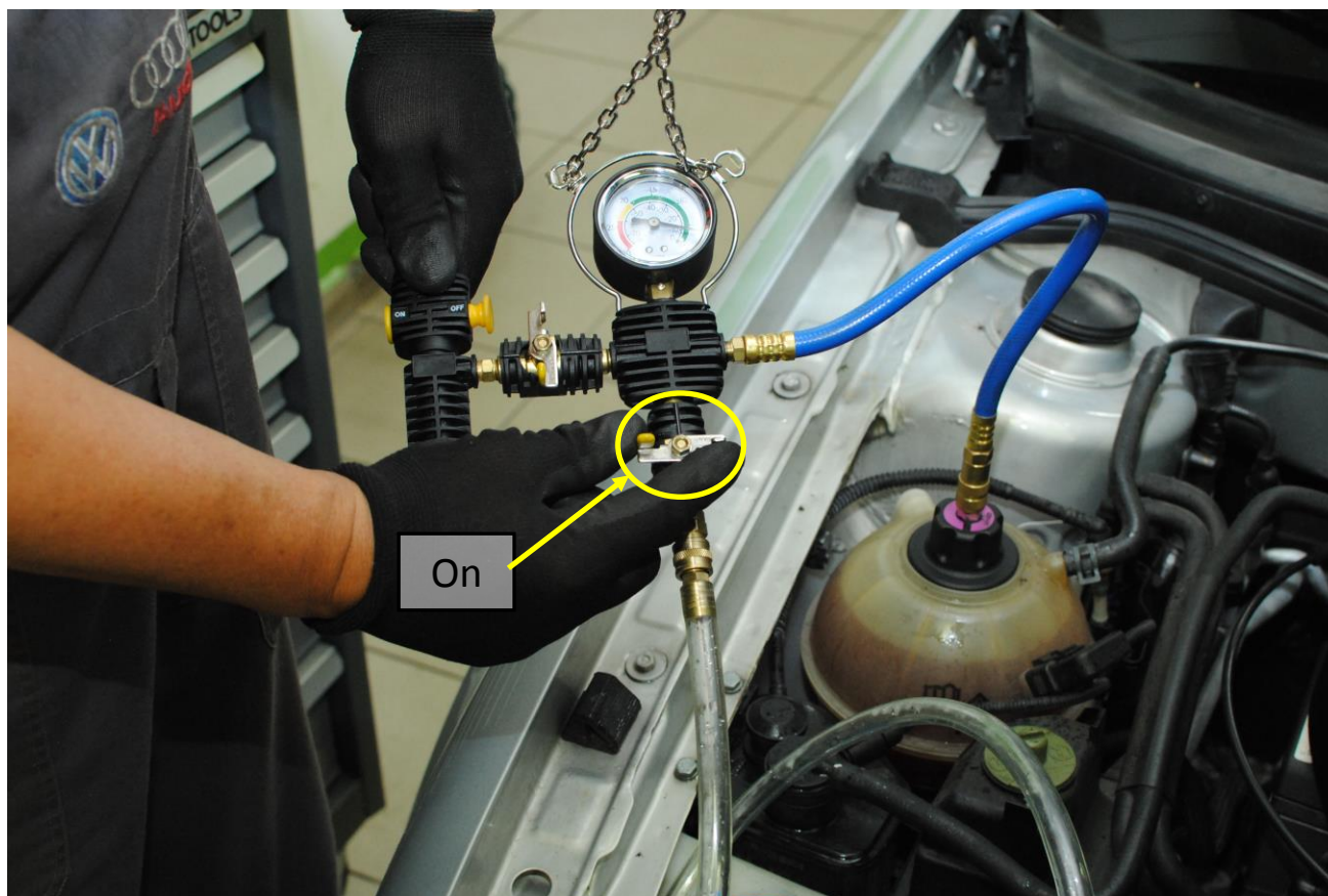
Obr. 28: Otevřeme ventil sací hadice
