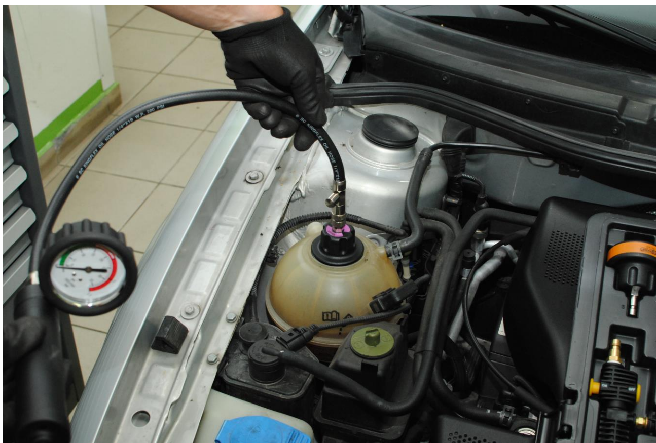
Obr. 7: Pumpu připojíme pomocí rychlospojky a spoj překontrolujeme
