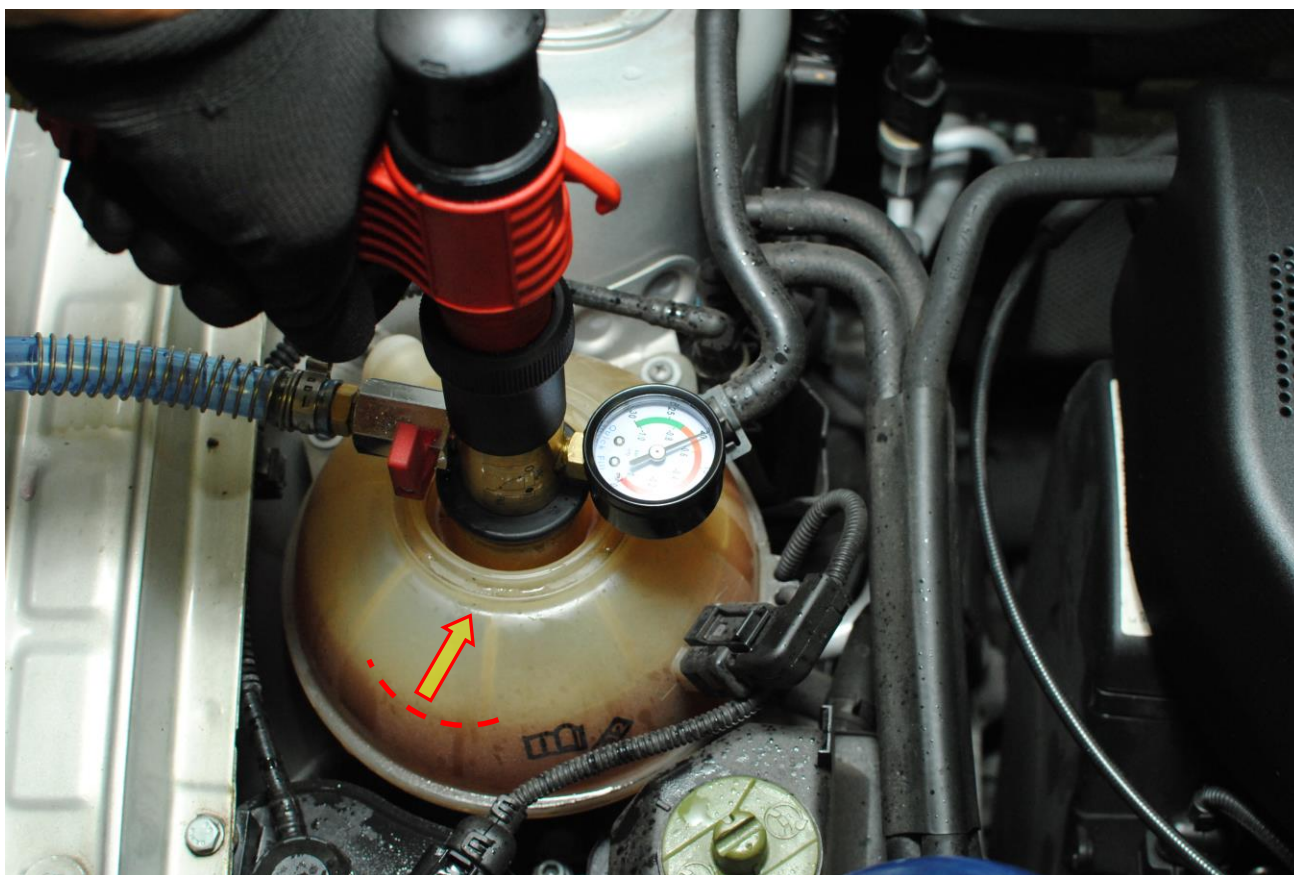
Obr. 39: Kapalina v expanzní nádobce stoupá
