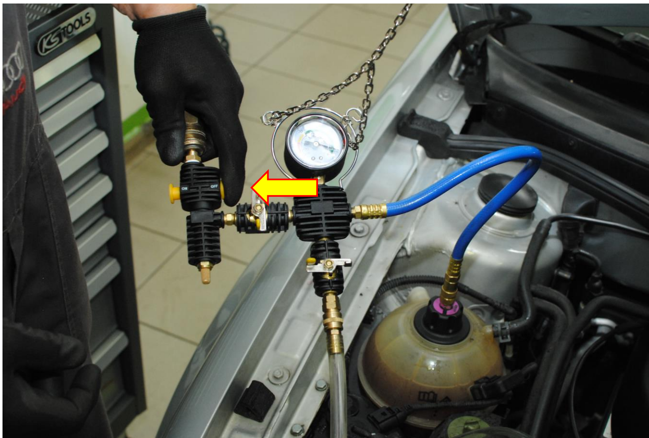
Obr. 31: Vypneme přívod stlačeného vzduchu
