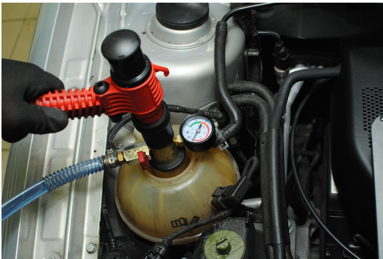
Obr. 36: Pryžový kužel umístíme do hrdla expanzní nádoby
