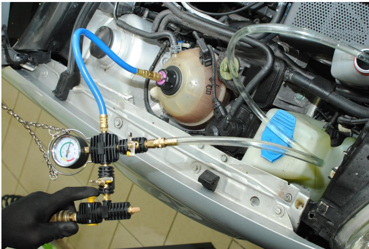
Obr. 30: Když se systém naplní, kapalina se v sací hadici zastaví
