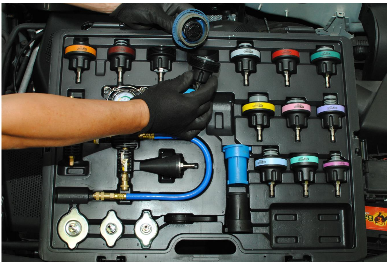
Obr. 3: Podle demontovaného uzávěru vybereme vhodné víčko
