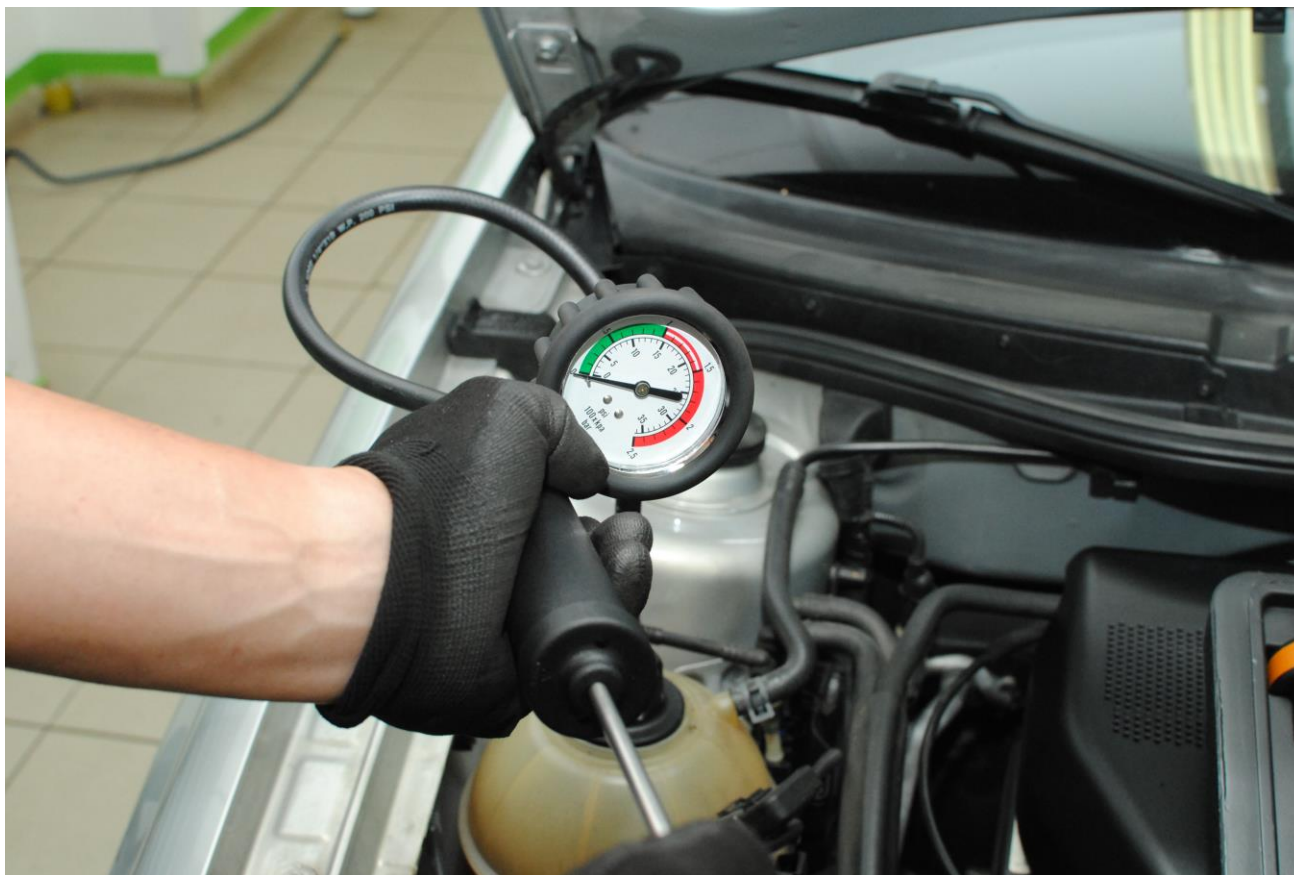
Obr. 8: Pohled na stupnici před měřením
