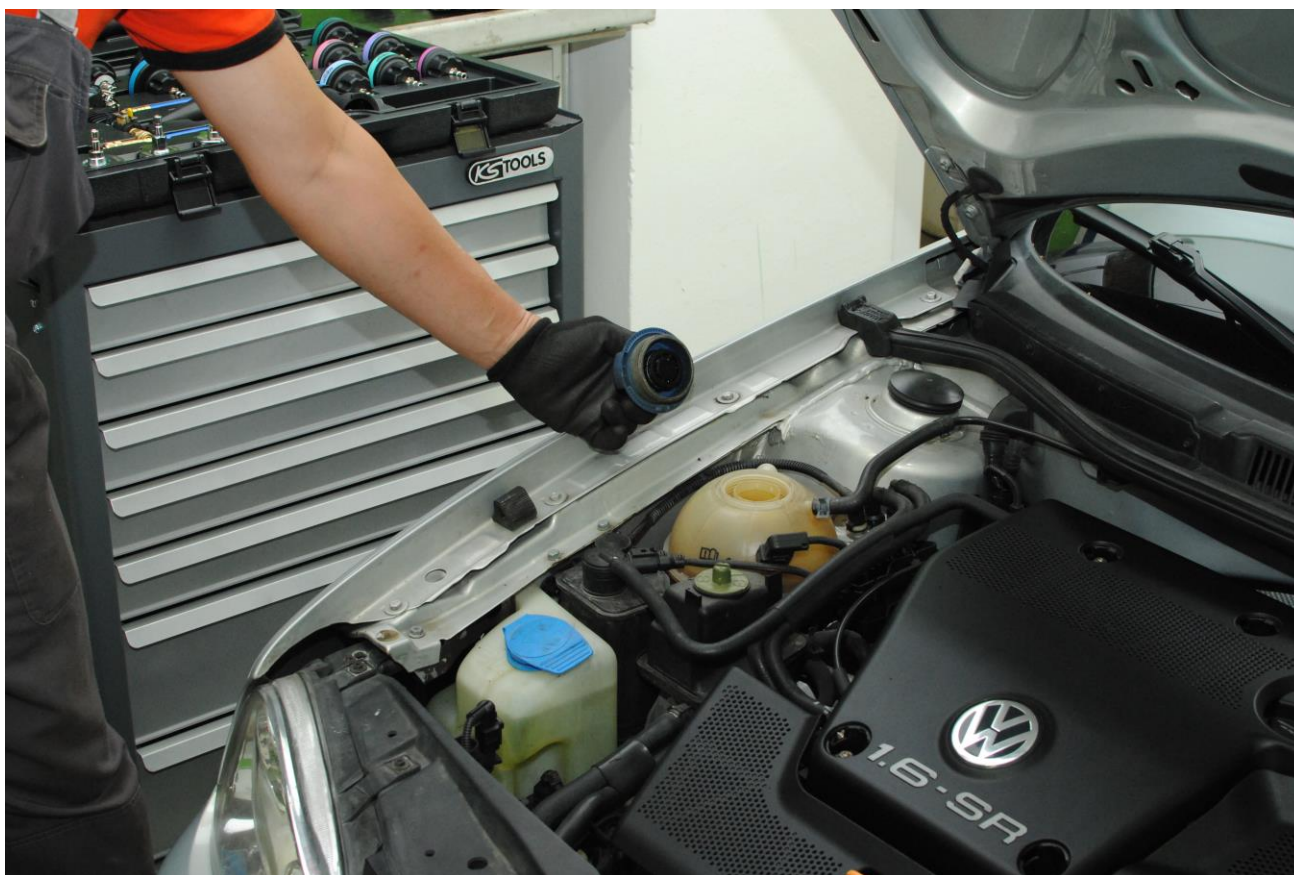
Obr. 2: Opatrně demontujeme uzávěr expanzní nádoby
