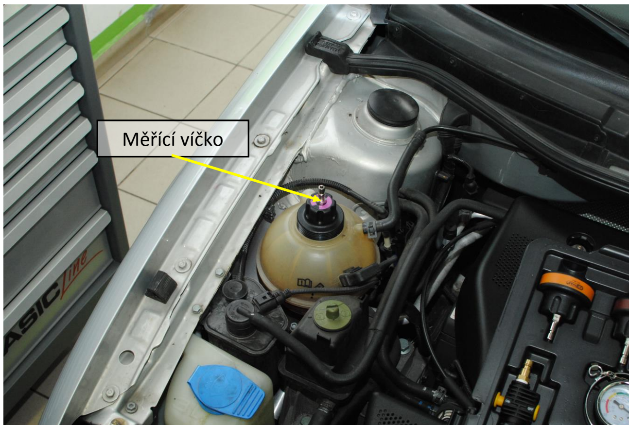
Obr. 4: Měřící víčko nasadíme na expanzní nádobku
