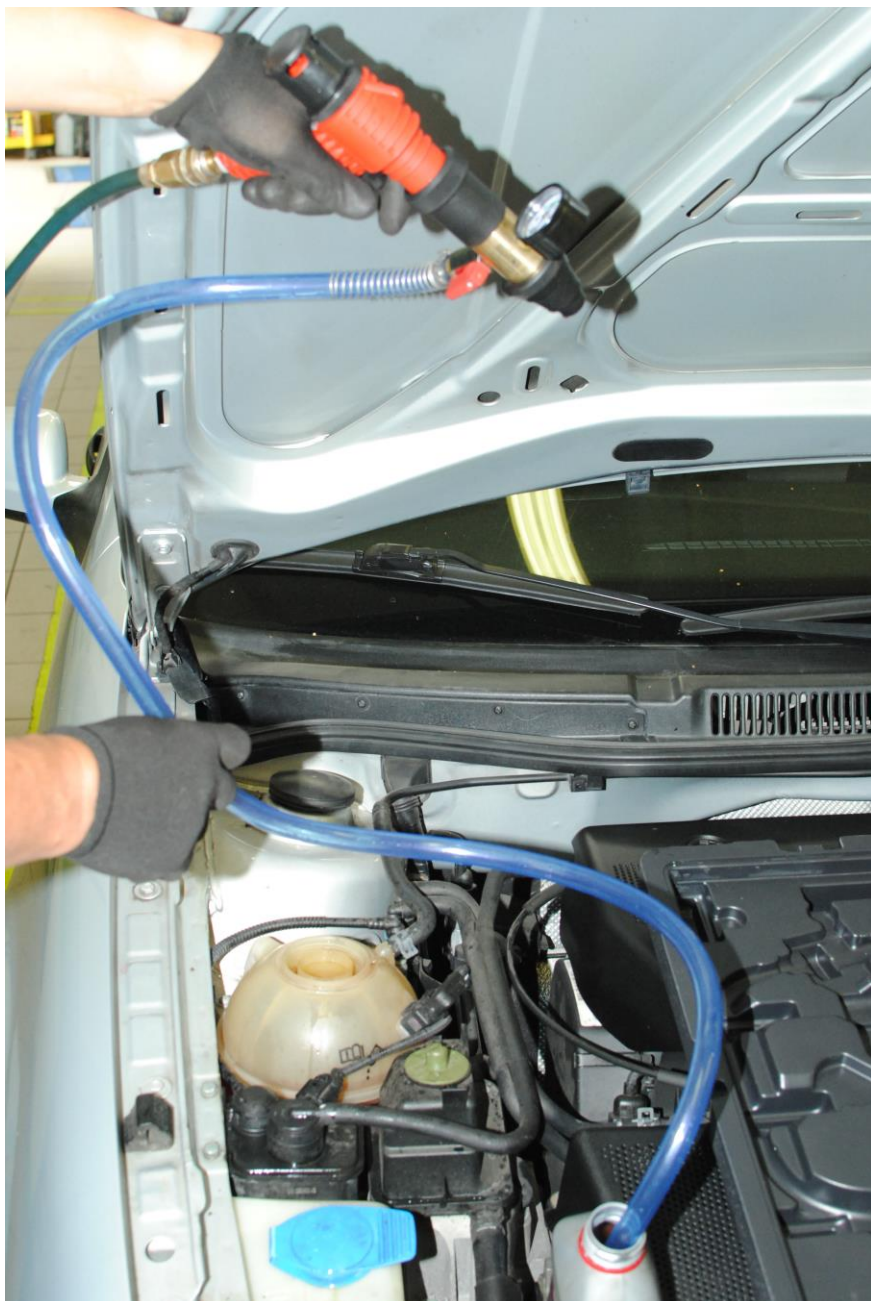
Obr. 44: Zbylou kapalinu necháme stéci do nádoby, odpojíme hadici a uzavřeme expanzní nádobu
