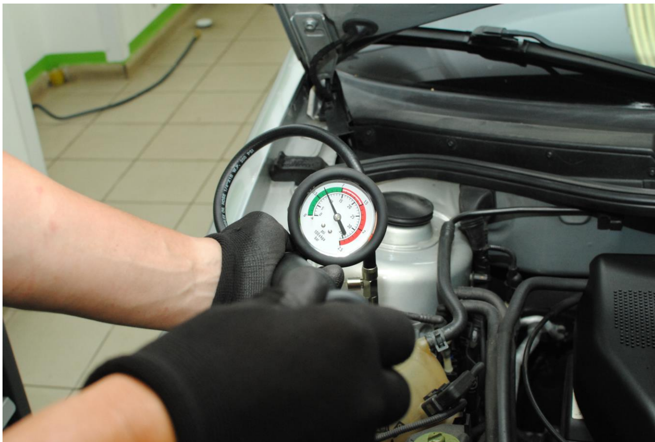
Obr. 9: Pumpou postupně zvyšujeme tlak v systému
