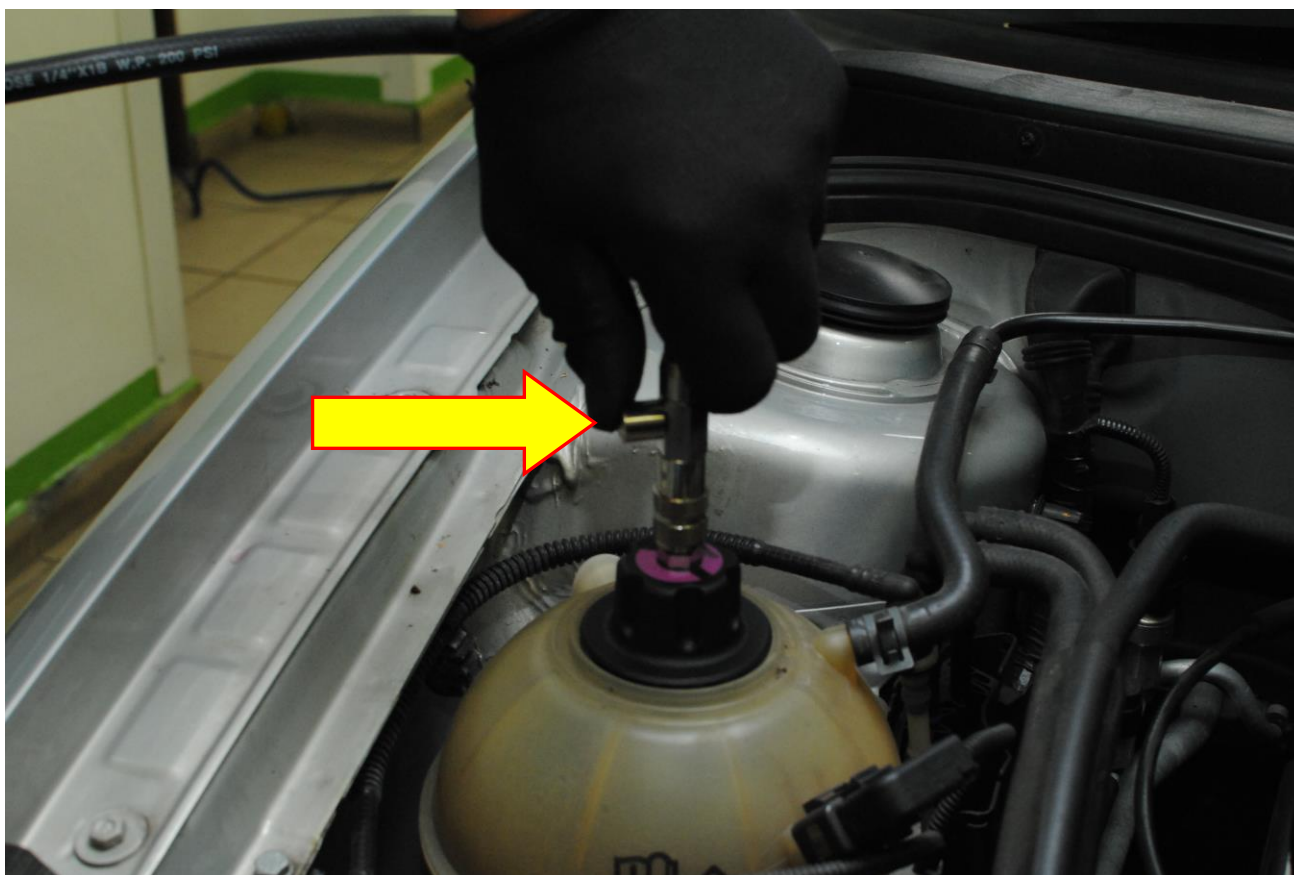
Obr. 12: Ventilem vypustíme tlak
