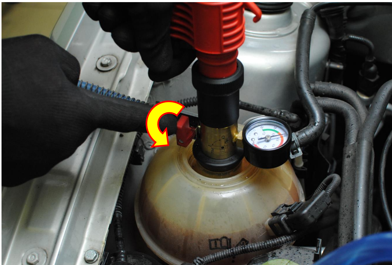
Obr. 40: Otevřeme ventil přívodu chladicí kapaliny
