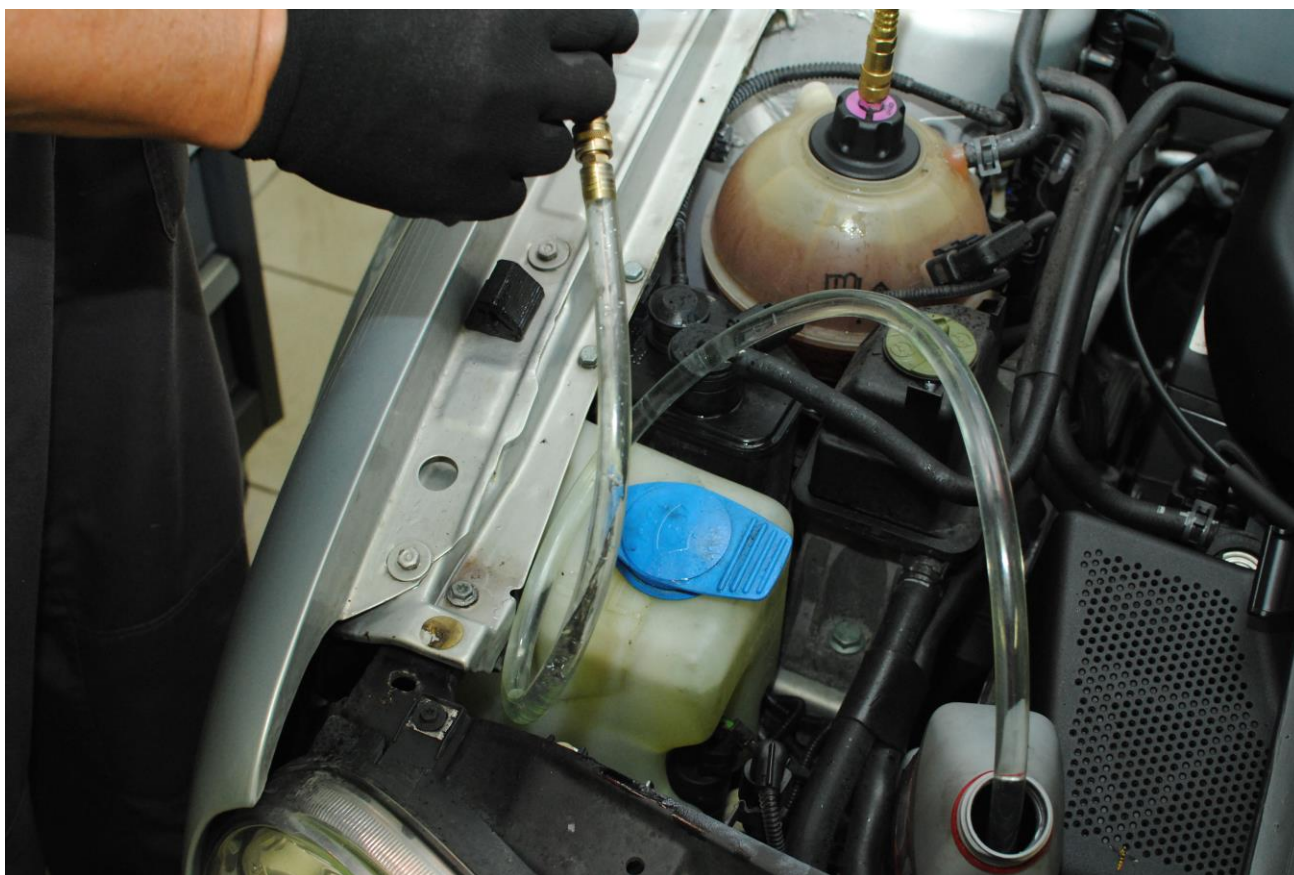
Obr. 29: Kapalina se začne nasávat do expanzní nádoby
