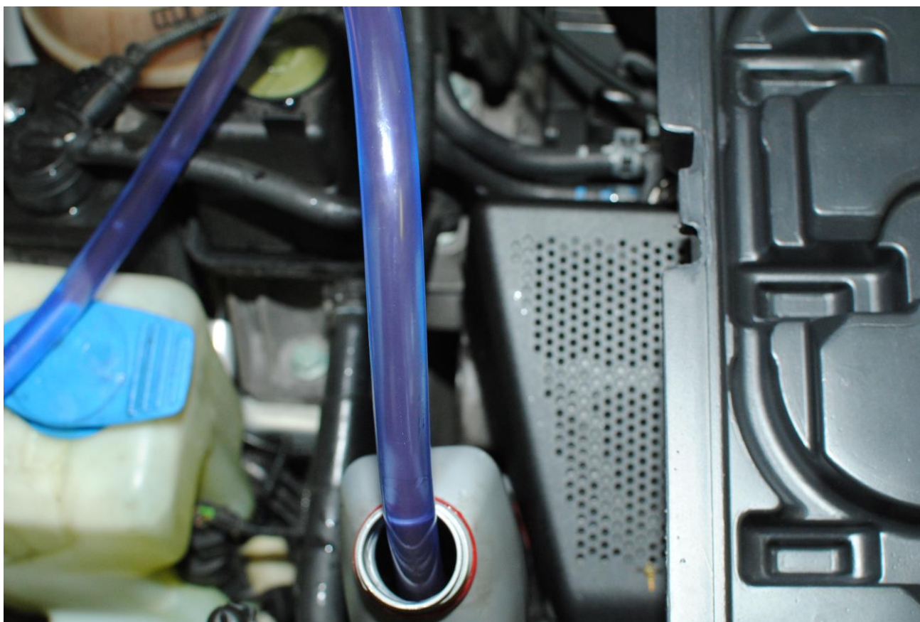
Obr. 41: Kapalina se nasává do expanzní nádoby a podtlak klesá
