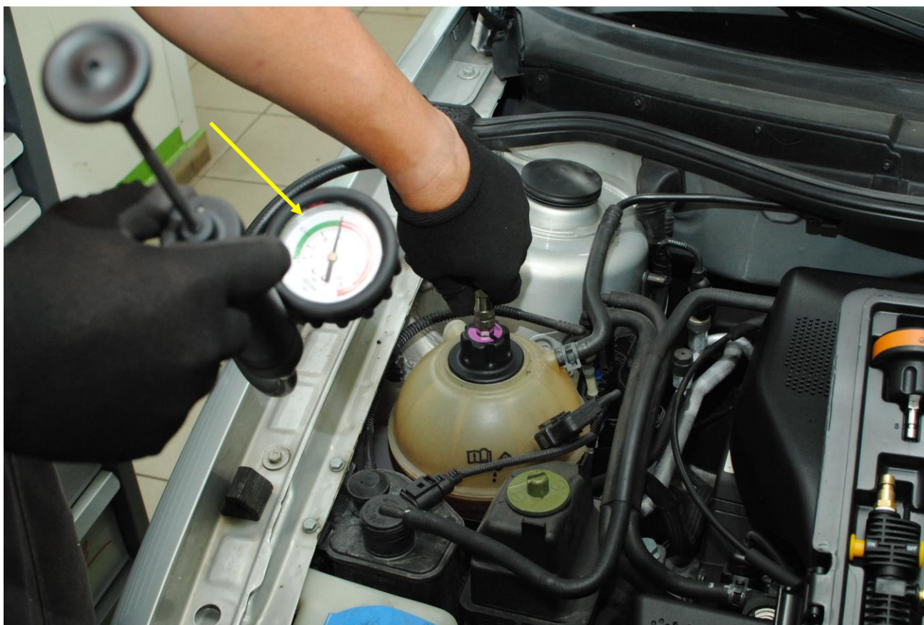
Obr. 11: Pokud tlak neklesá, je systém těsný
