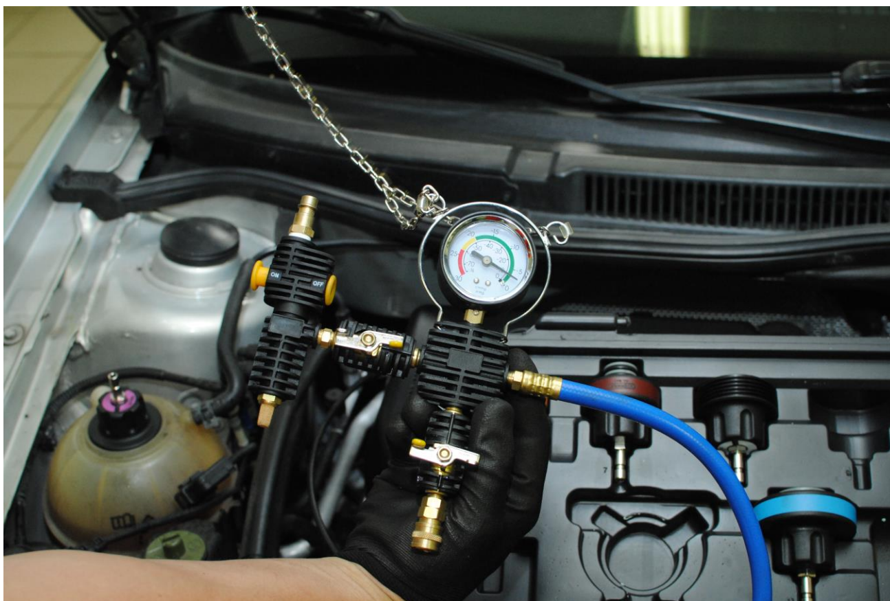
Obr. 15: Podtlakové zařízení na doplnění chladicí kapaliny s vakuometrem
