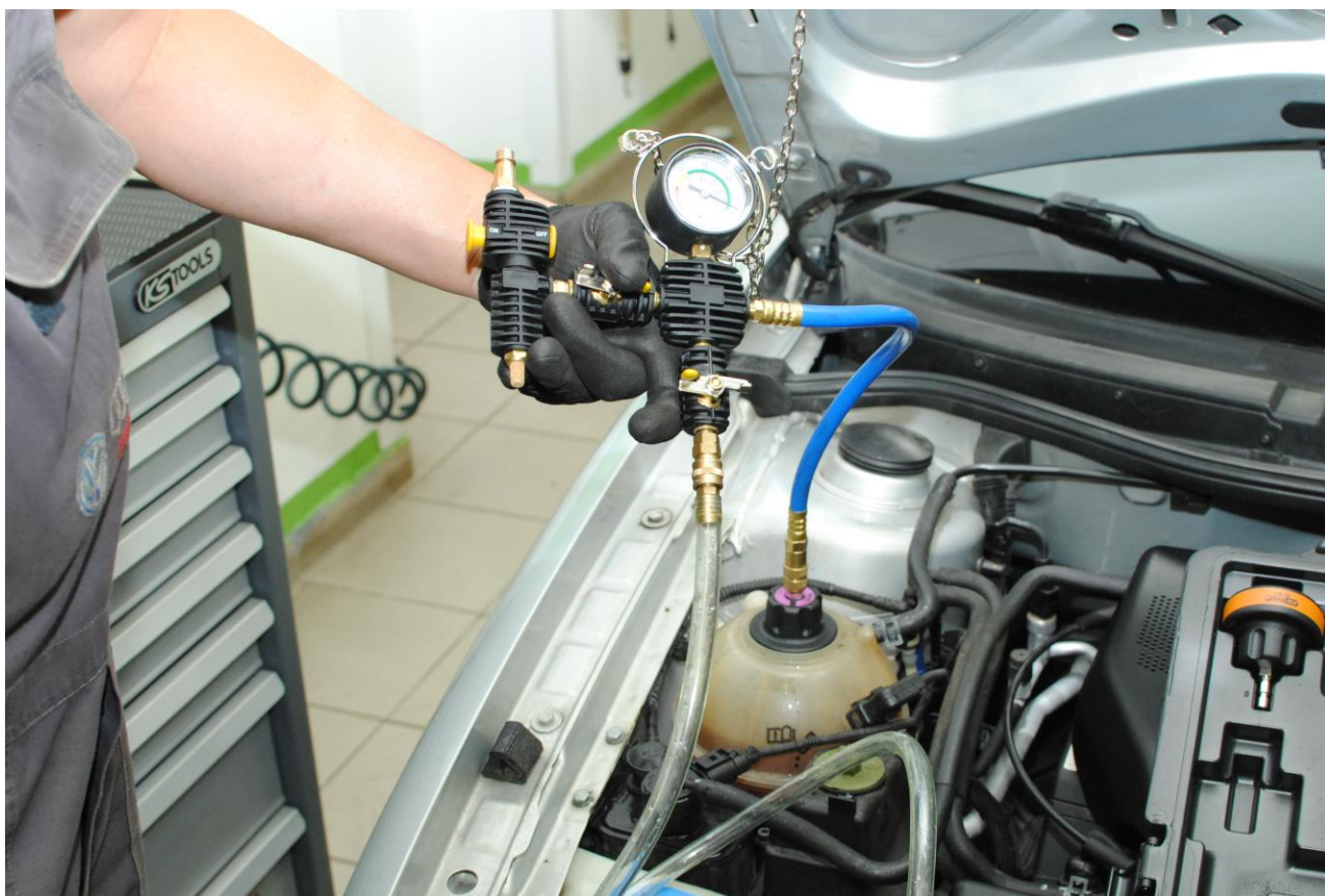
Obr. 22: Rychlospojka je zajištěna
