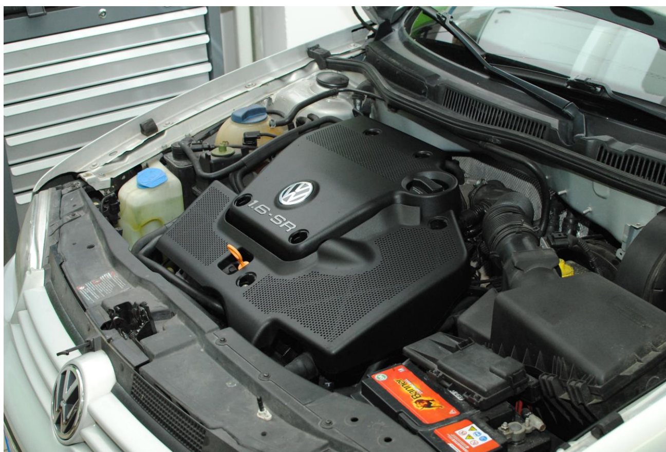
Obr. 1: Motor zahřejeme na provozní teplotu
