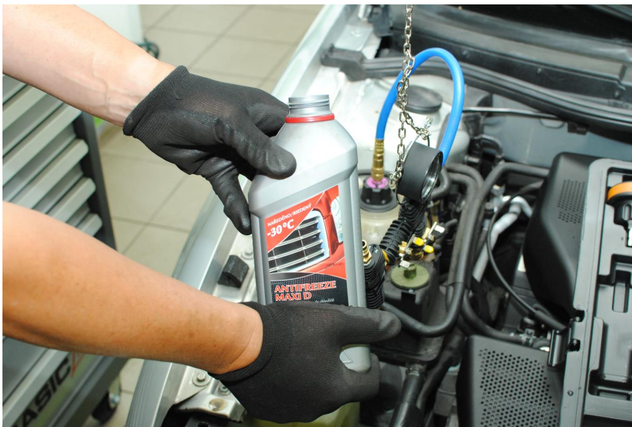
Obr. 18: Pro doplnění použijeme odpovídající chladicí kapalinu
