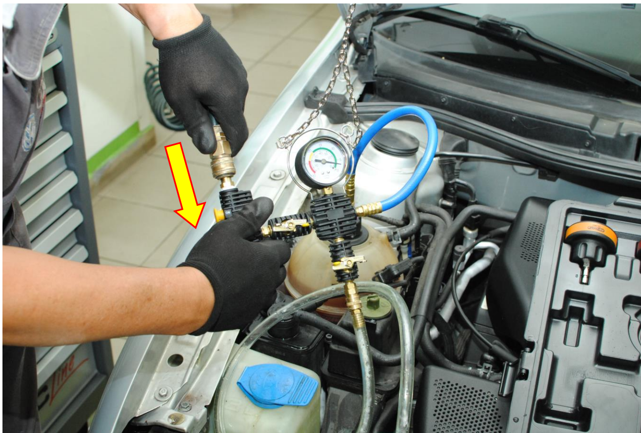
Obr. 23: Jako poslední připojíme hadici tlakového vzduchu
