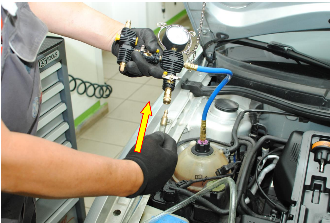
Obr. 21: Hadici připojíme na podtlakový přístroj
