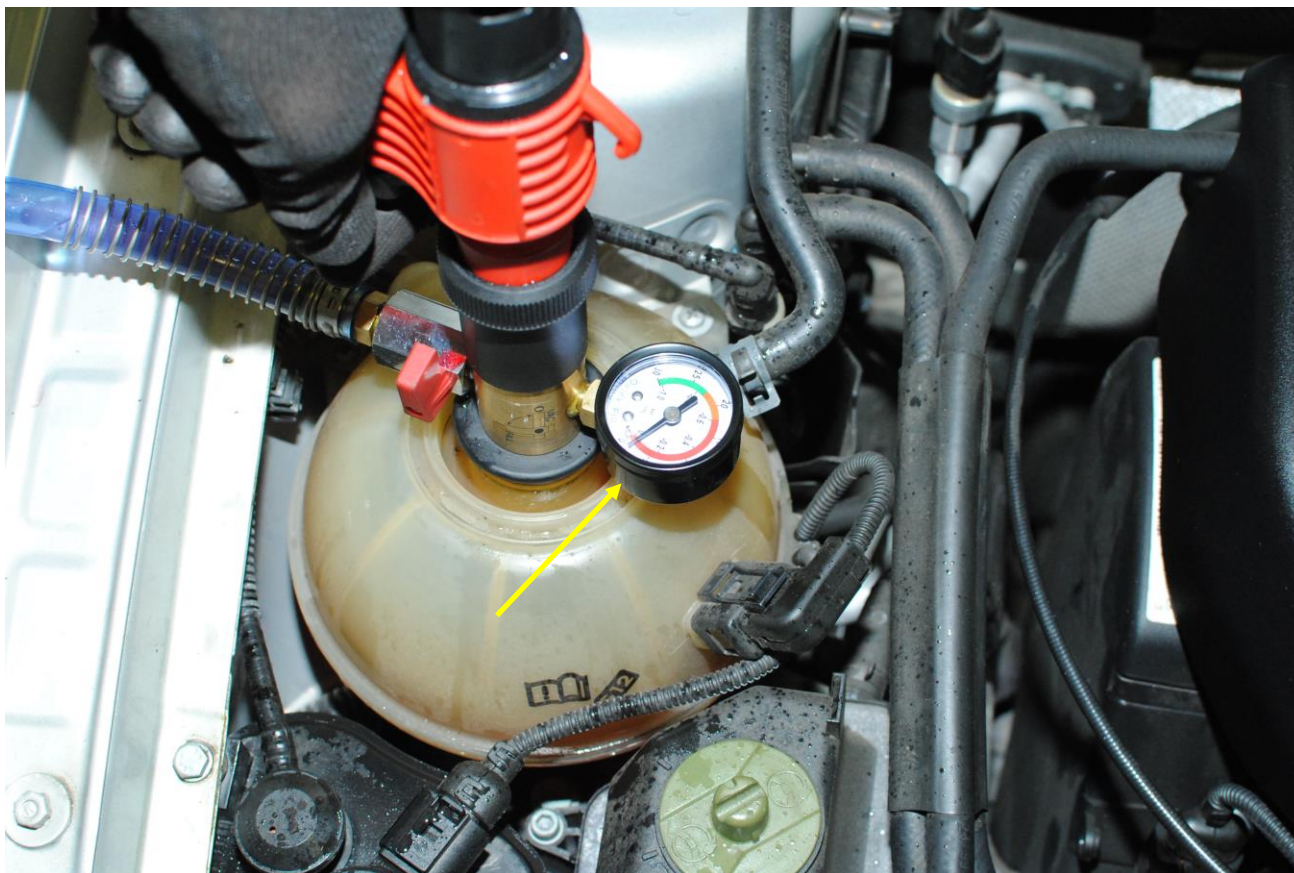
Obr. 43: Podtlak je na nule
