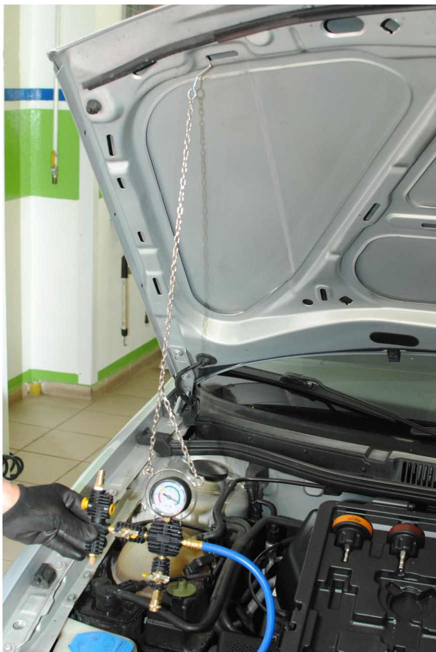
Obr. 16: Přístroj zavěsíme na řetízek
