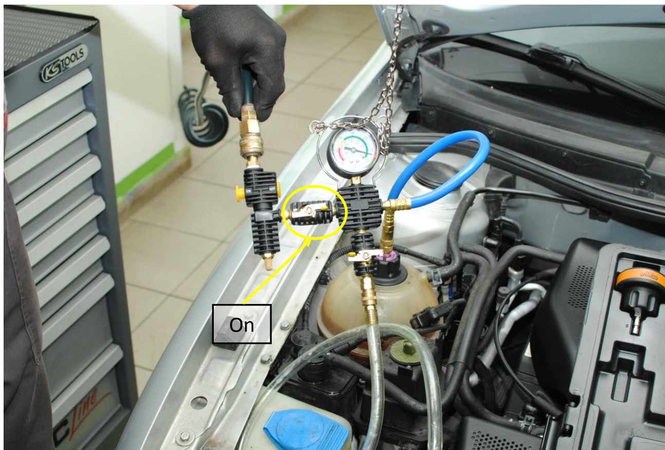
Obr. 24: Příklad přístroje připravený k plnění
