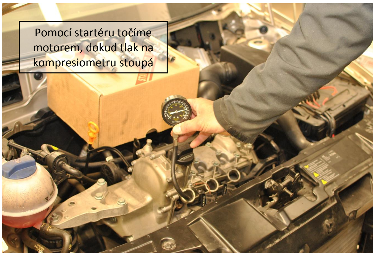
Obr. 8: Měření komprese 1. válce
