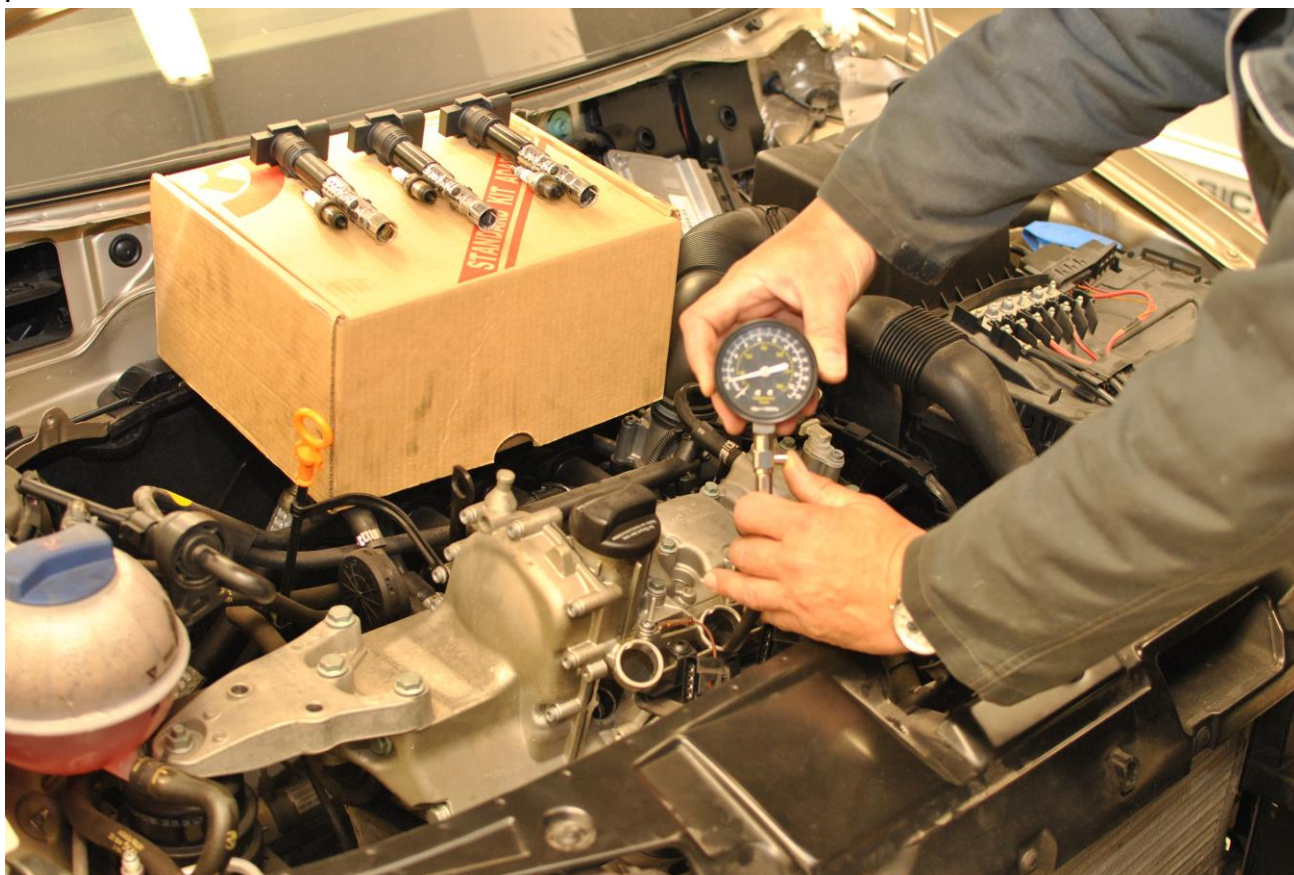
Obr. 11: Vypuštění tlaku po měření
