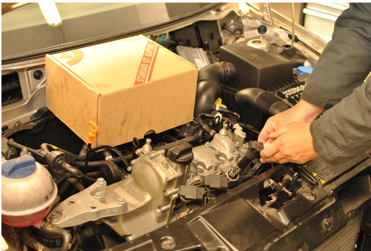
Obr. 4: Demontáž zapalovacích svíček
