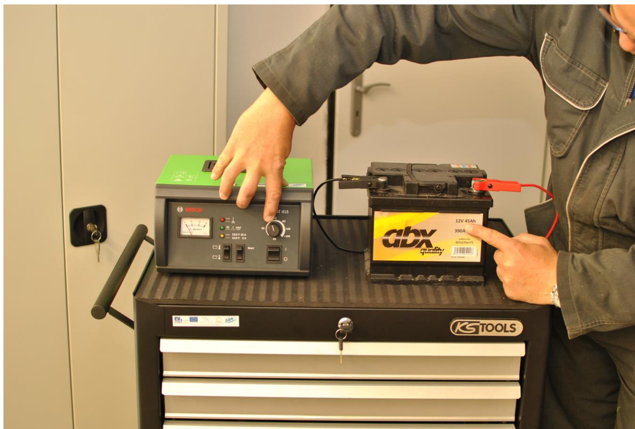
Obr. 19: Nastavíme kapacitu baterie (v našem případě 45Ah)
