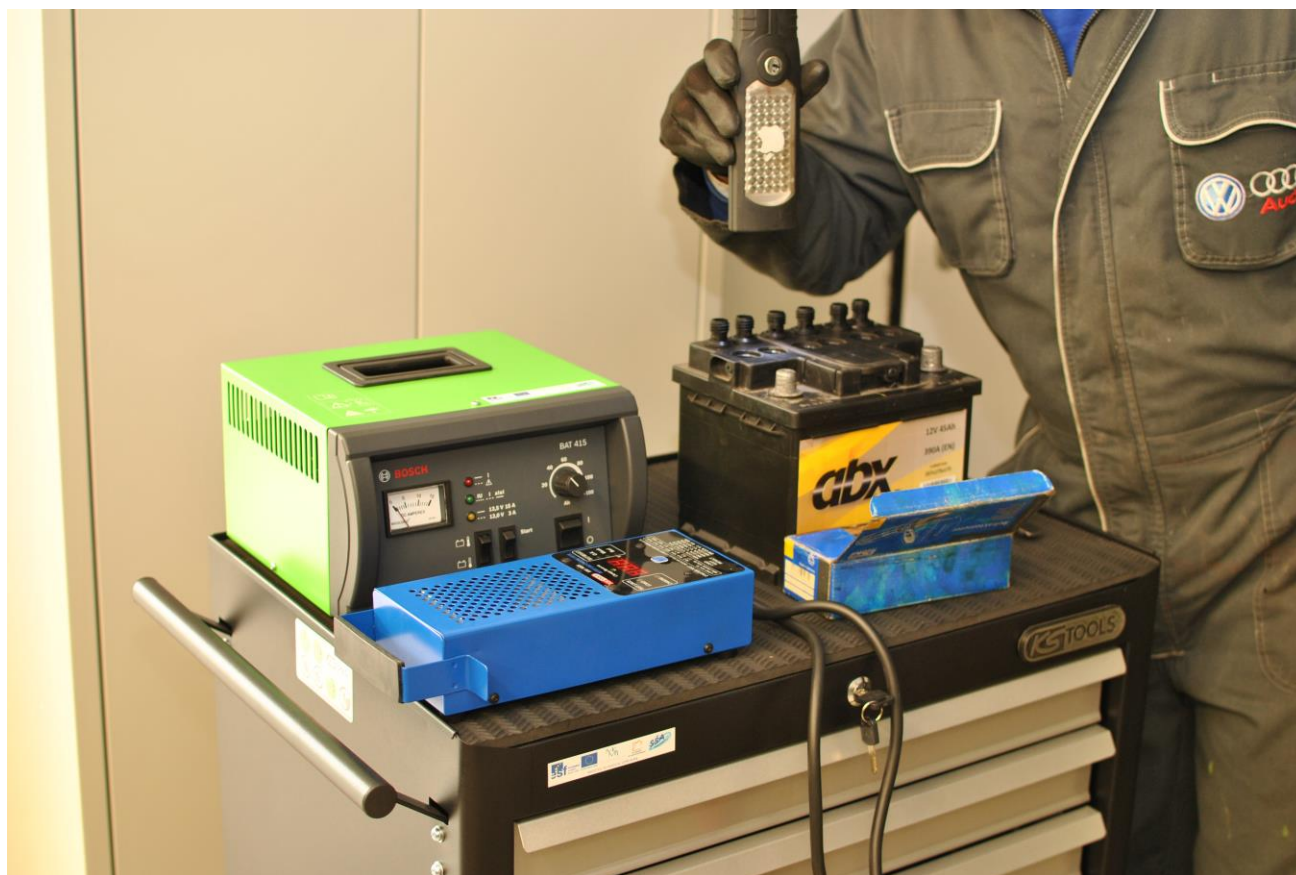
Obr. 4: Zkontrolujeme hladinu elektrolytu
