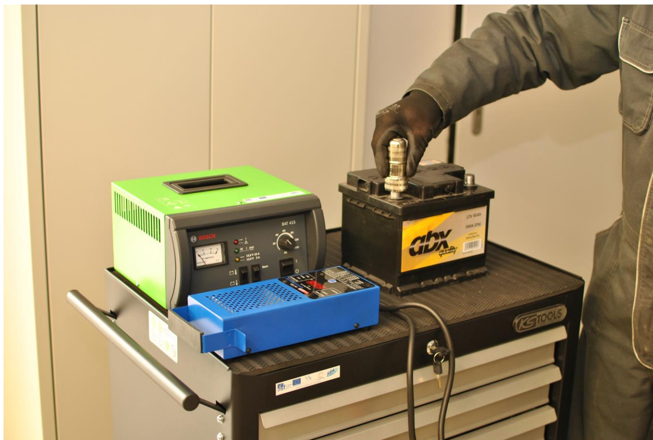
Obr. 10: Začistíme kontakty baterie
