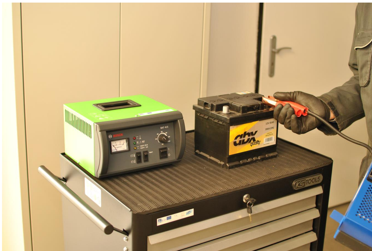
Obr. 12: Připojíme kladnou svorku zátěžového voltmetru
