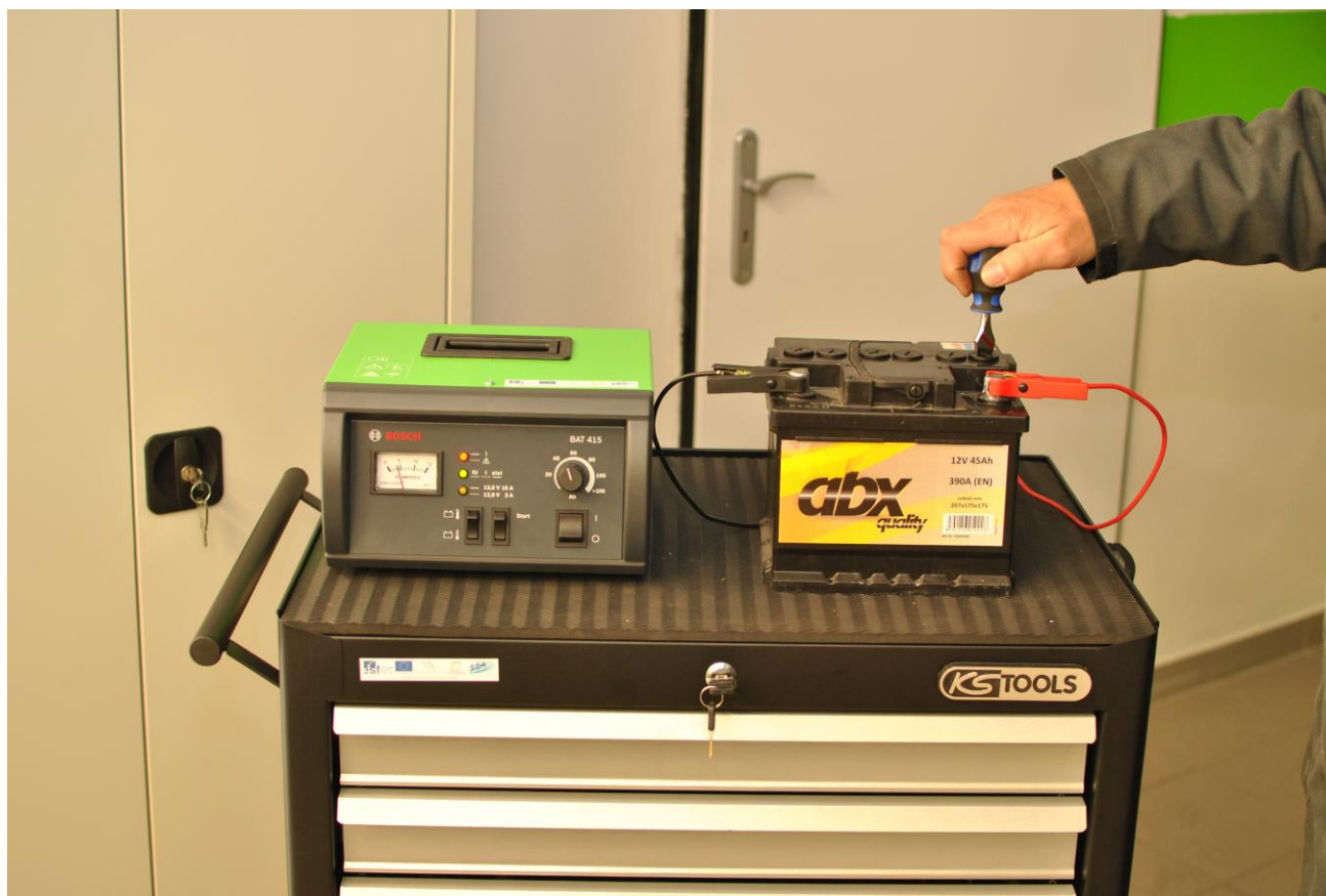
Obr. 22: Během nabíjení musí být zátky otevřené a jen položené na otvorech
