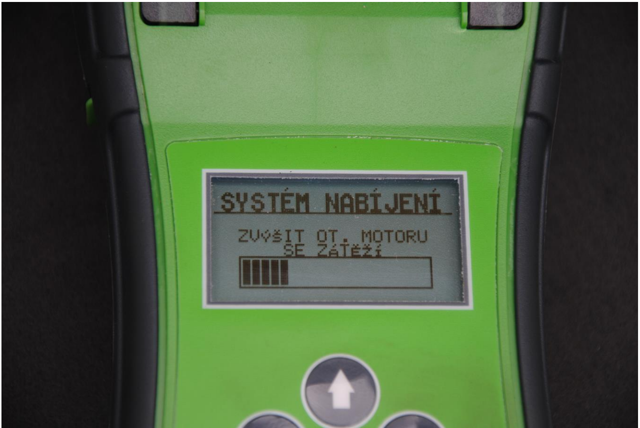
Obr. 44: Zvýšíme otáčky motoru
