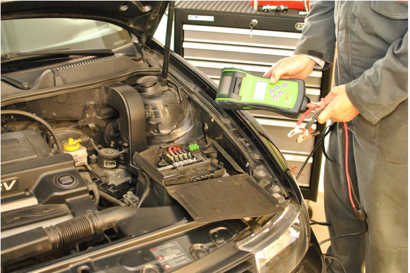
Obr. 15: Diagnostický přístroj BAT 131
