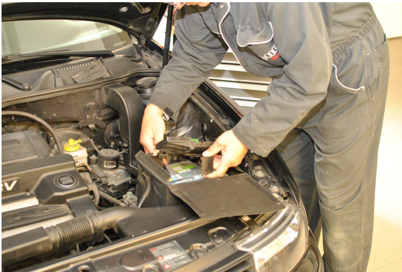
Obr. 13: Provedeme zpětnou montáž tepelného krytu a pouzdra pojistek
