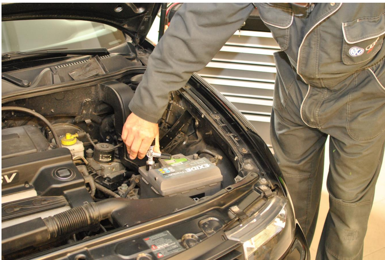
Obr. 8: Opravíme tvar kladné svorky baterie
