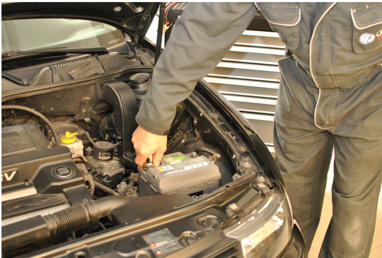
Obr. 11: Opravené svorky začistíme kartáčem
