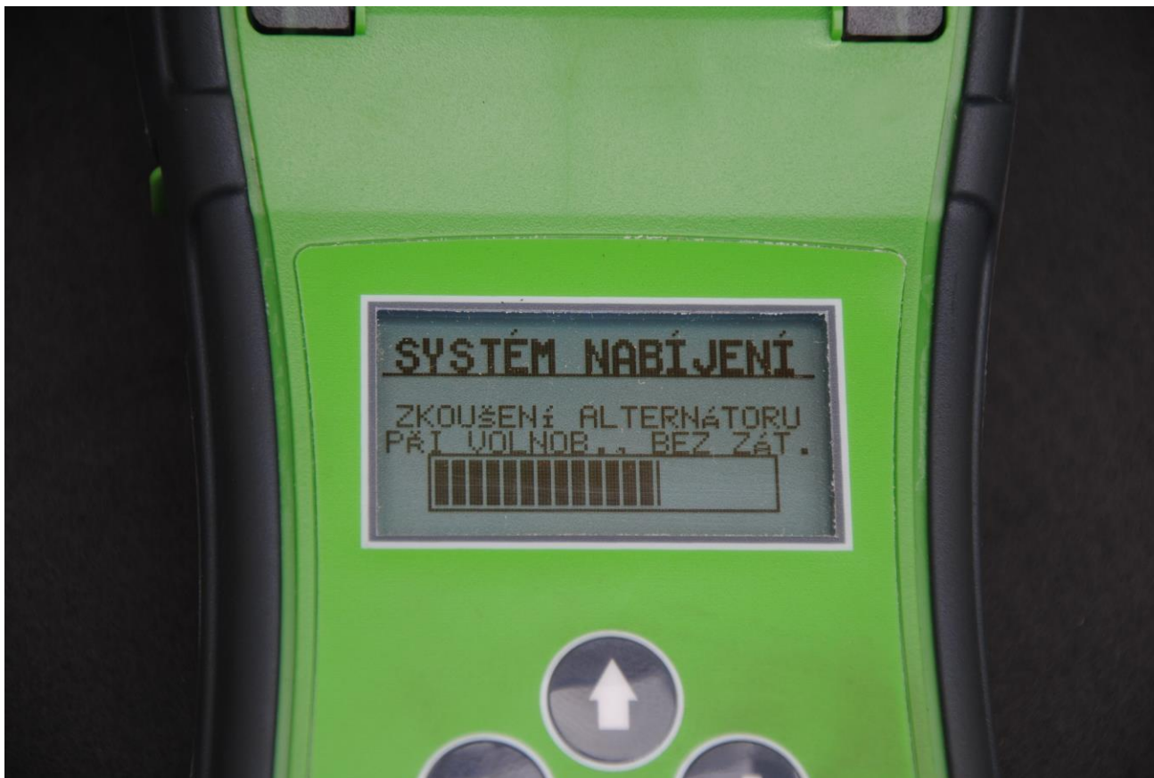
Obr. 41: Test alternátoru na volnoběh bez zátěže
