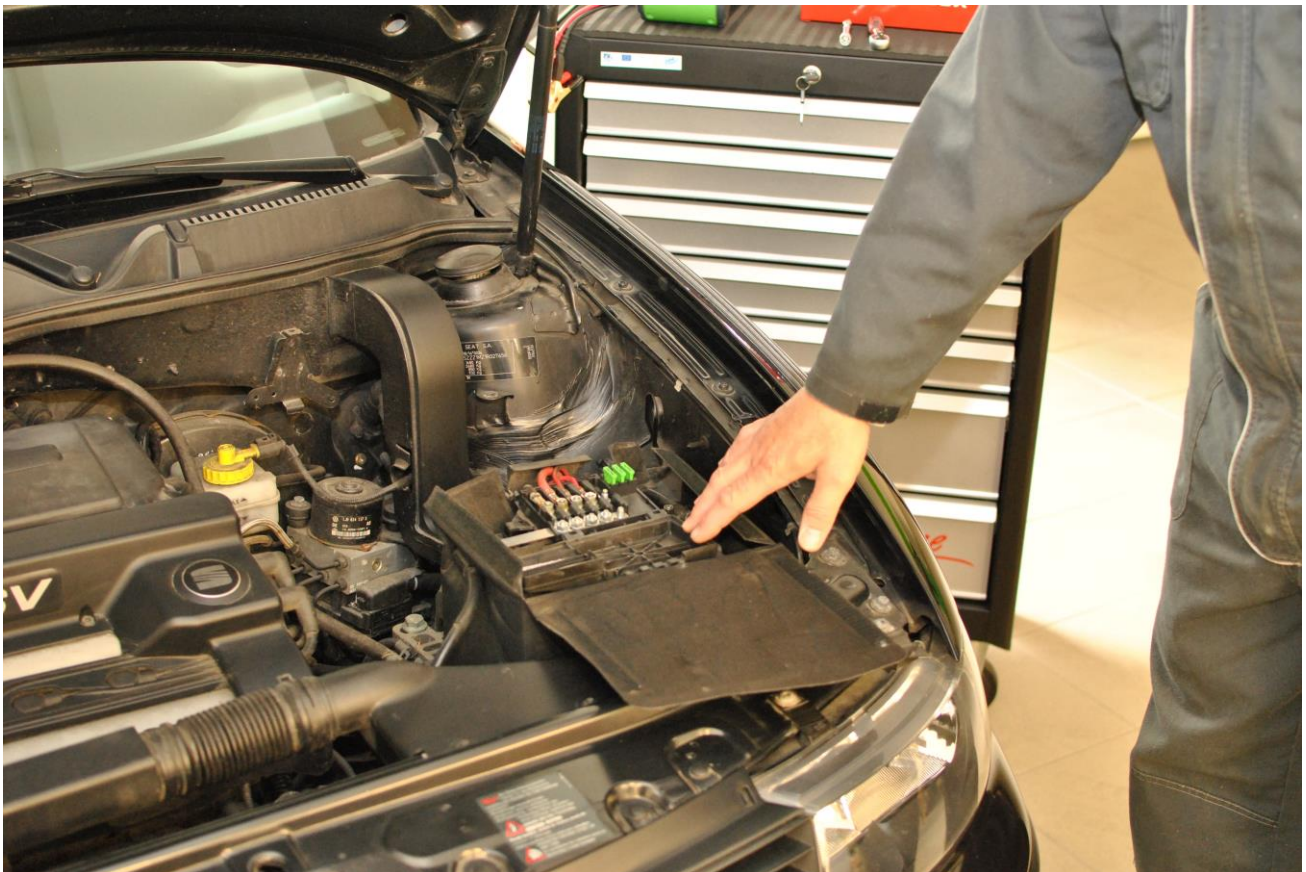
Obr. 1: Odkryjeme baterii a její pojistkové pouzdro
