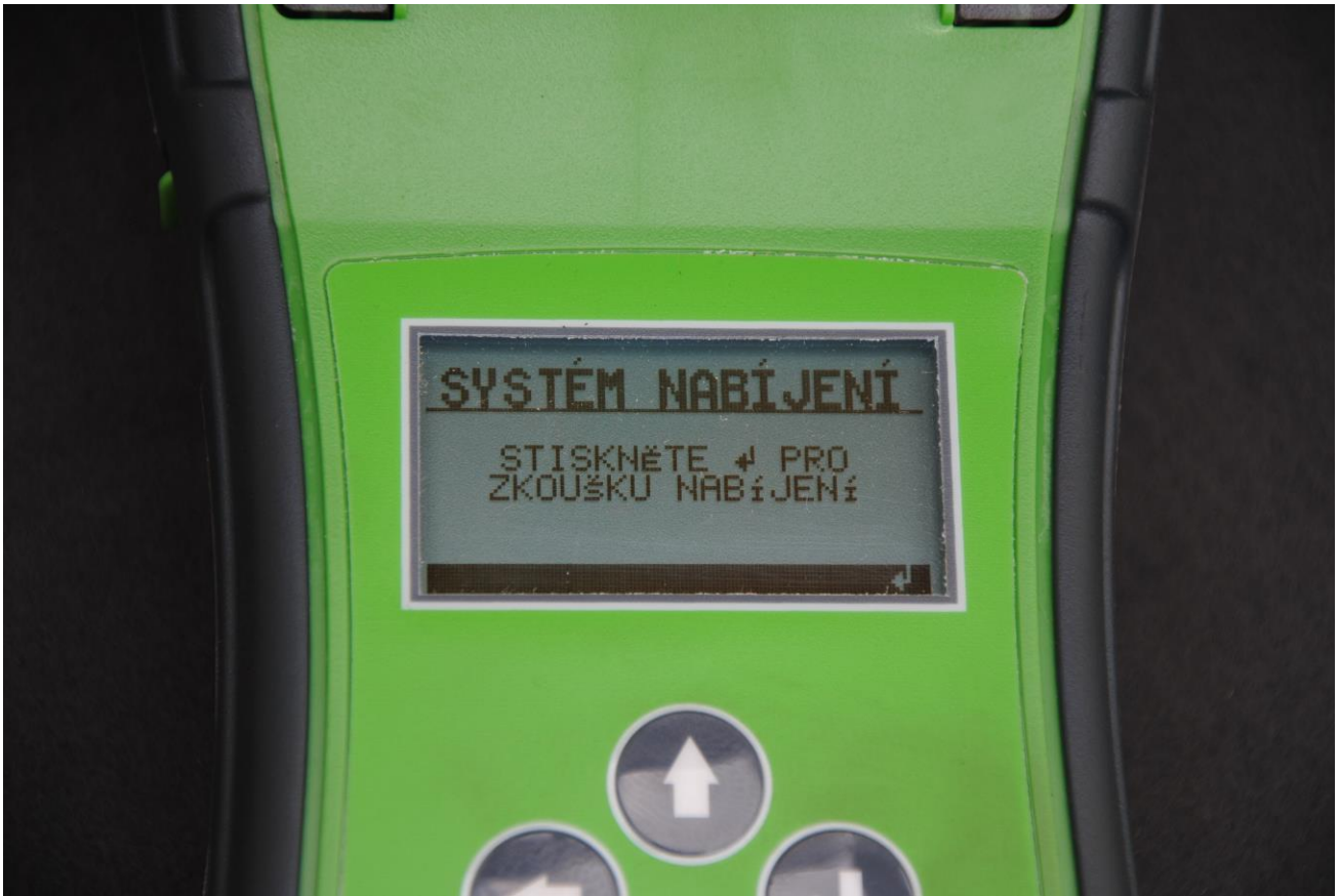
Obr. 37: Spuštění testu dobíjení baterie
