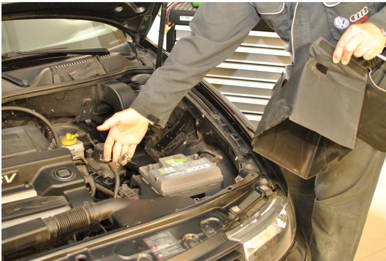
Obr. 7: Sejmeme kladnou svorku a tepelný kryt baterie
