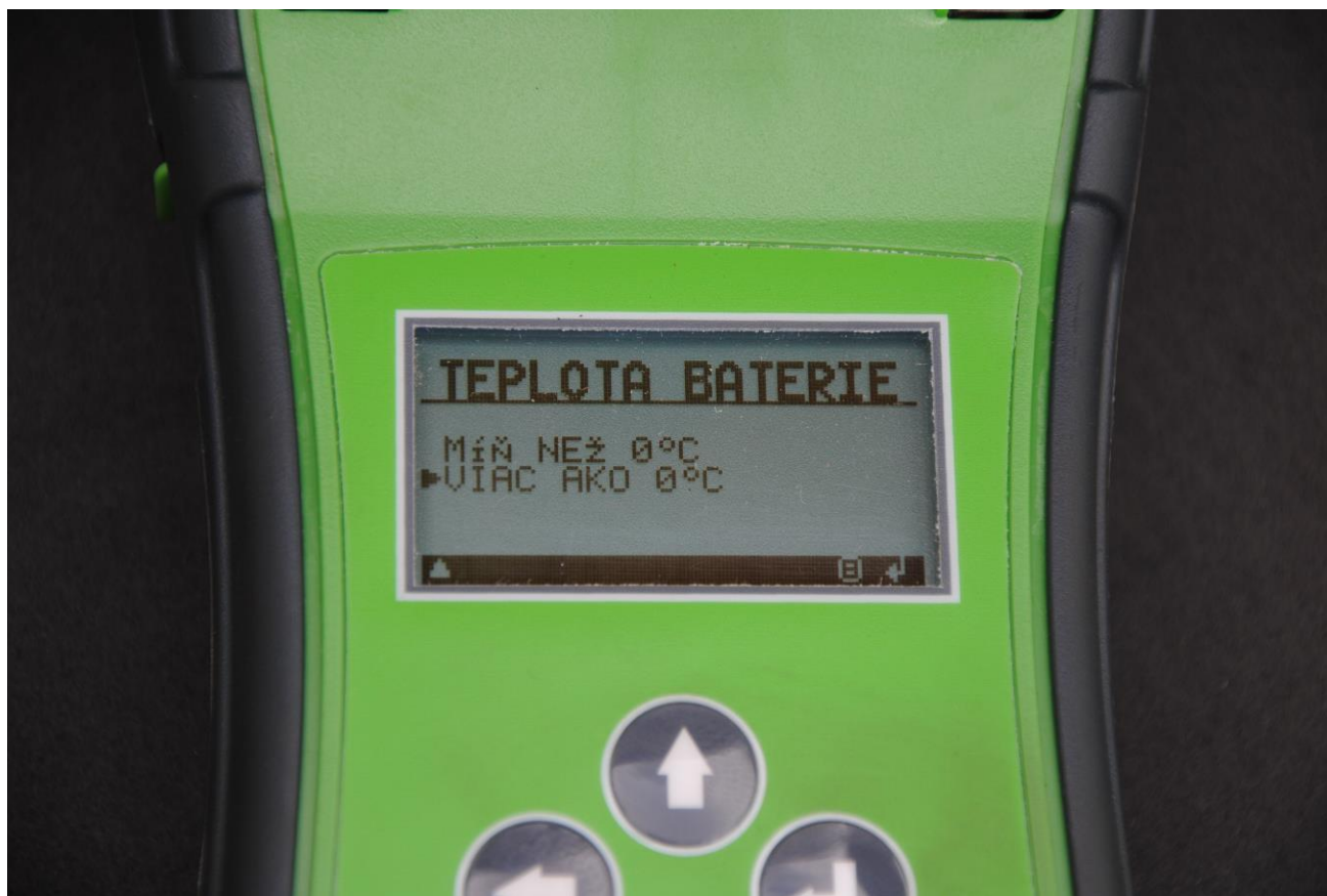
Obr. 27: Zadáme teplotu baterie
