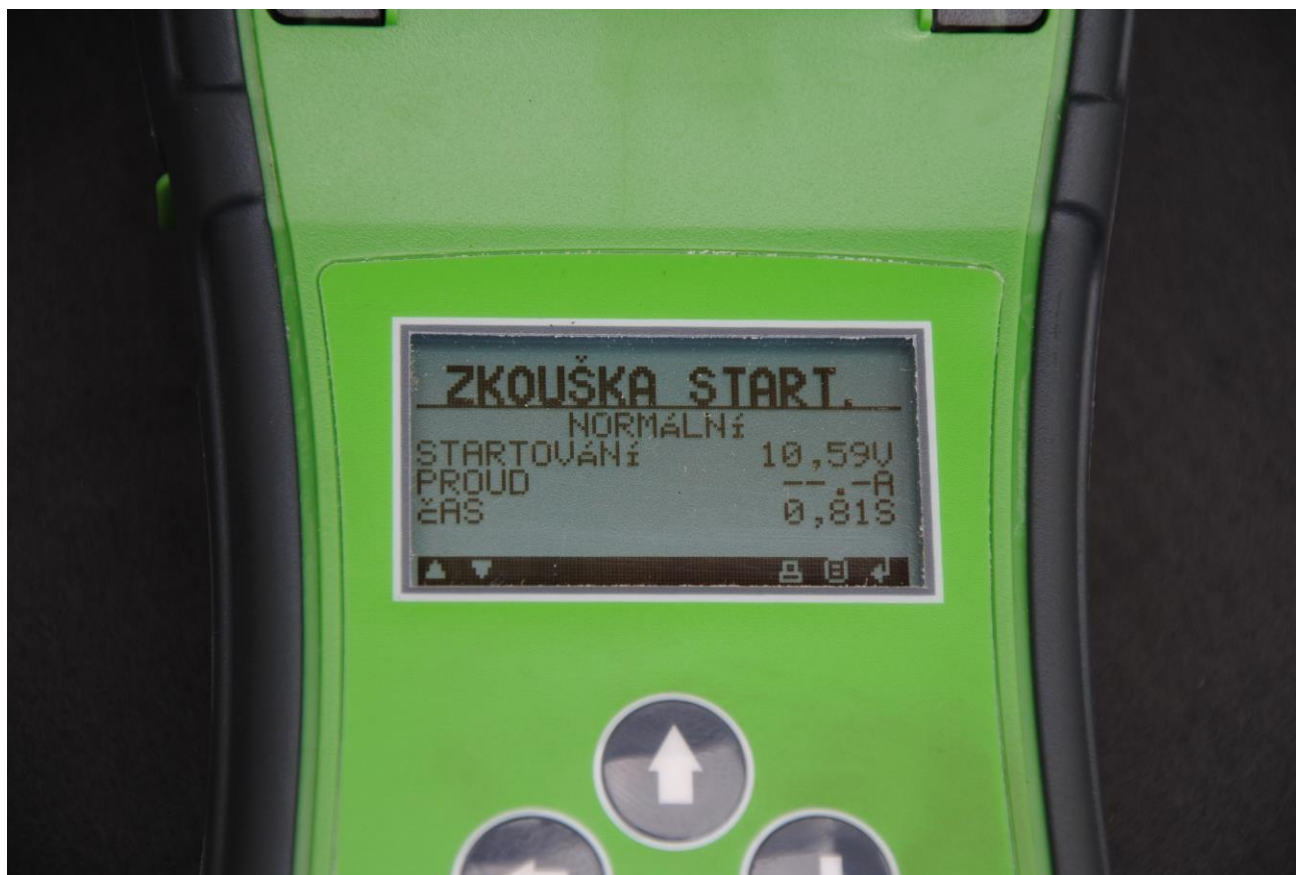
Obr. 36: Výsledek testu při startu
