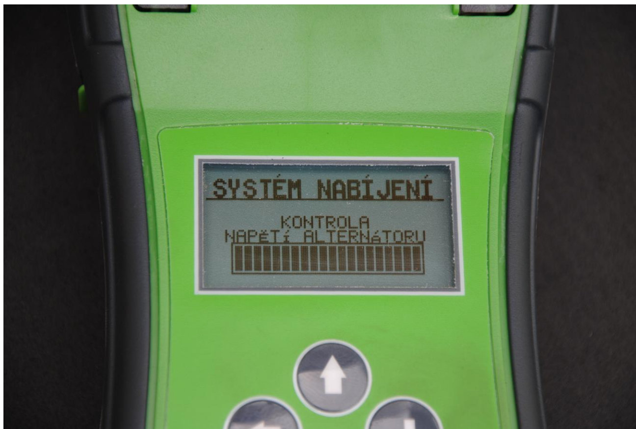
Obr. 38: Systémová kontrola napětí v alternátoru
