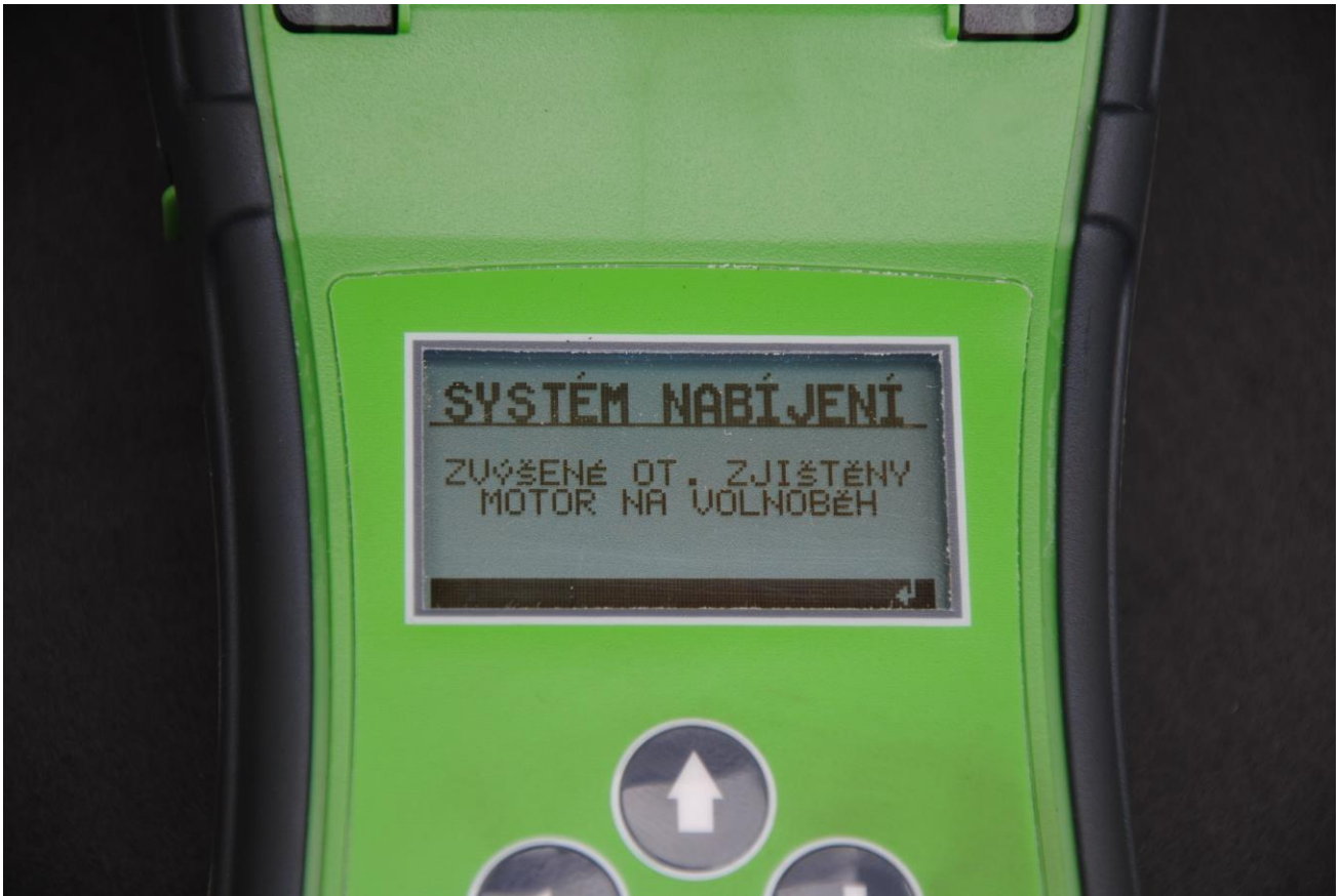
Obr. 40: Spustíme otáčky motoru na volnoběh
