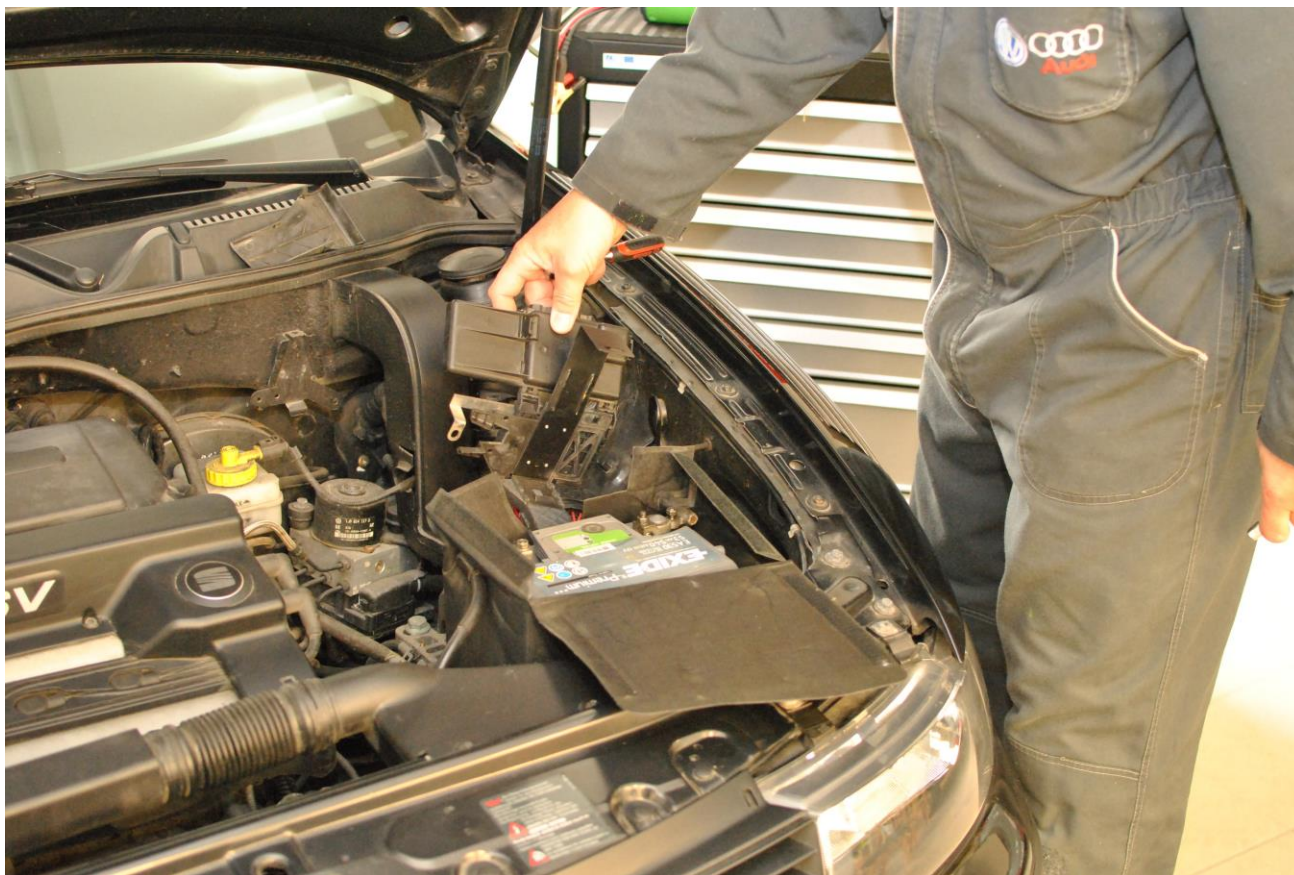
Obr. 4: Demontujeme pojistkové pouzdro
