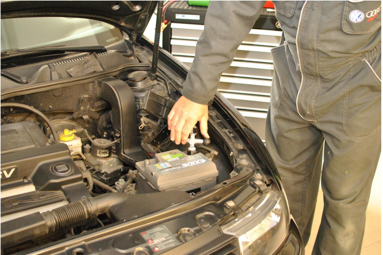
Obr. 10: Opravíme tvar záporné svorky baterie
