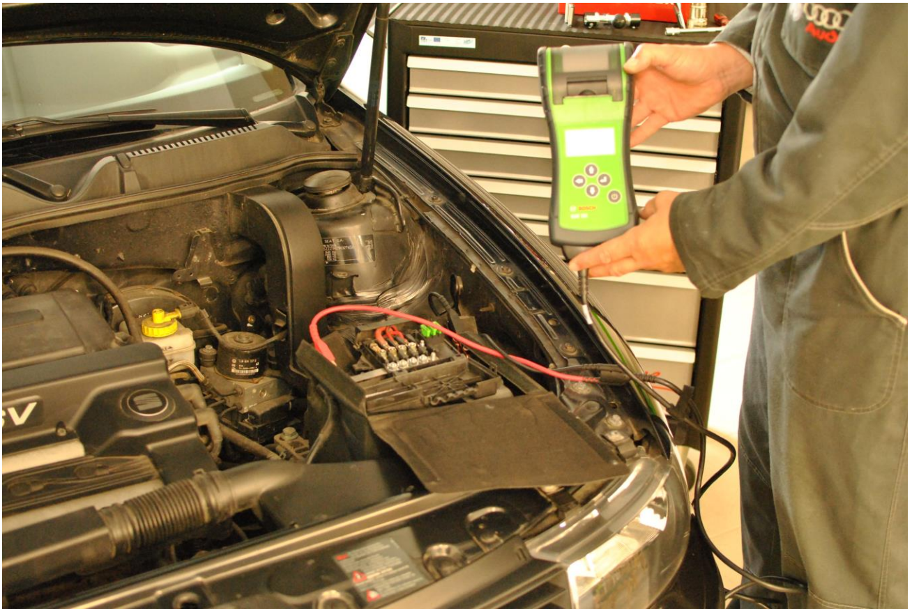
Obr. 16: Připojíme testovací přístroj červenou svorkou na plus
