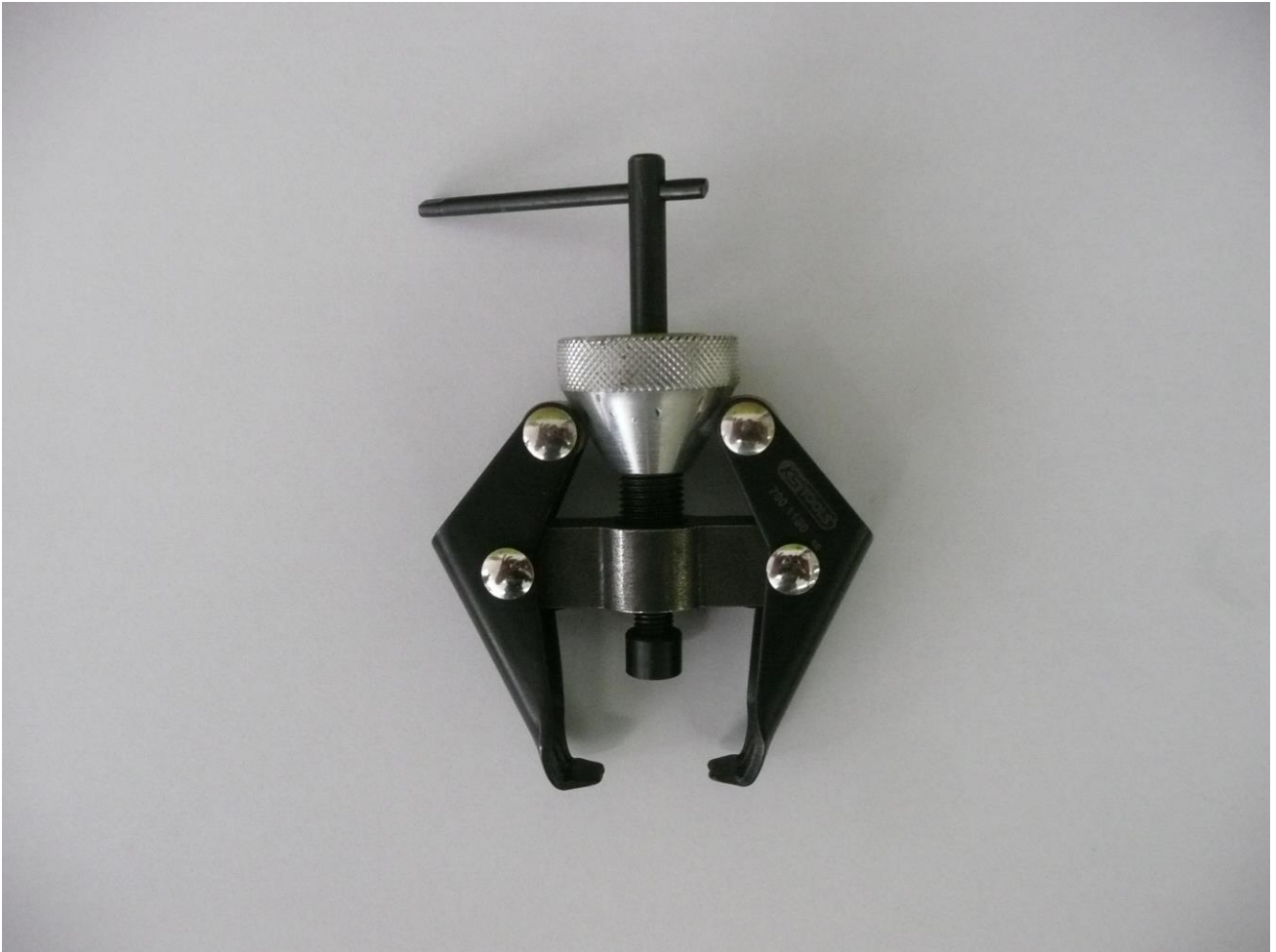
Obr. 6: Stahovák na připojovací svorky (pokud nejde sundat rukou)
