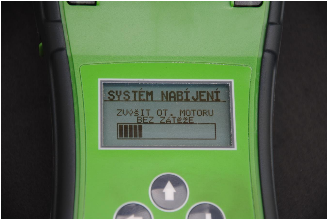
Obr. 39: Zvýšíme otáčky motoru
