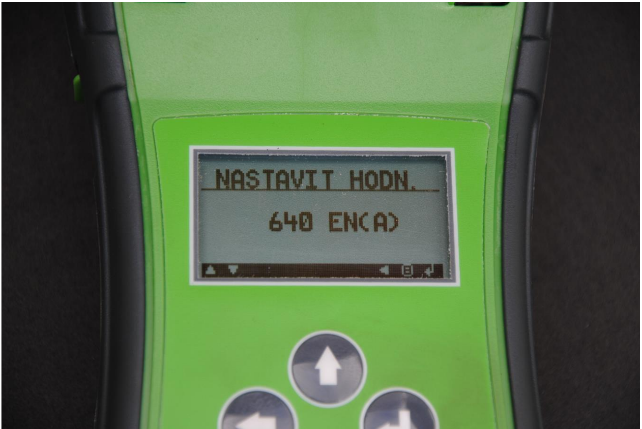
Obr. 25: Podle štítku baterie nastavíme zkratový proud
