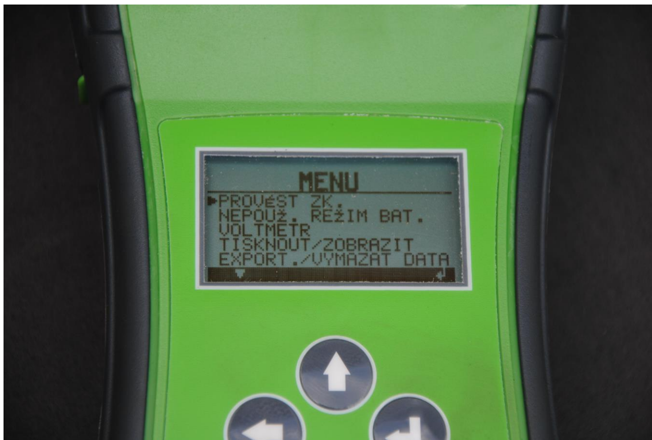
Obr. 19: Potvrdíme volbu „PROVÉST ZK“
