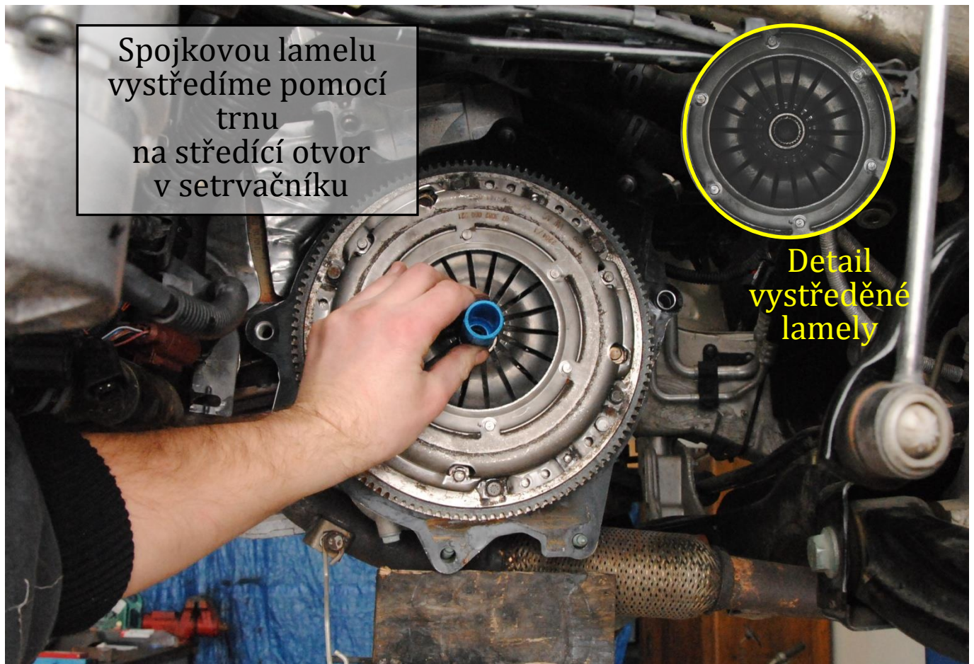
Obr. 12: Vystředění lamely spojky
