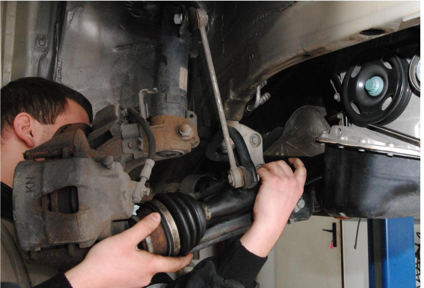
Obr. 16: Zpětná montáž poloos
