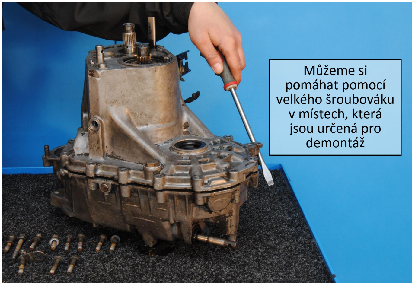
Obr. 15: Demontáž převodové skříně
