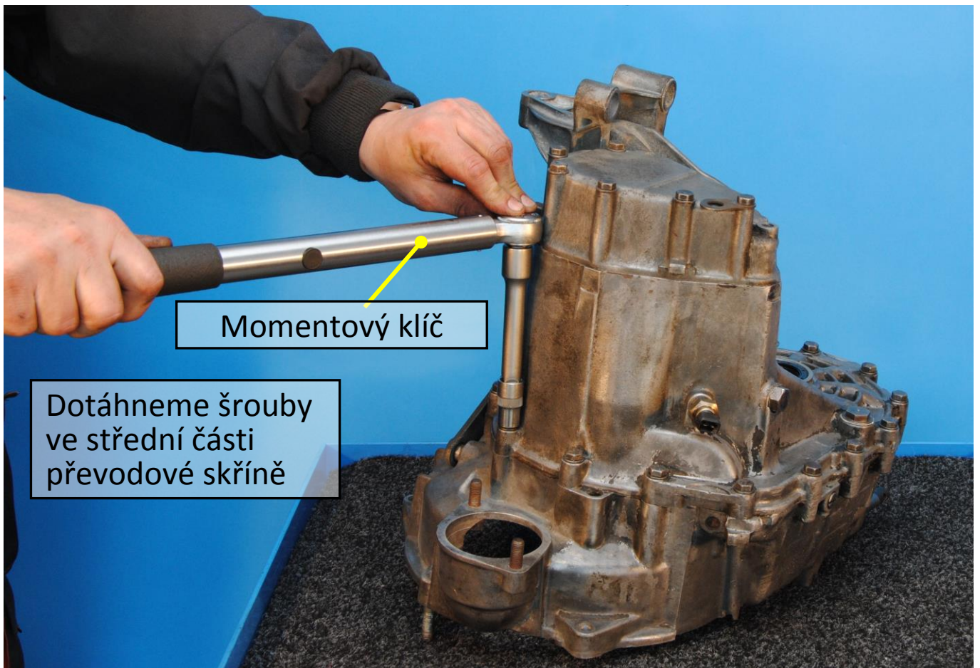
Obr. 51: Montáž převodové skříně
