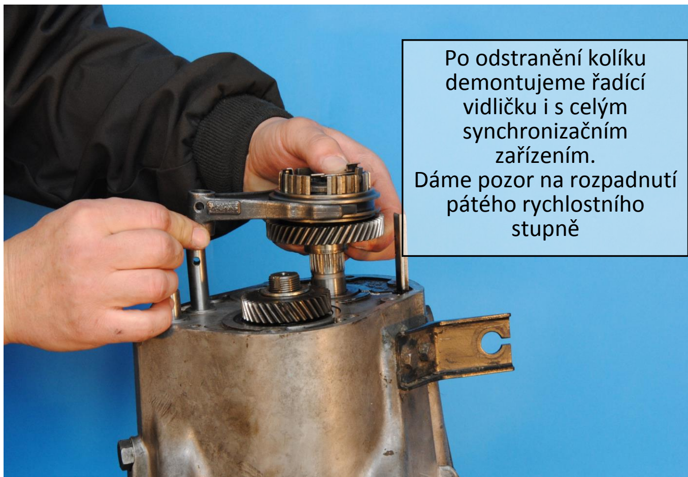
Obr. 9: Demontáž řadící vidličky a synchronizačního zařízení
