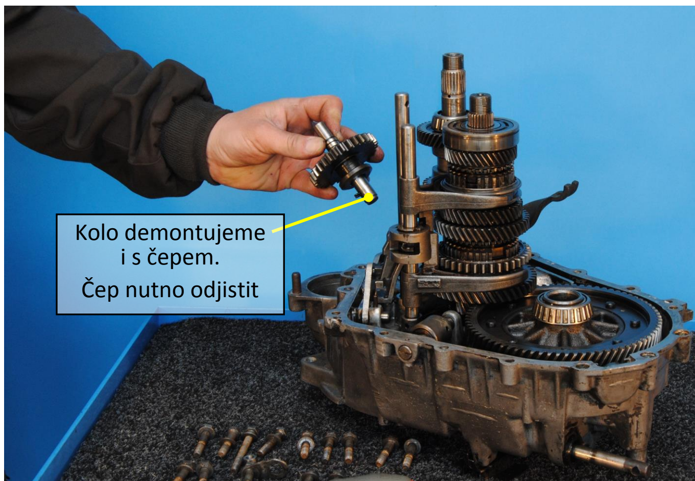
Obr. 17: Demontáž kola zpětného chodu
