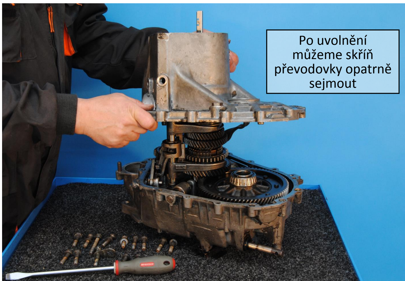
Obr. 16: Demontáž převodové skříně
