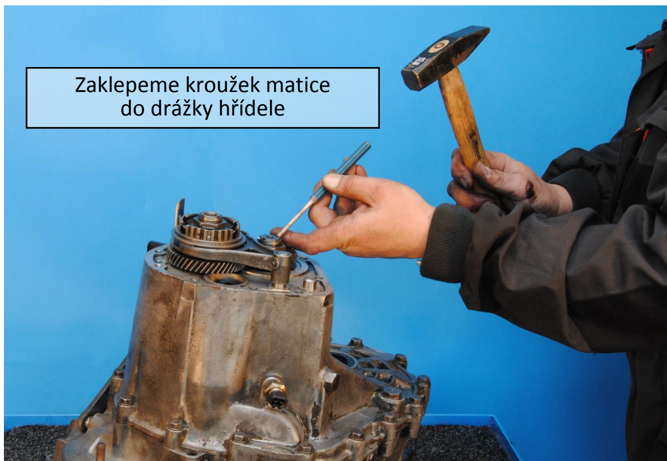
Obr. 48: Zajištění matic
