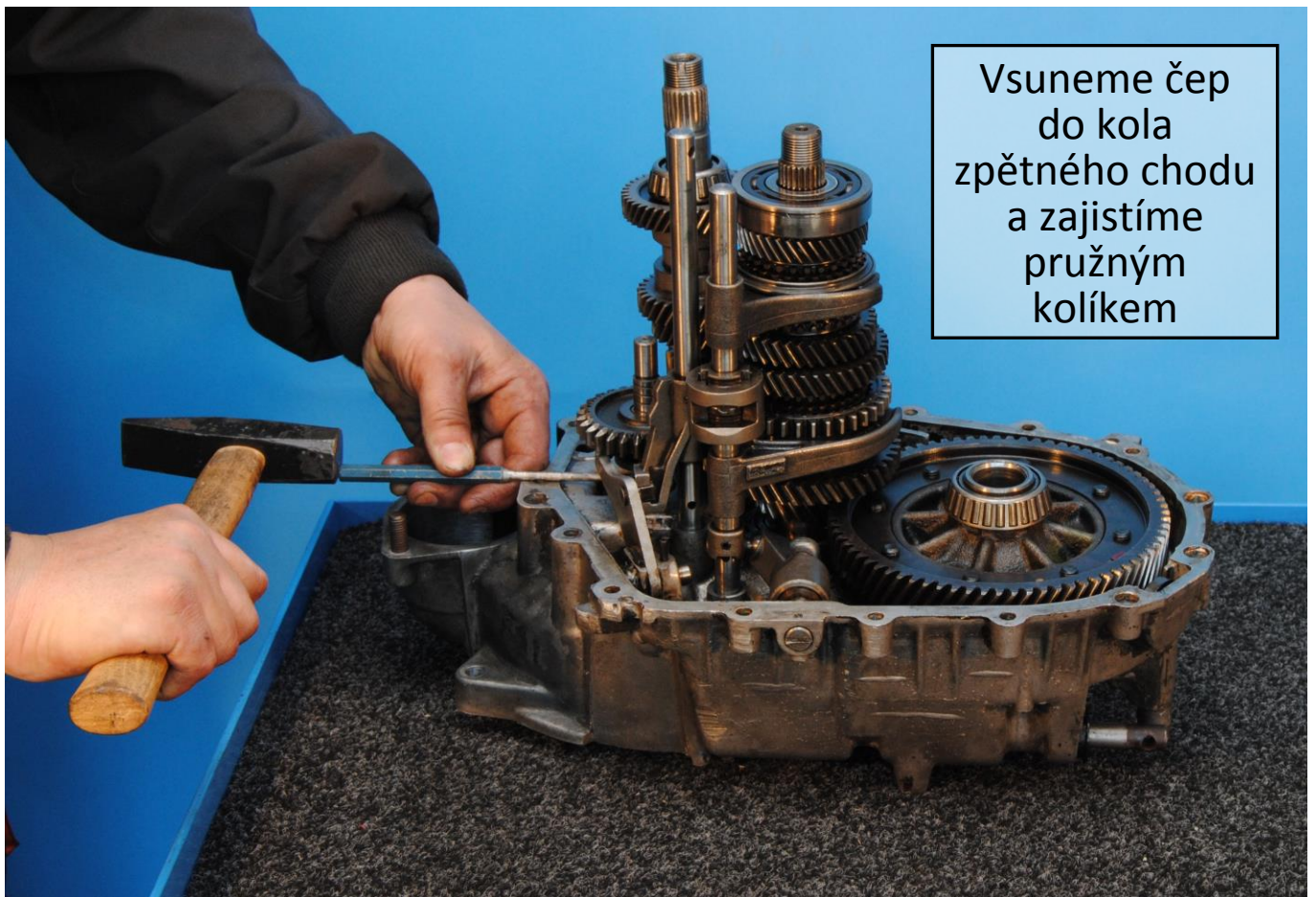
Obr. 31: Montáž čepu kola zpětného chodu
