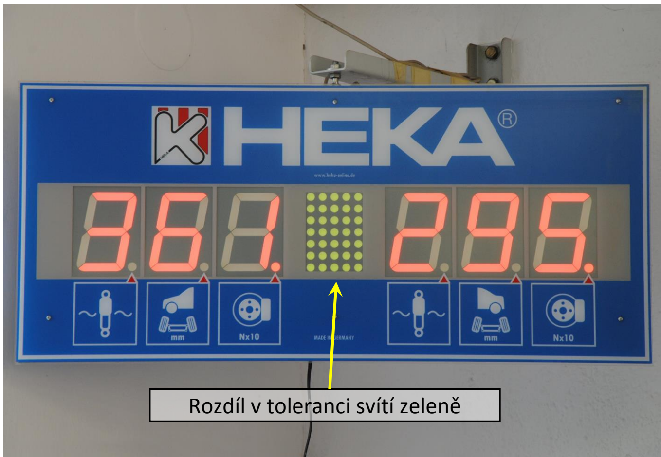
Obr. 26: Měření brzd přední nápravy
