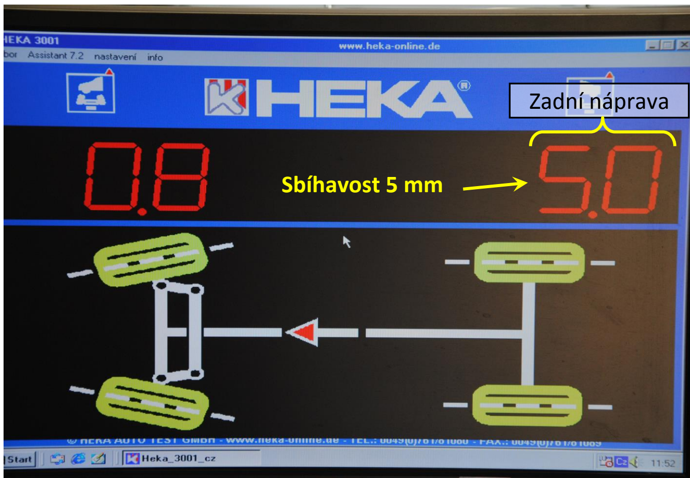
Obr. 20: Měření sbíhavosti zadní nápravy
