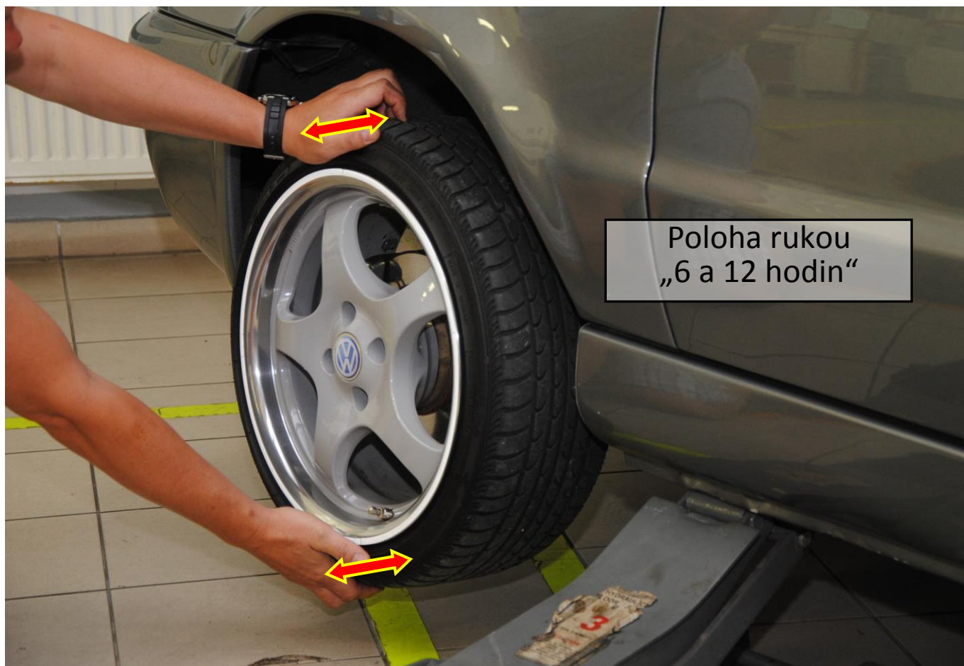
Obr. 3: Diagnostika vůle v čepu ramene a v ložisku
