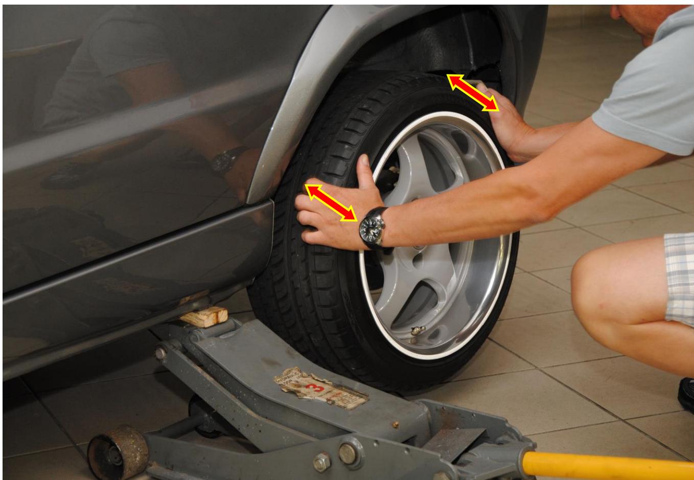
Obr. 6: Kontrola vůle v ložisku, popřípadě v uložení nápravy
