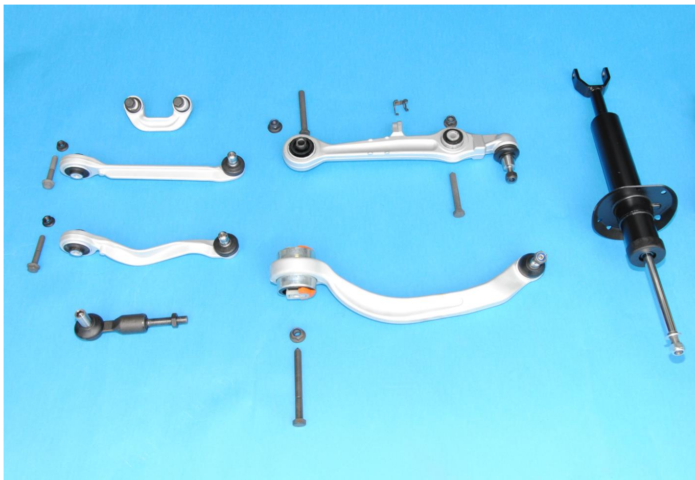
Obr. 18: Komponenty pro levou stranu přední nápravy
