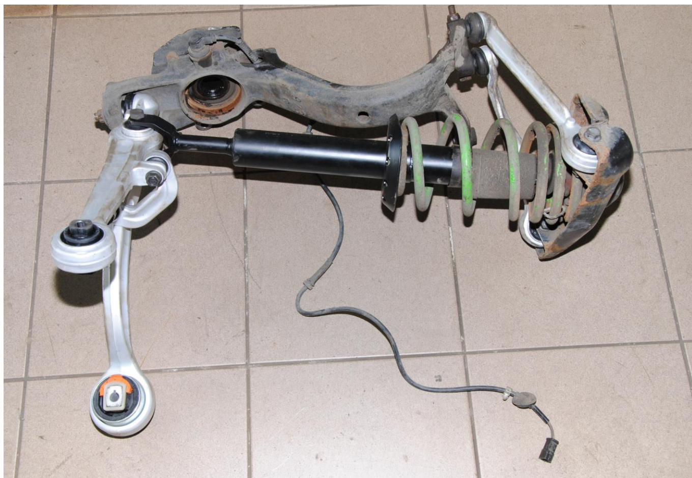
Obr. 19: Opravená pravá strana přední nápravy
