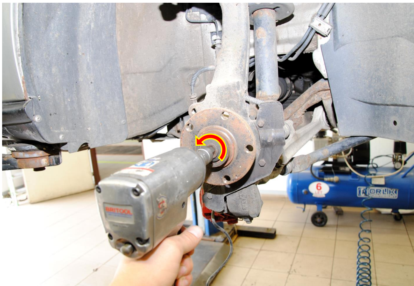
Obr. 5: Povolení centrálního šroubu poloosy
