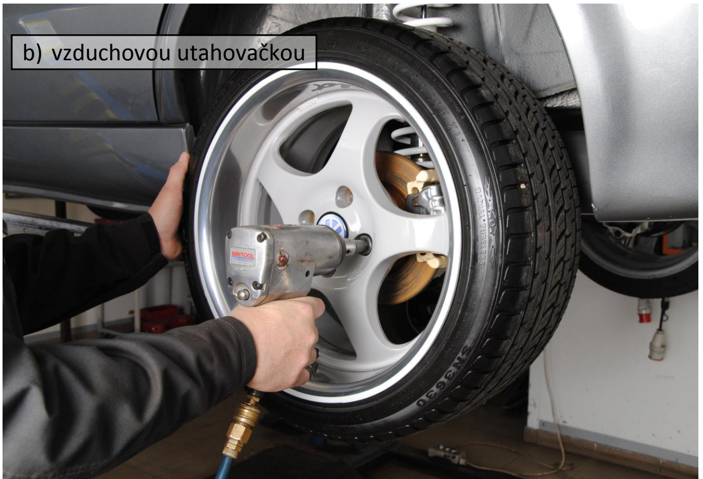
Obr. 4: Demontáž kola pomocí vzduchové utahovačky
