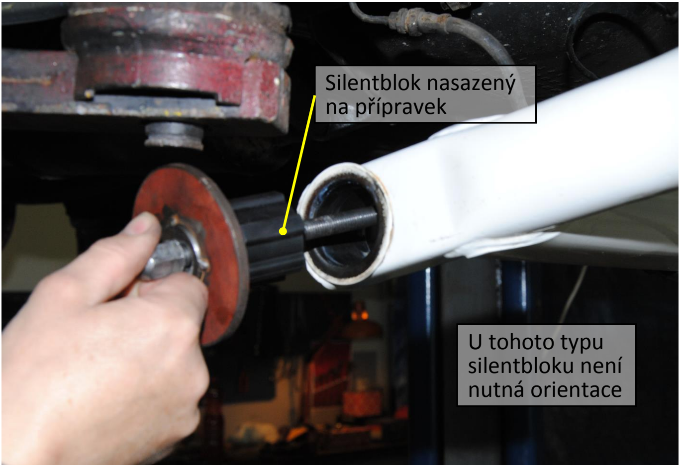
Obr. 15: Montáž nového silentbloku
