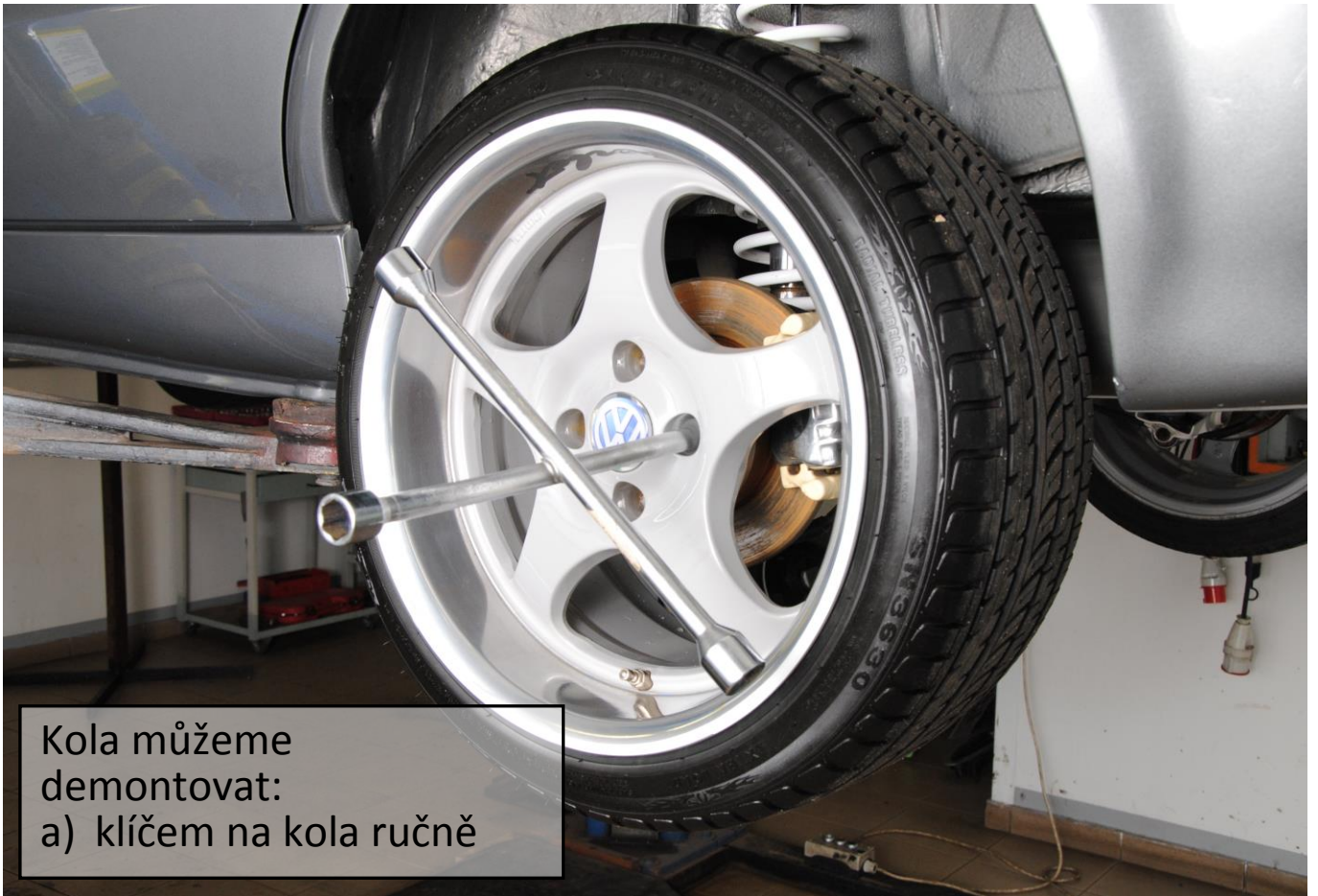
Obr. 3: Ruční demontáž kola pomocí klíče na kola
