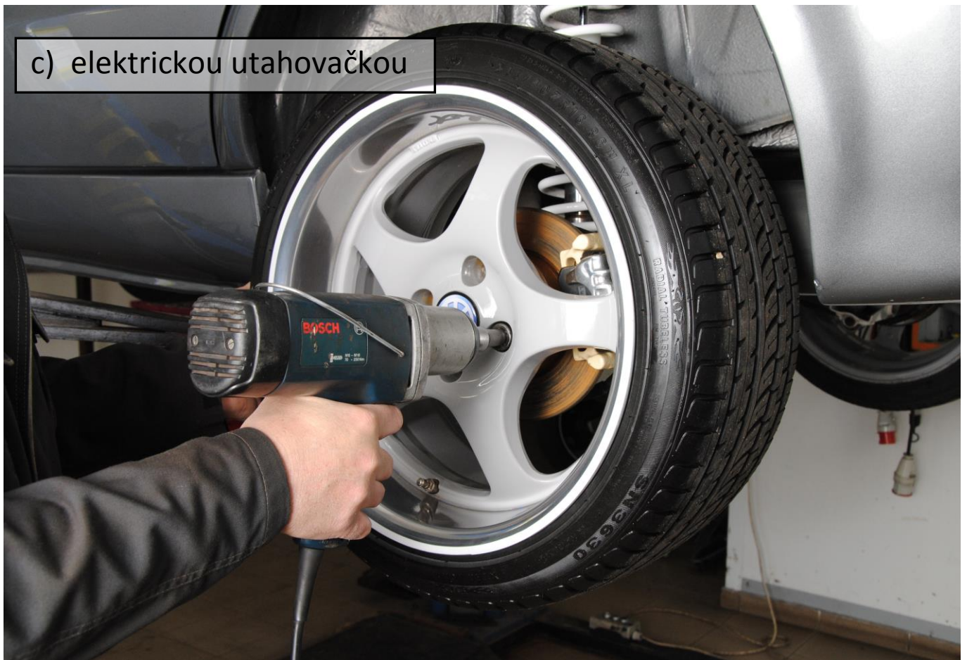
Obr. 5: Demontáž kola pomocí elektrické utahovačky
