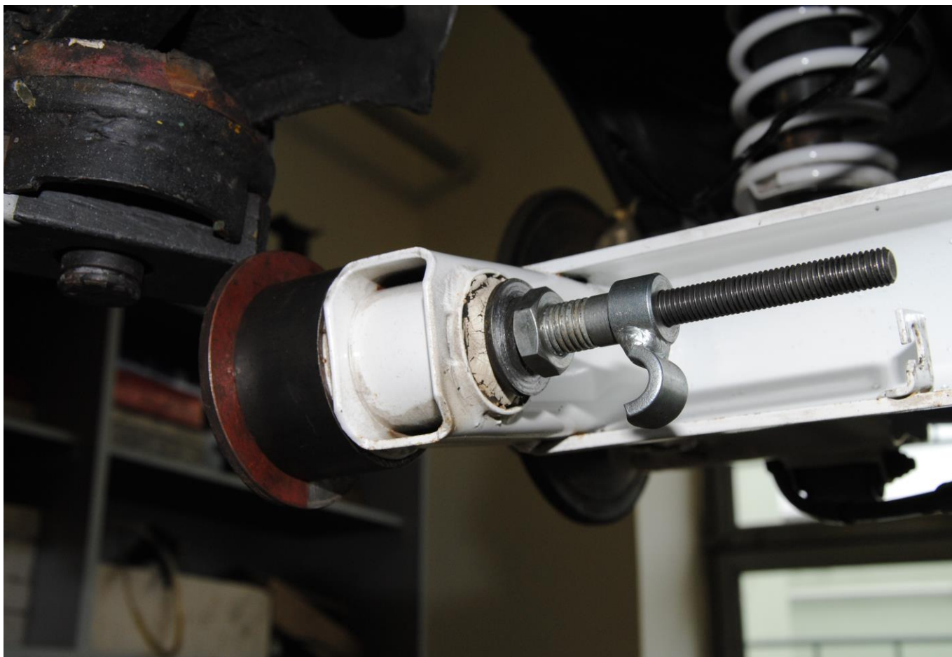
Obr. 9: Umístění přípravku na vylisování silentbloku
