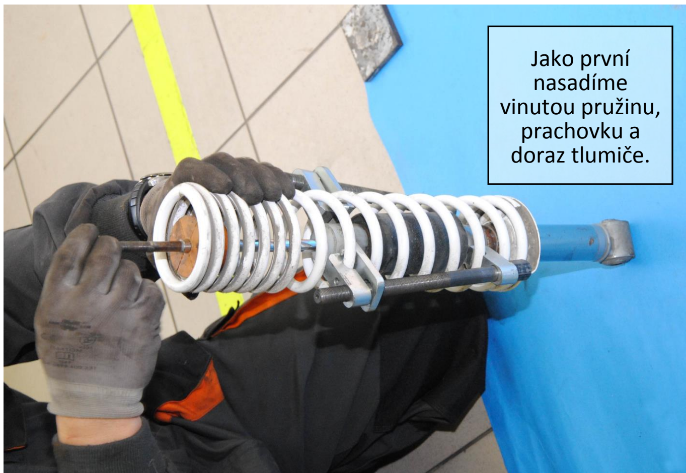
Obr. 17: Montáž vyměněných komponentů
