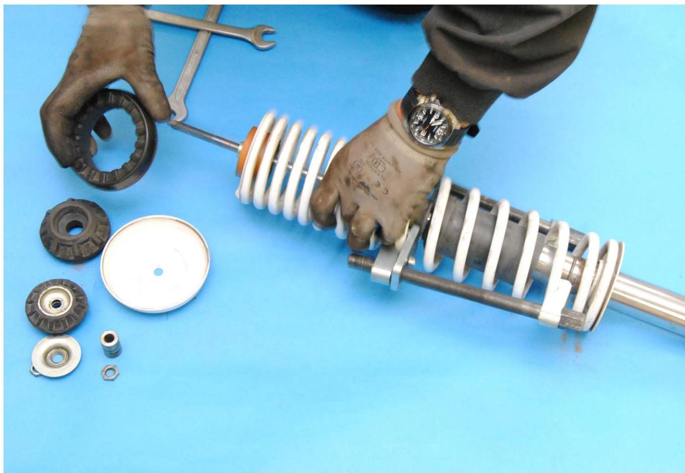
Obr. 14: Postupná demontáž tlumiče
