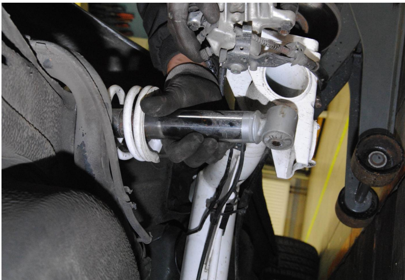
Obr. 9 : Vysunutí tlumiče z nápravnice
