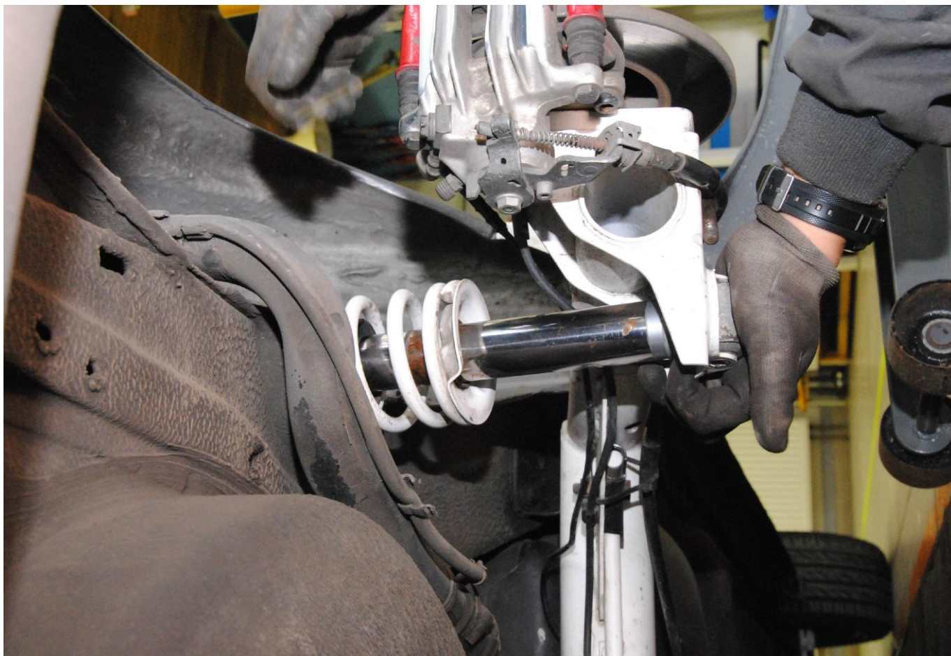
Obr. 22: Dotlačení oka tlumiče do nápravnice
