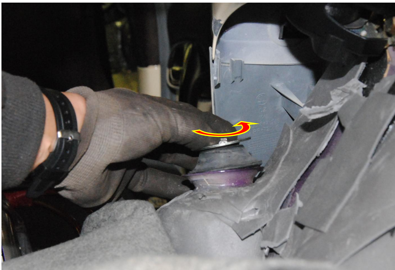
Obr. 10: Demontáž matice horního uložení tlumiče
