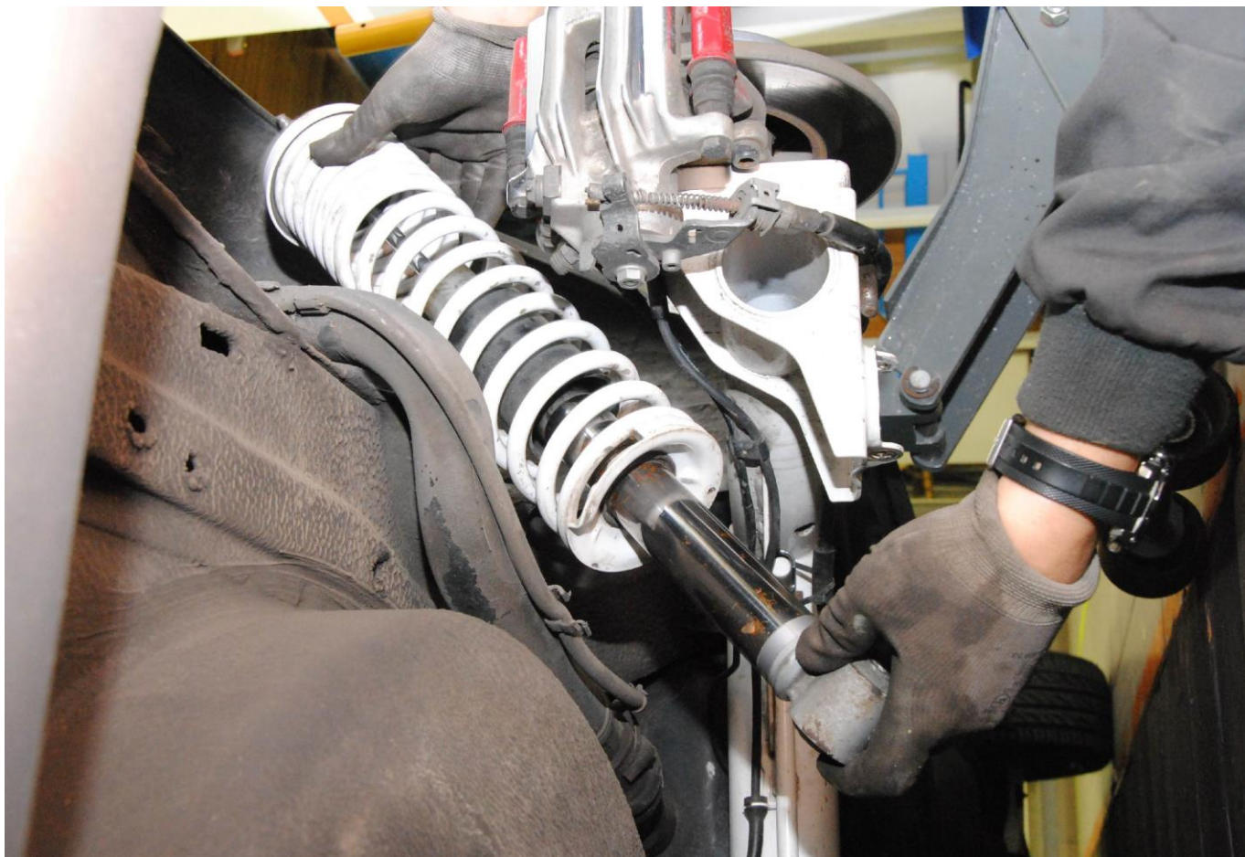
Obr. 21: Zpětné nasazení tlumiče
