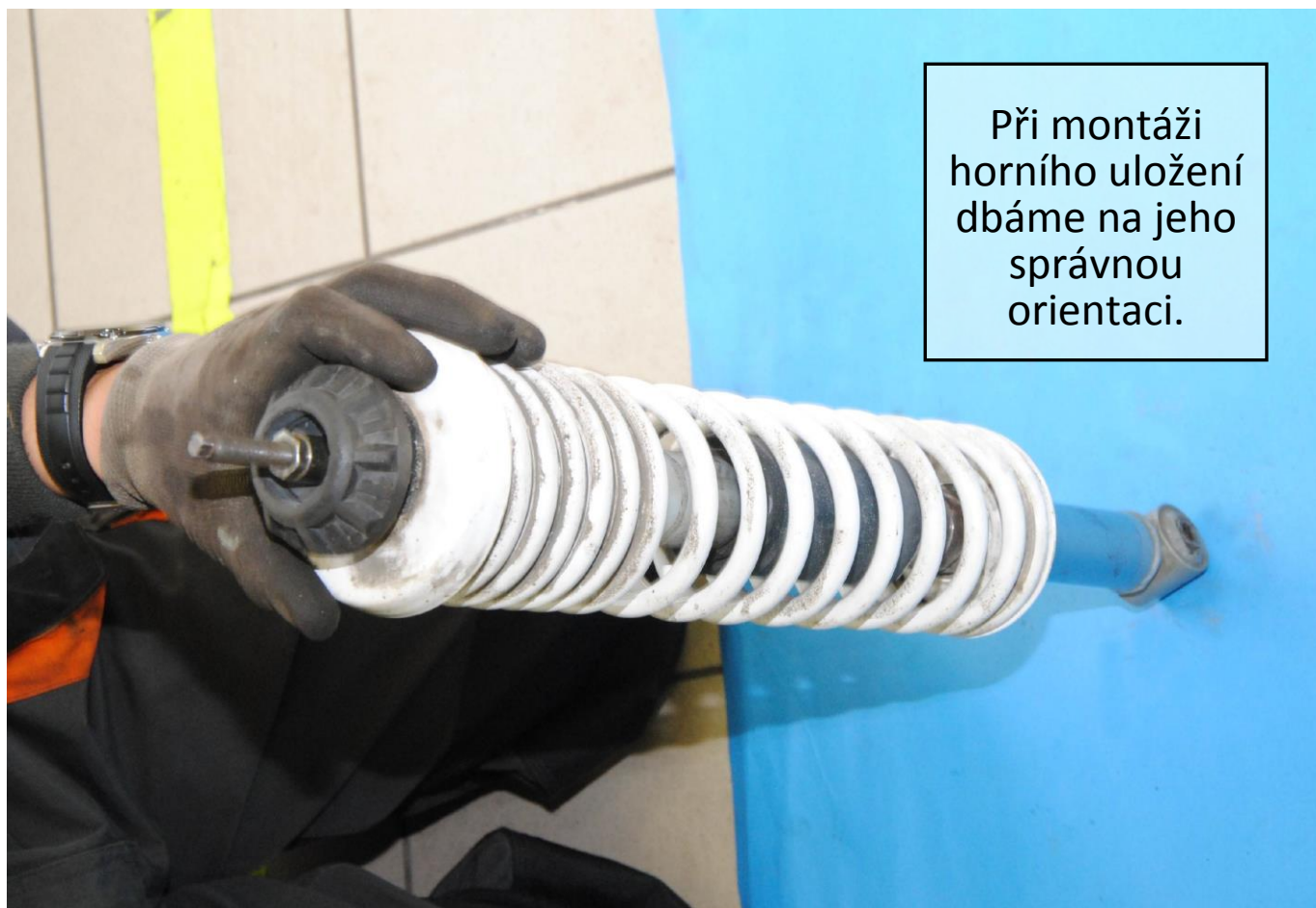
Obr. 20: Montáž horního uložení
