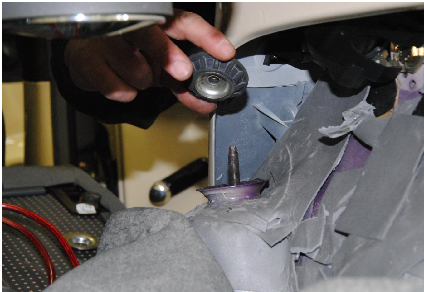
Obr. 24: Nasazení horní části horního uložení
