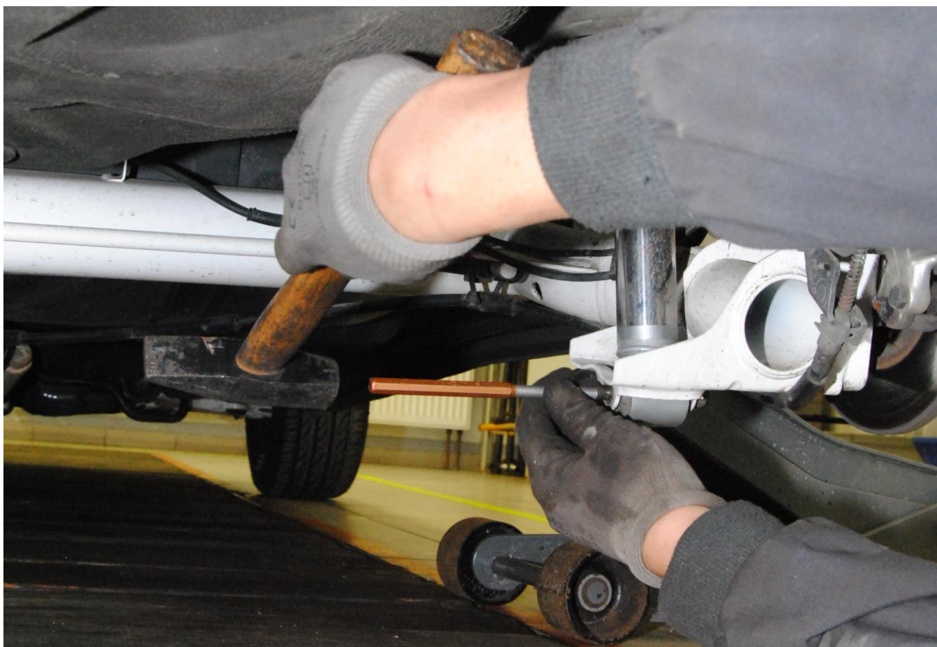
Obr. 8: Demontáž zajišťovacího šroubu tlumiče
