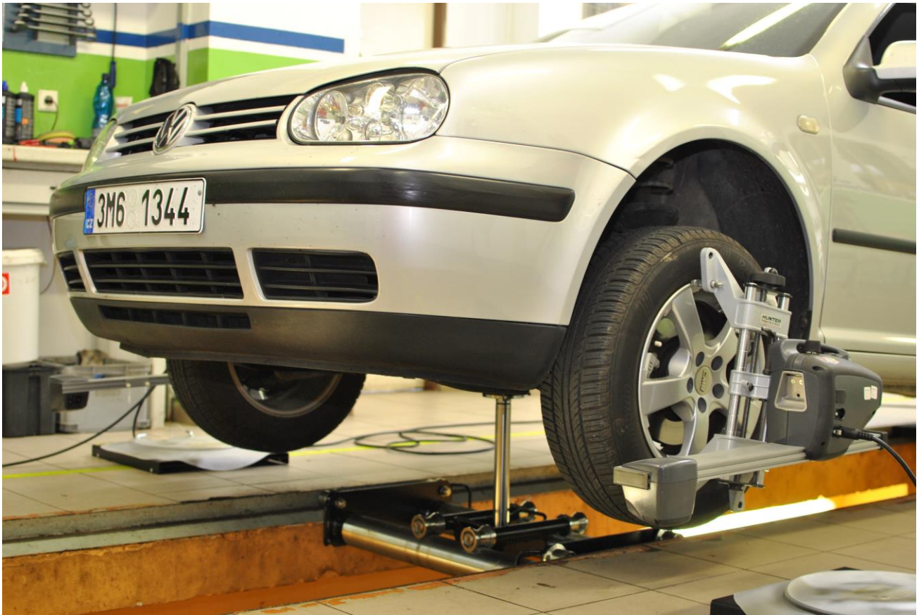
Obr. 22: Vyvěšení kol pro kompenzaci – zvednutí nápravy
