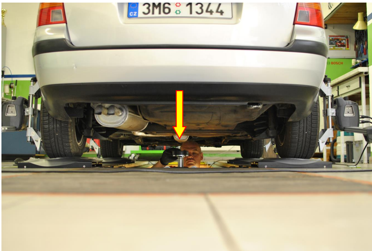
Obr. 36: Vložené otočné desky pod zadní kola a spuštěné vozidlo
