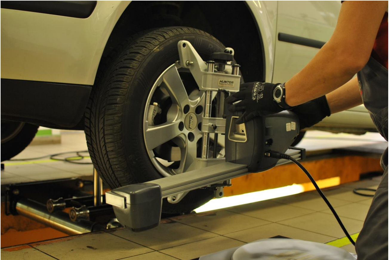
Obr. 23: Vyrovnání kamery do vodorovné polohy pomocí vodováhy
