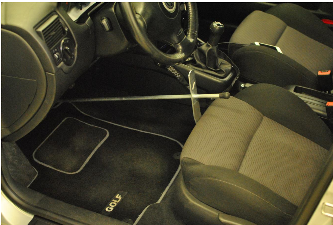
Obr. 37: Pomocí přípravku stlačíme brzdový pedál – přípravek je vzepřen o sedadlo řidiče
