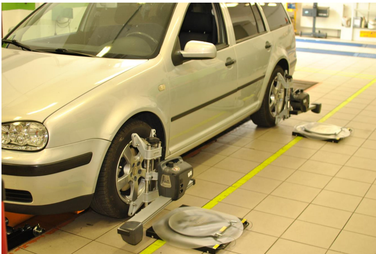
Obr. 10: Postupně nasazené kamery na všech kolech
