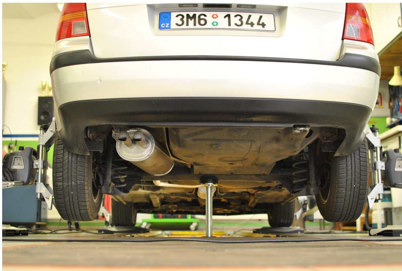
Obr. 33: Nadzvednutí zadní nápravy jámovým zvedákem (zvedák je umístěný na střed vozidla)
