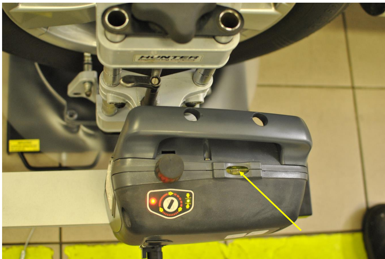
Obr. 38: Kontrola vodorovné polohy kamery
