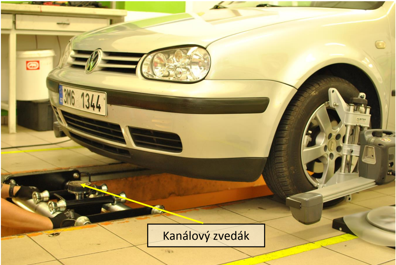
Obr. 21: Přisunutí jámového zvedáku pod přední nápravu
