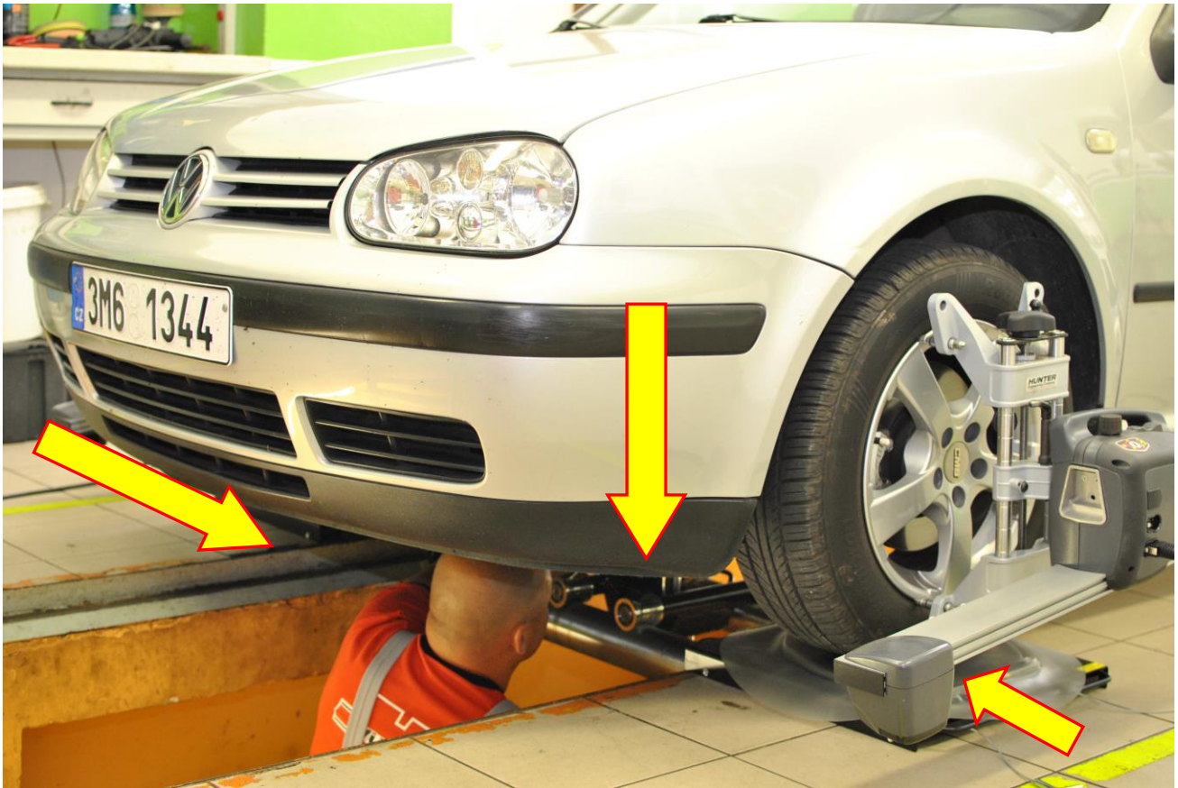
Obr. 32: Umístění otočné plošiny pod pevná kola a spuštění vozidla
