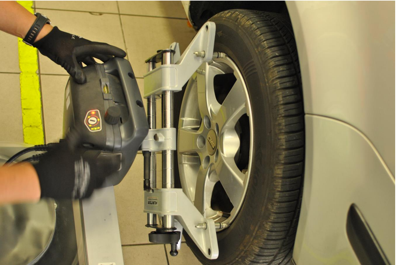
Obr. 34: Kompensace kamer prováděná stejně jako na přední nápravě
