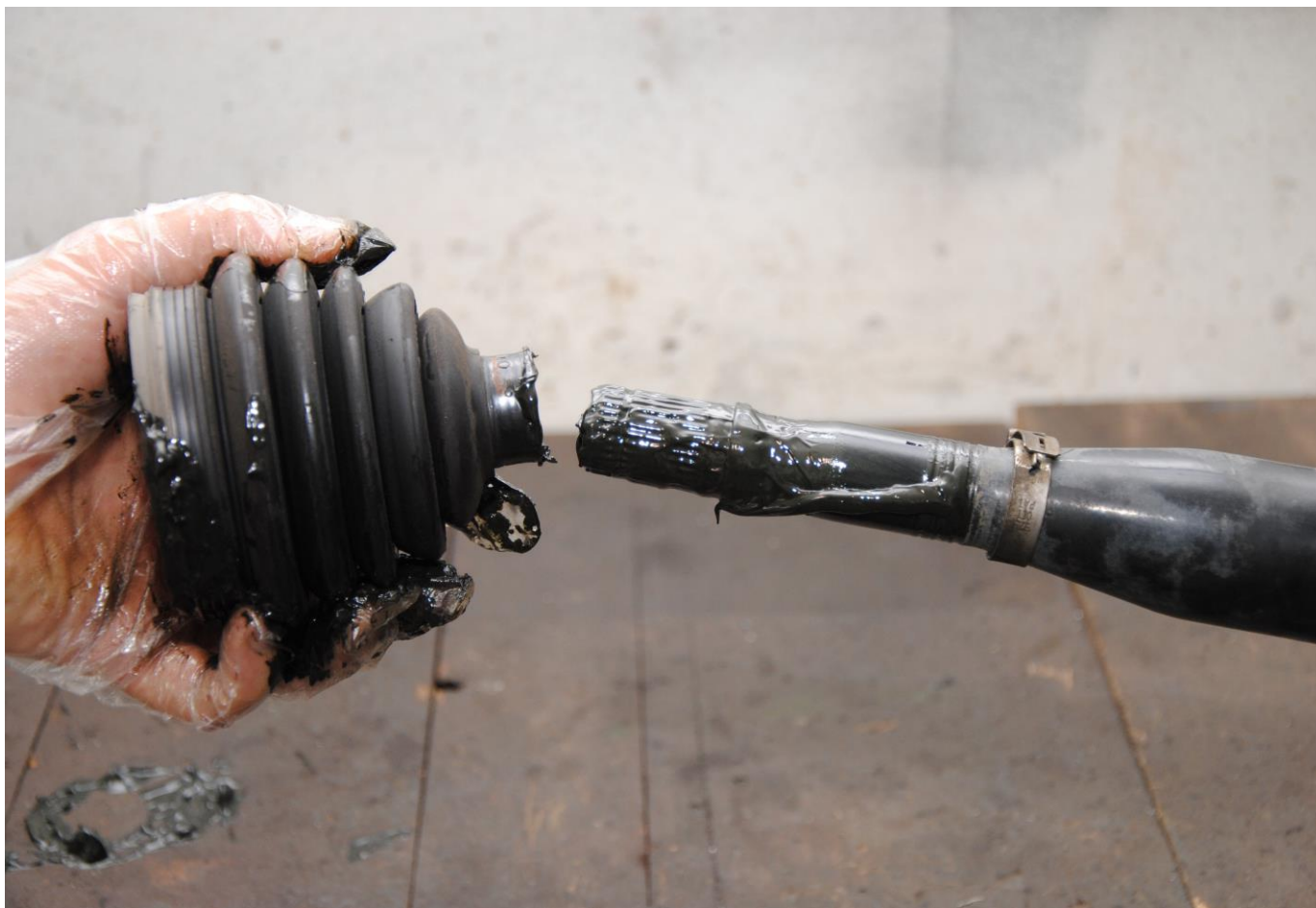
Obr. 18: Sejmutí manžety z hřídele
