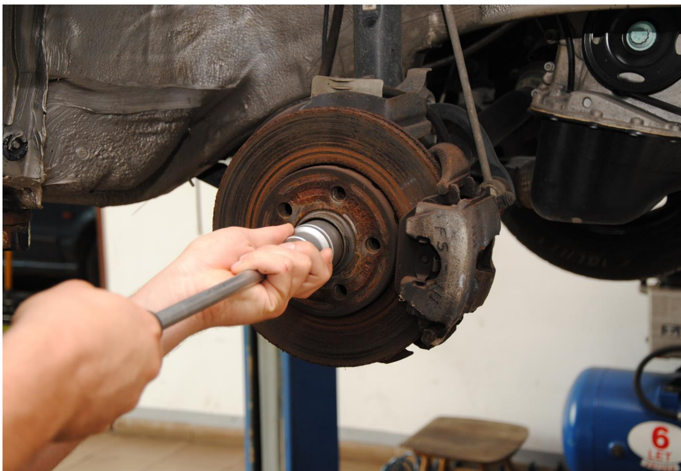
Obr. 4: Demontáž povolené matice
