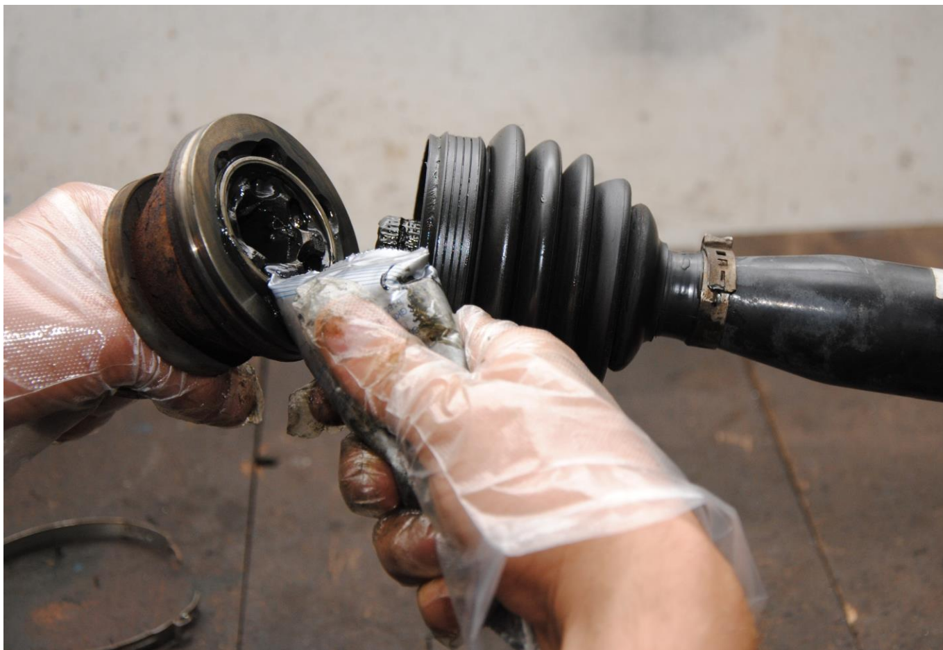
Obr. 25: Natlačení tuku do homokinetického kloubu
