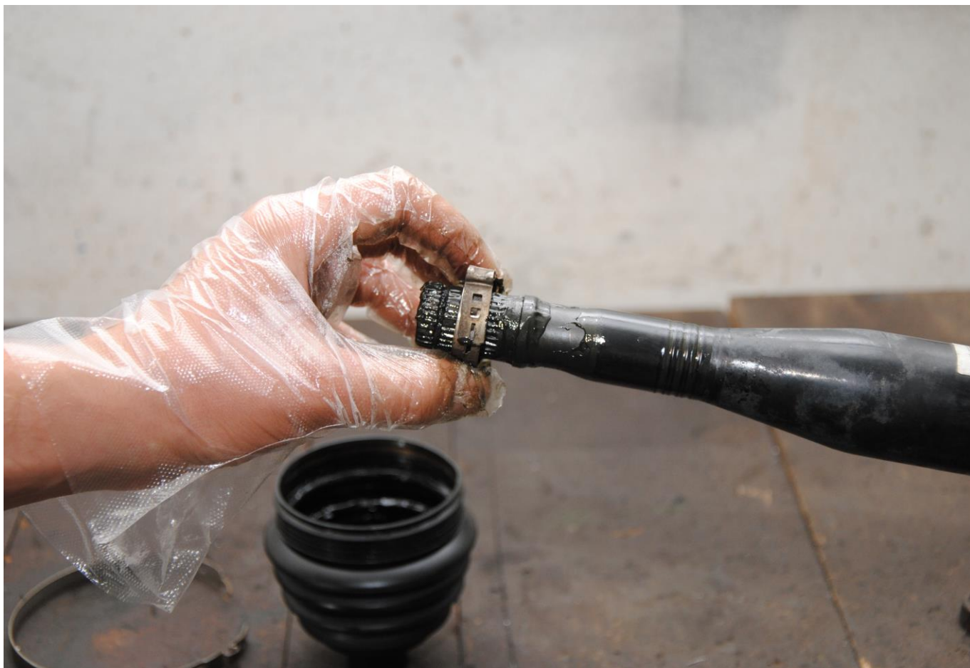
Obr. 21: Nasazení vnitřní zajišťovací pásky
