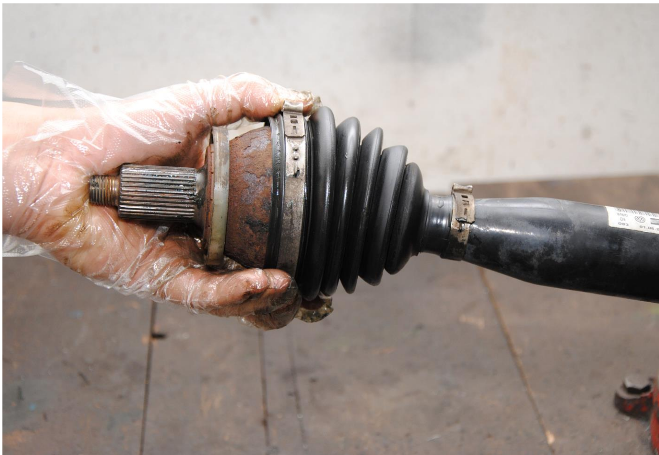
Obr. 27: Nasazení vnější zajišťovací pásky
