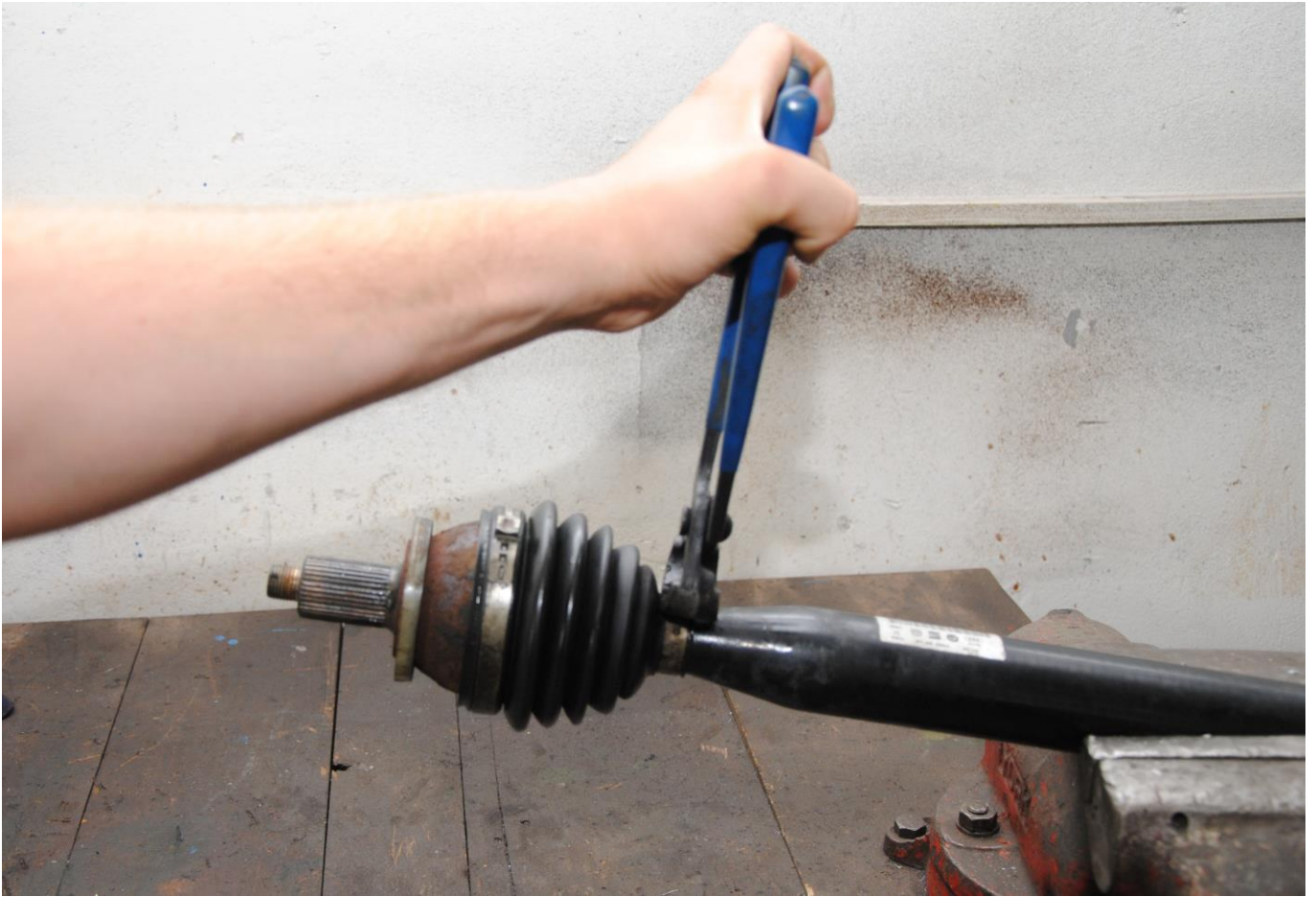
Obr. 31: Stáhnutí vnitřní pásky
