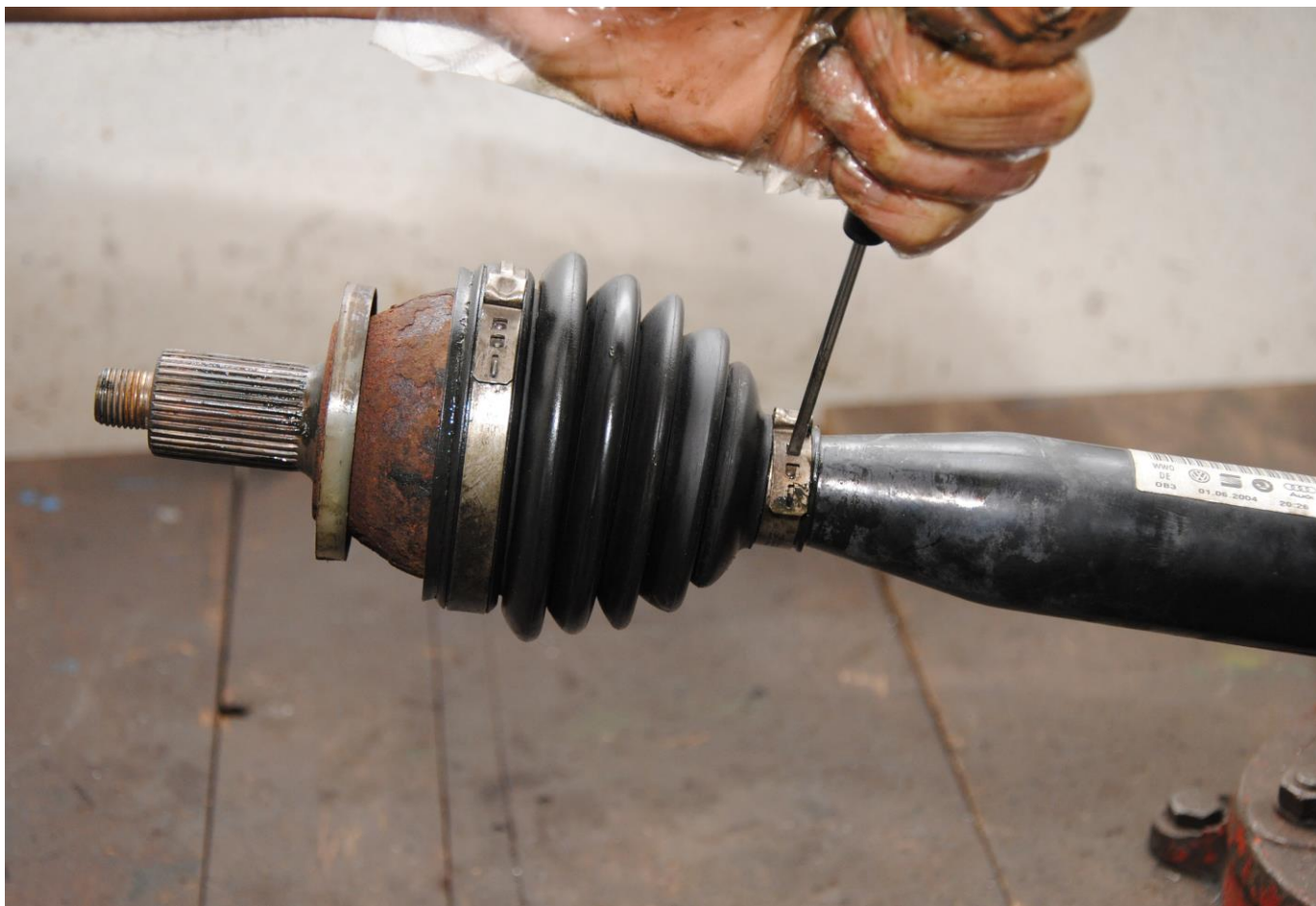
Obr. 29: Zajištění vnitřní pásky
