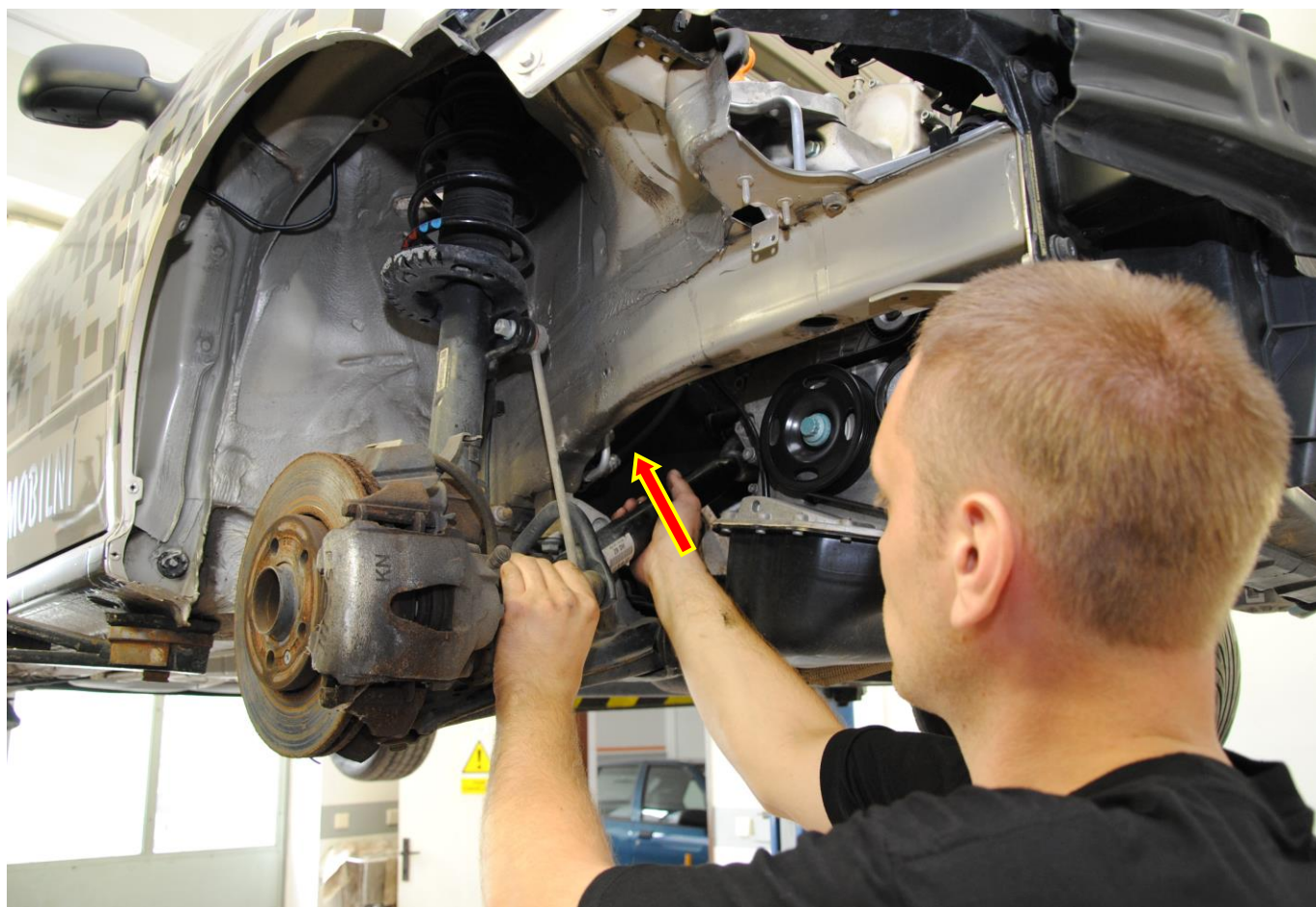
Obr. 9: Vysunutí a pozvednutí hřídele
