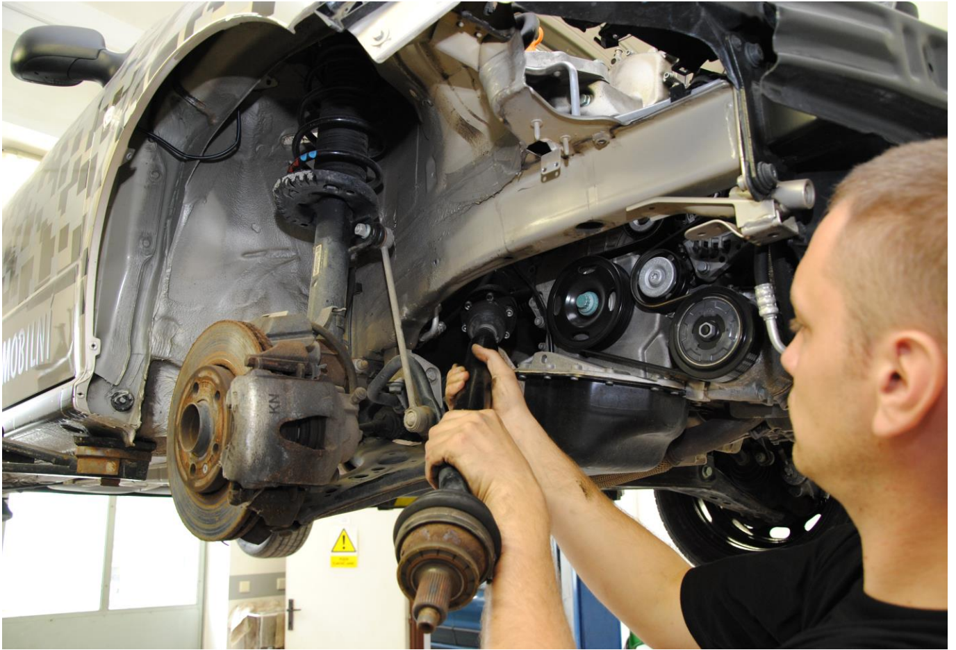
Obr. 10: Vysunutí z náboje kola a vytažení
