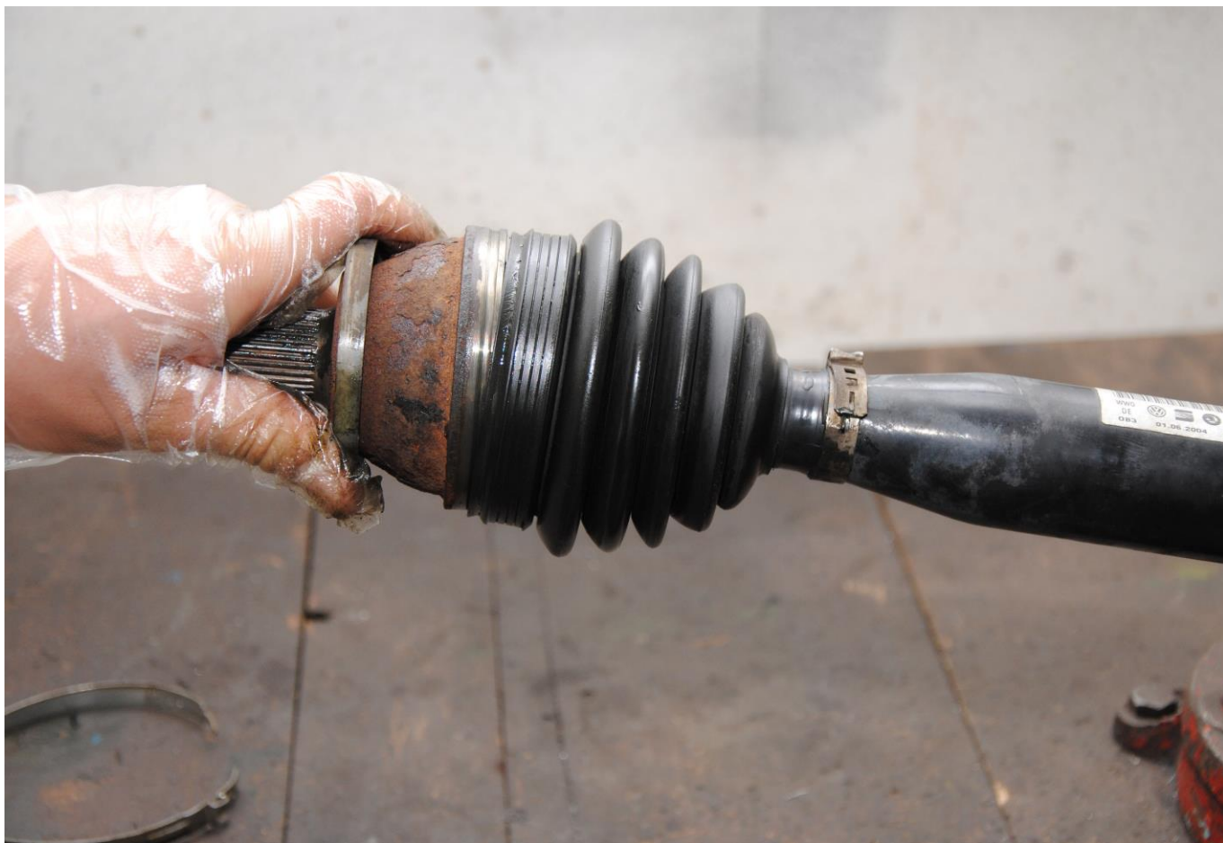
Obr. 26: Nasazení kloubu na hnací hřídel
