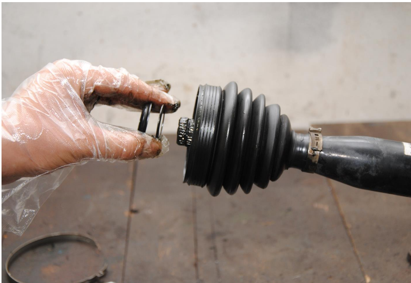
Obr. 24: Nasunutí dorazových kroužků na hřídel
