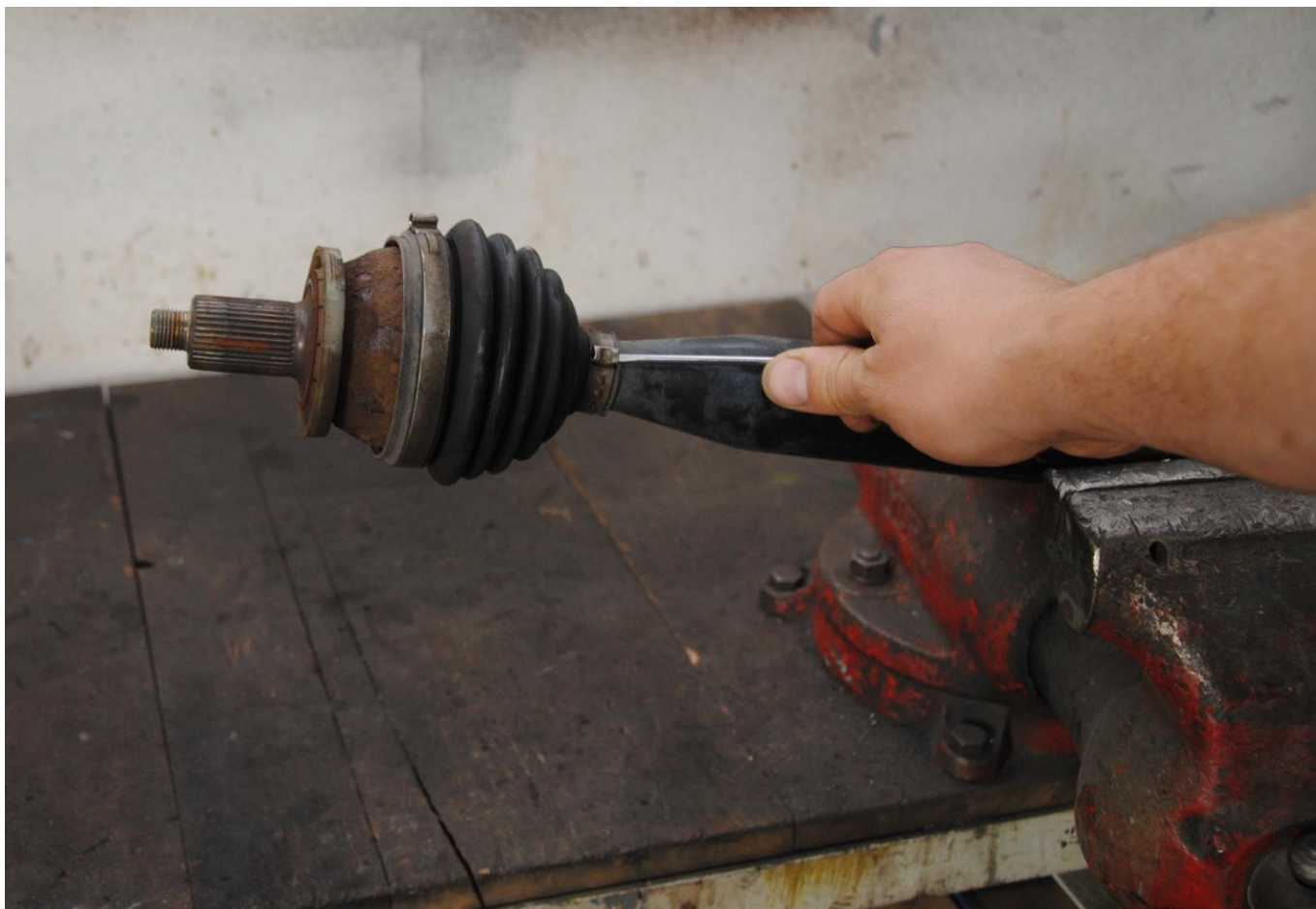
Obr. 13: Uvolnění vnitřní pásky manžety
