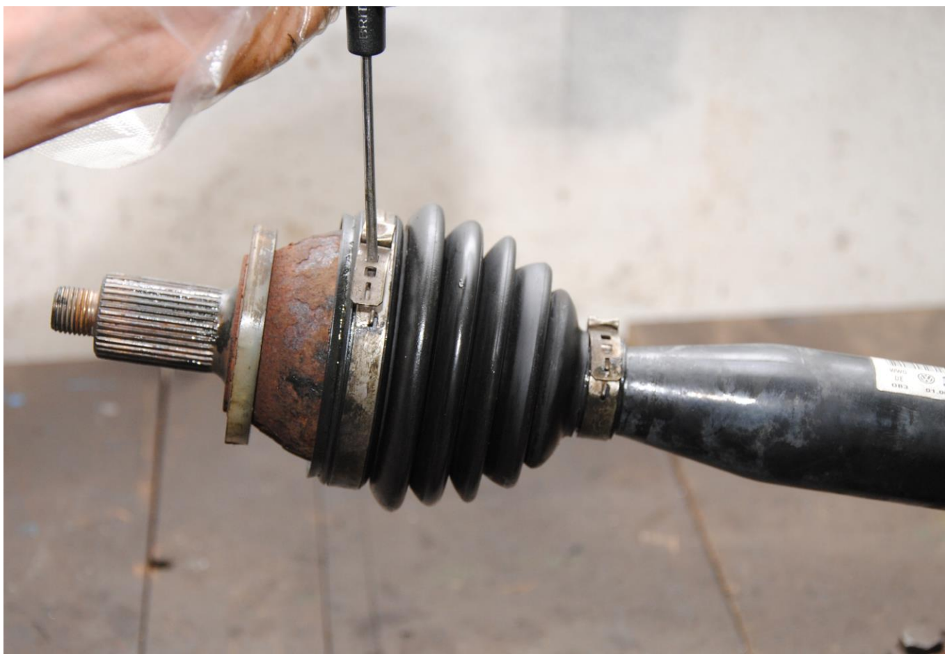
Obr. 28: Zajištění vnější pásky
