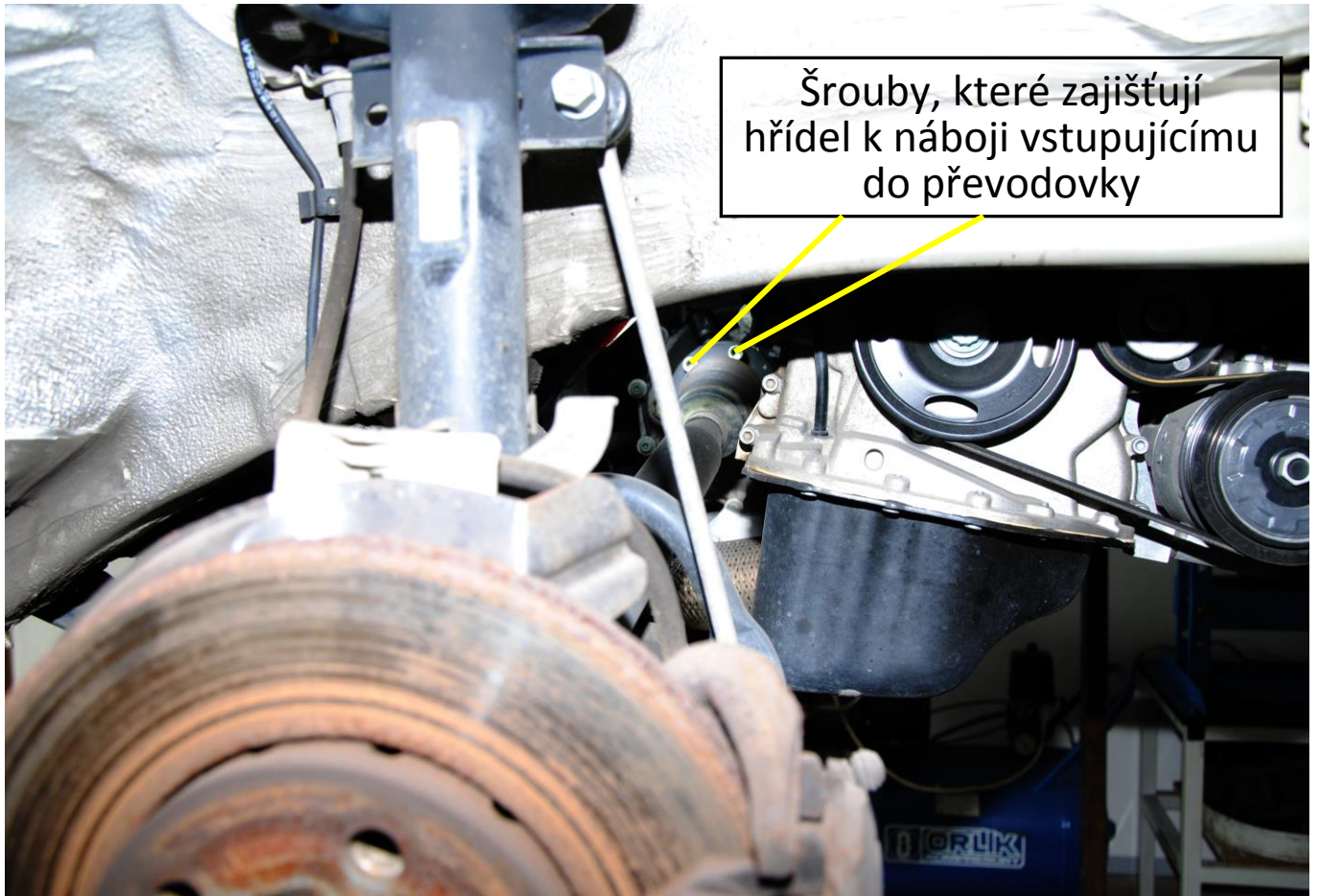
Obr. 5: Umístění hnací hřídele na vozidle
