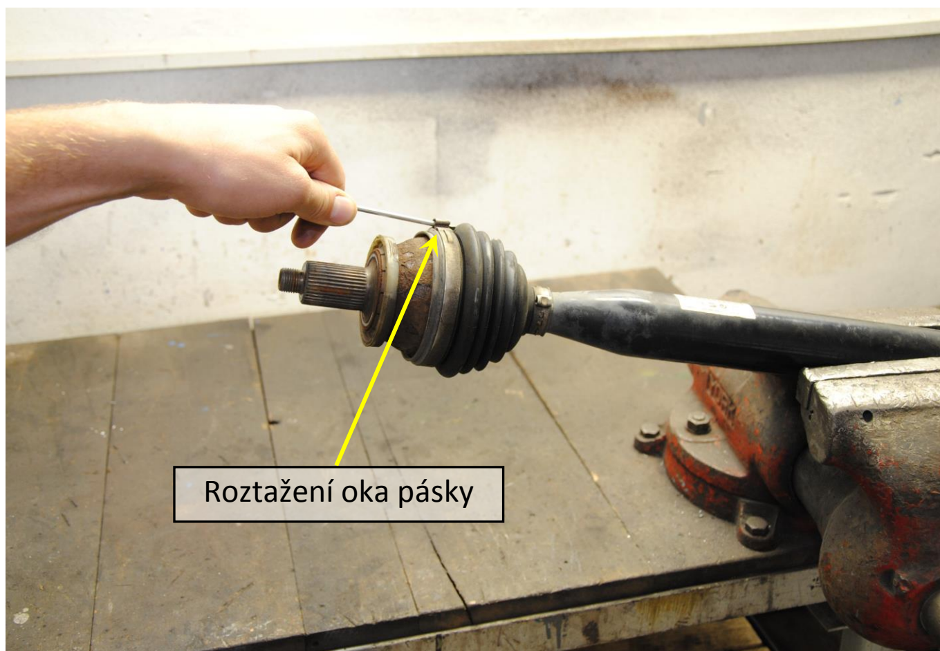
Obr. 12: Demontáž zajišťovací pásky
