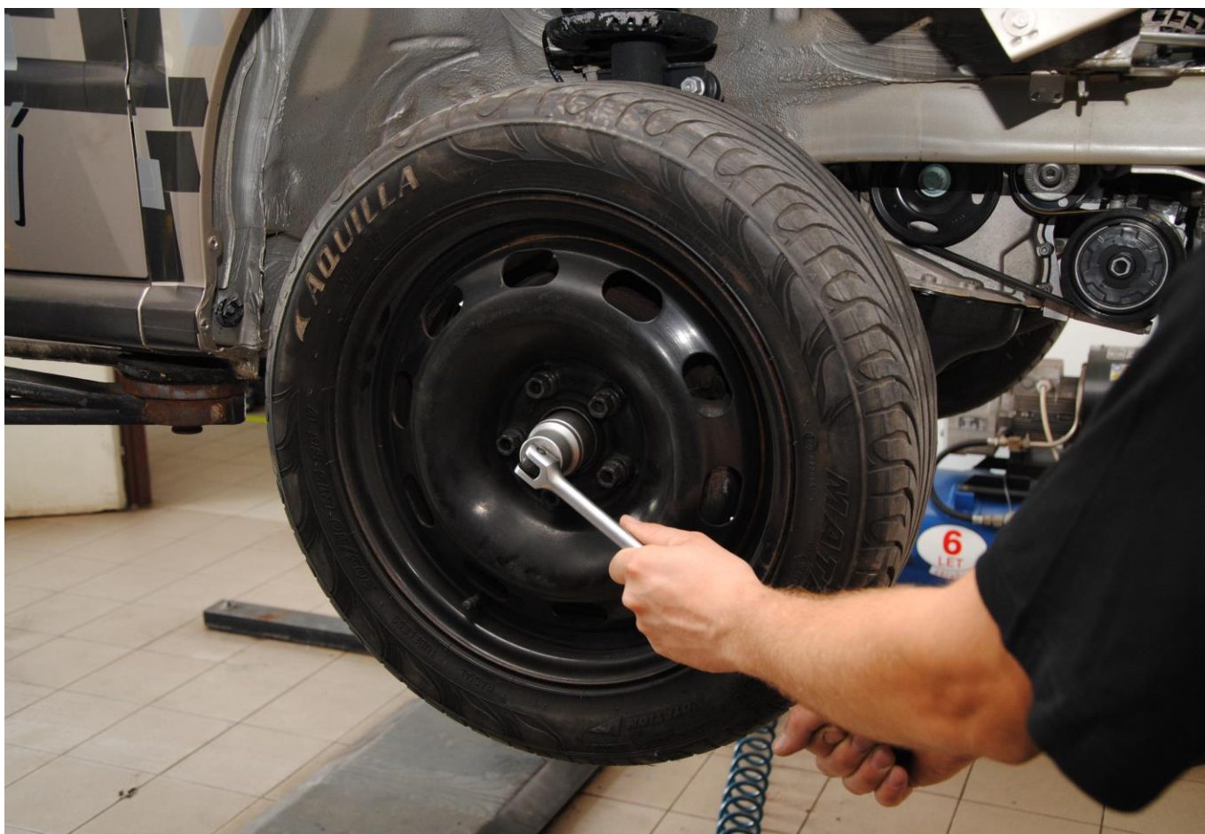
Obr. 1: Povolení matice hnací hřídele
