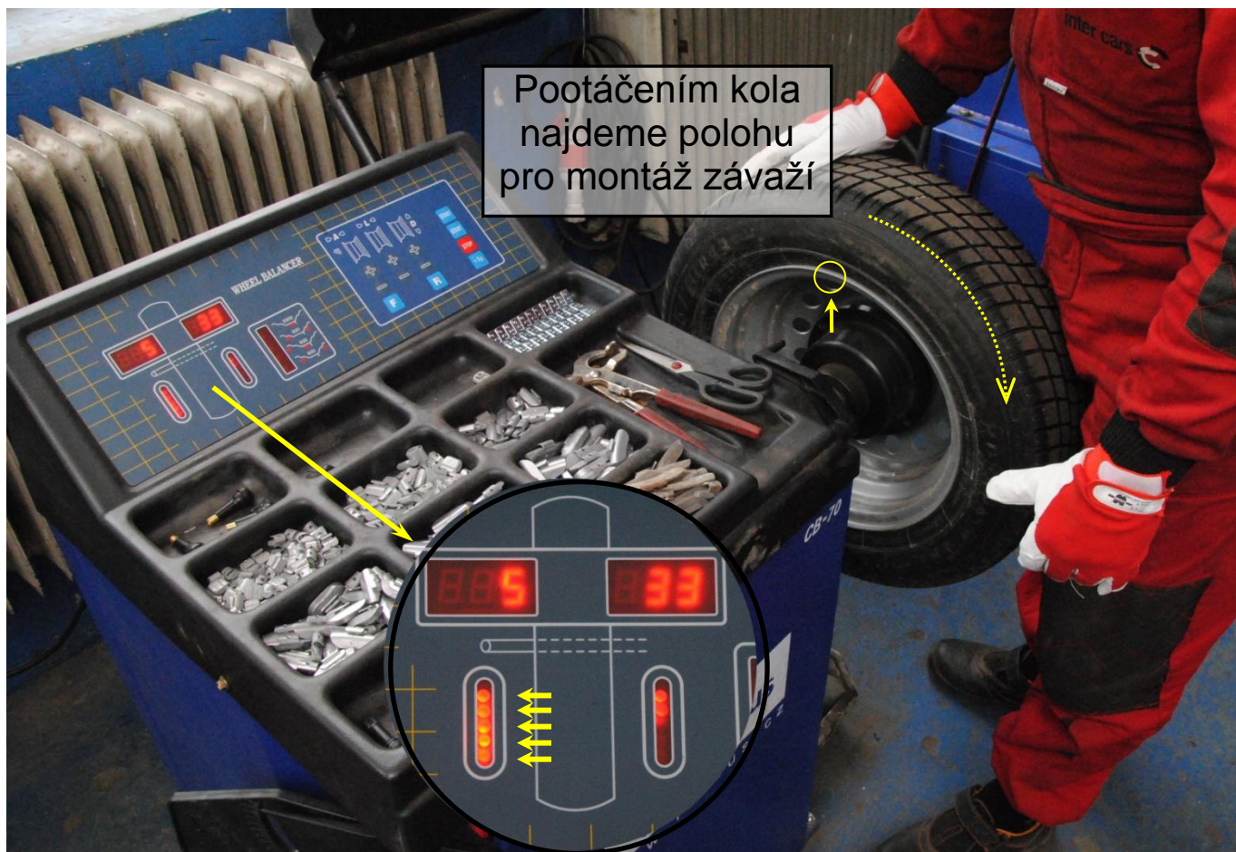
Obr. 11: Hledání polohy závaží na vnitřním okraji kola
