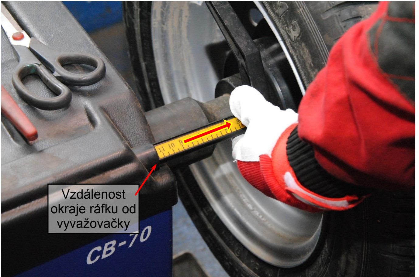
Obr. 3: Vzdálenost okraje ráfku od čela vyvažovačky
