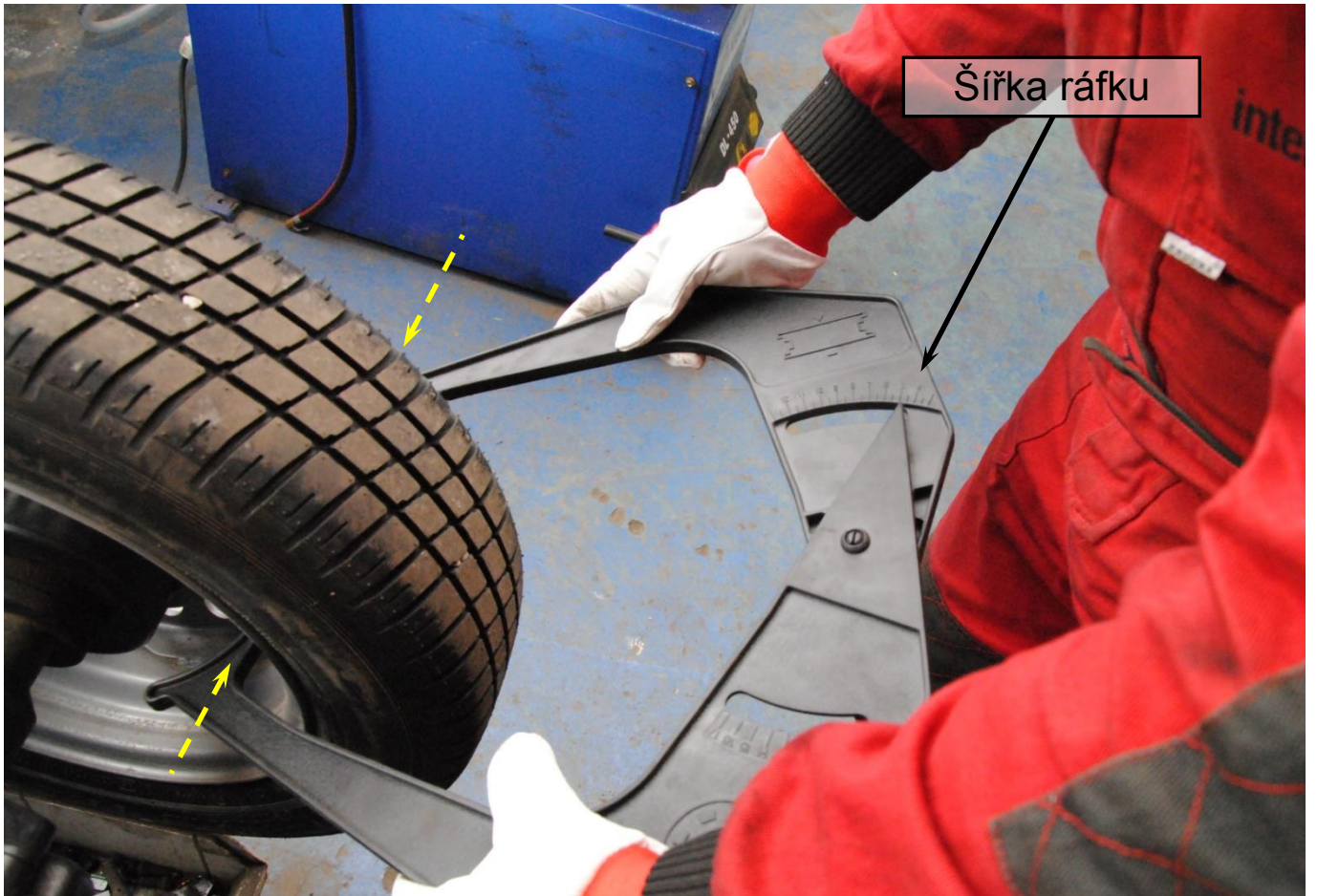
Obr. 5: Měření šířky ráfku
