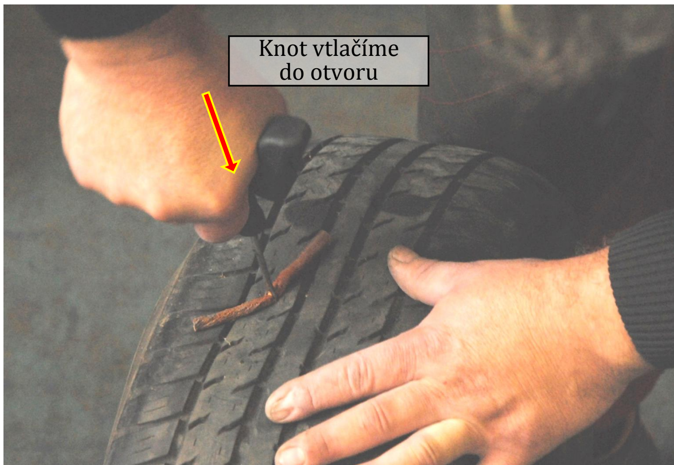
Obr. 6: Vtlačení knotu do otvoru
