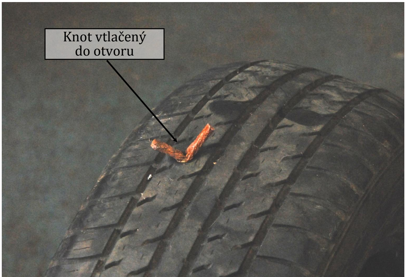
Obr. 8 : Knot v otvoru
