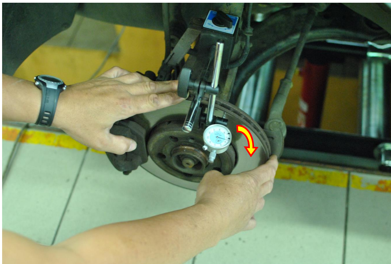
Obr. 5: Měření vnější axiální házivosti
