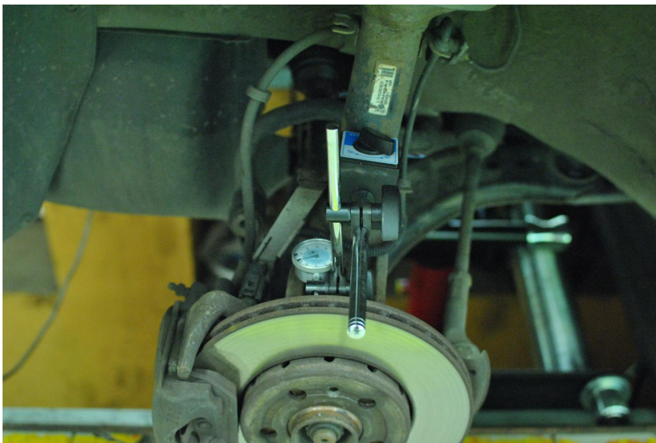
Obr. 6: Umístění stojánku pro měření vnitřní házivosti
