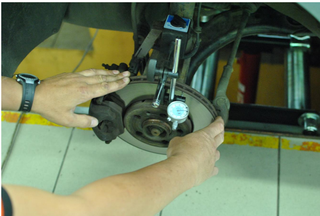
Obr. 4: Stupnice na měřidle nastavená na „0“
