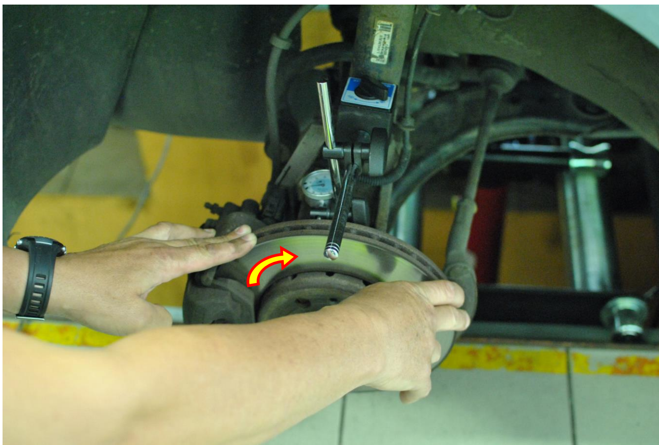
Obr. 8: Měření vnitřní házivosti
