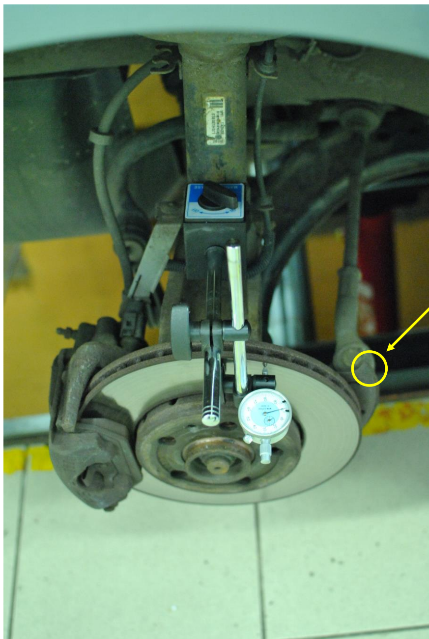
Obr. 3: Měřící hrot dotýkající se vnější třecí plochy
