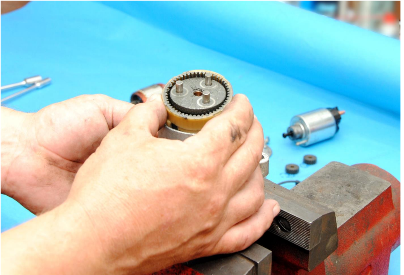
Obr. 13: Demontáž části převodovky
