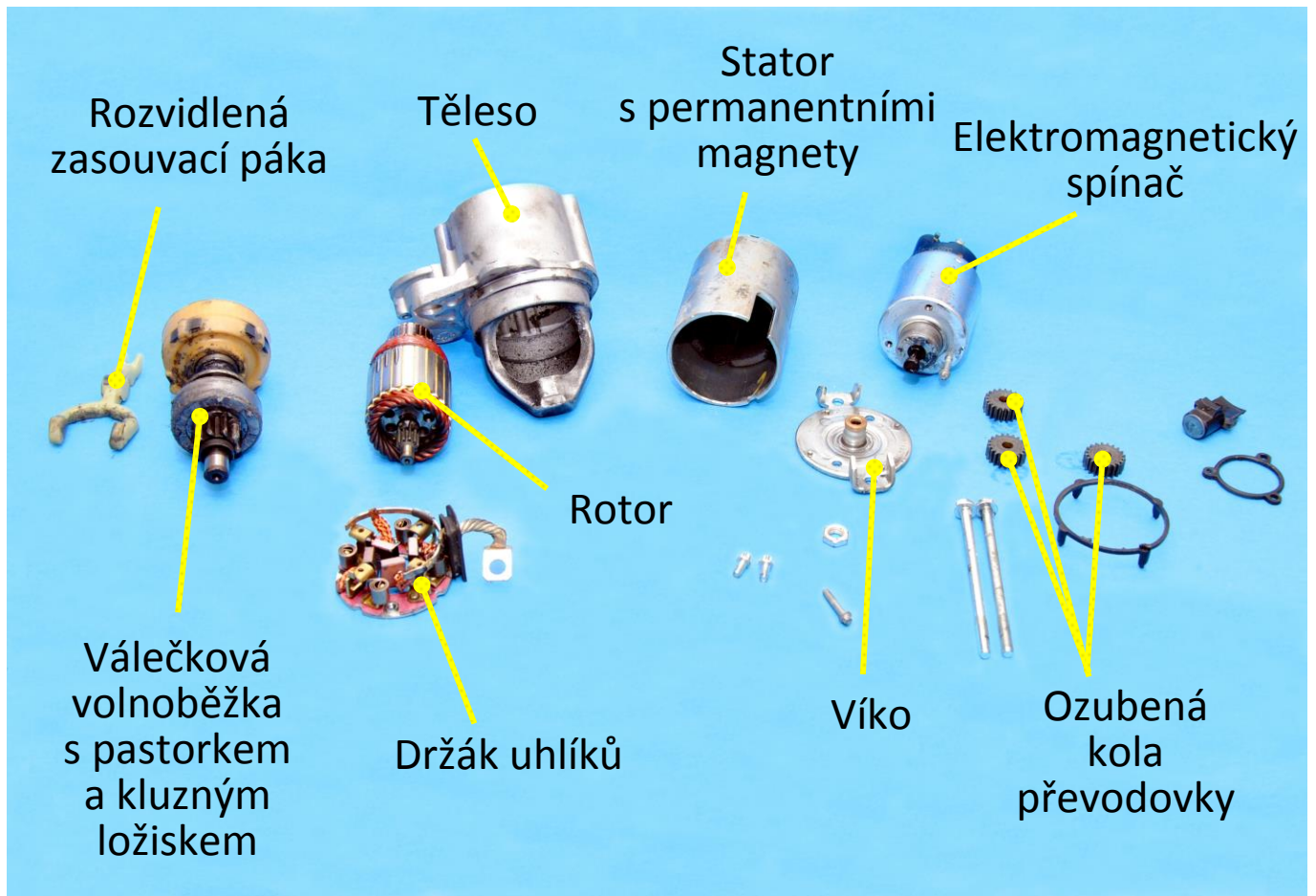
Obr. 17: Všechny části elektrického spouštěče
