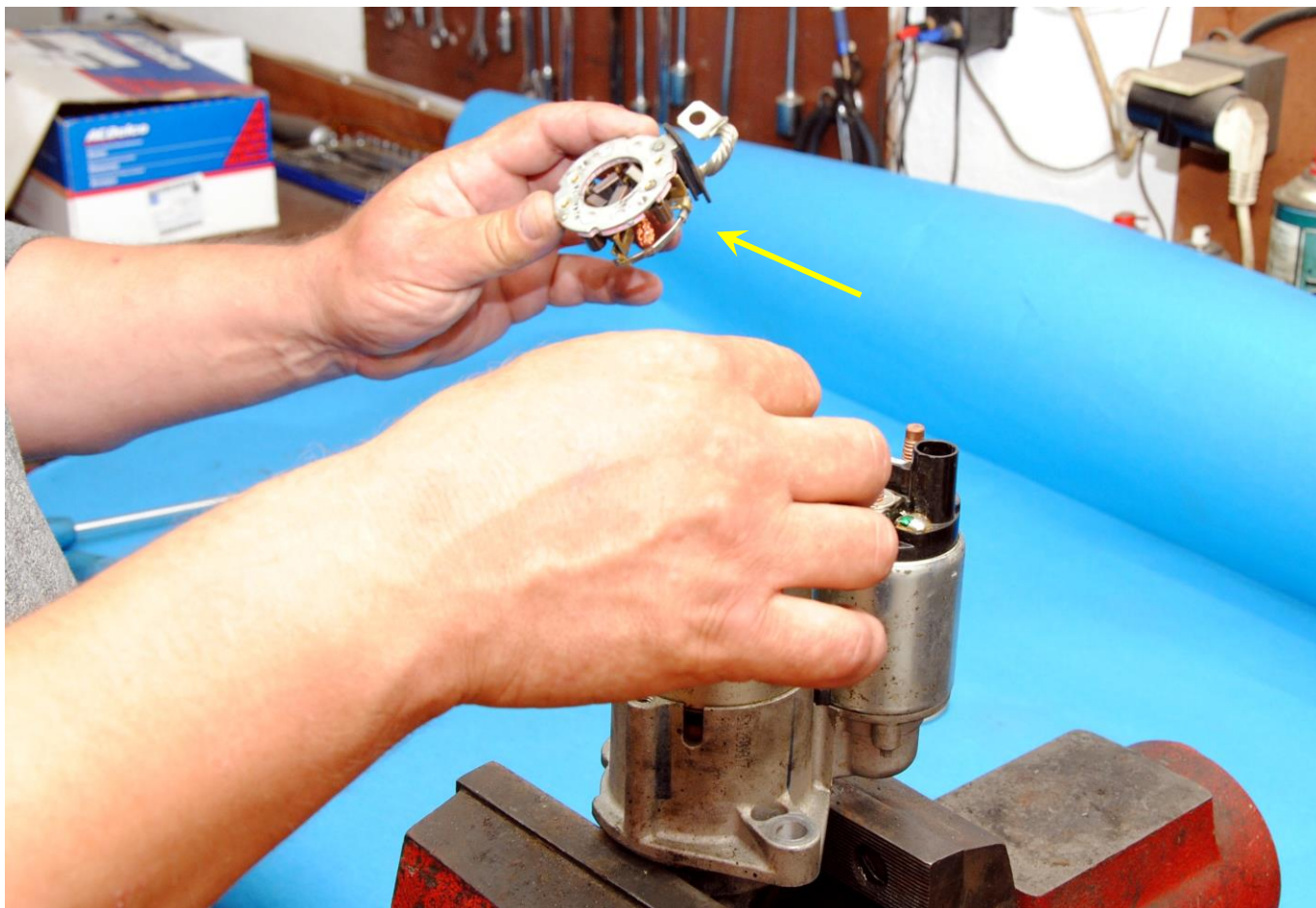
Obr. 6: Pohled na demontovaný držák s uhlíky
