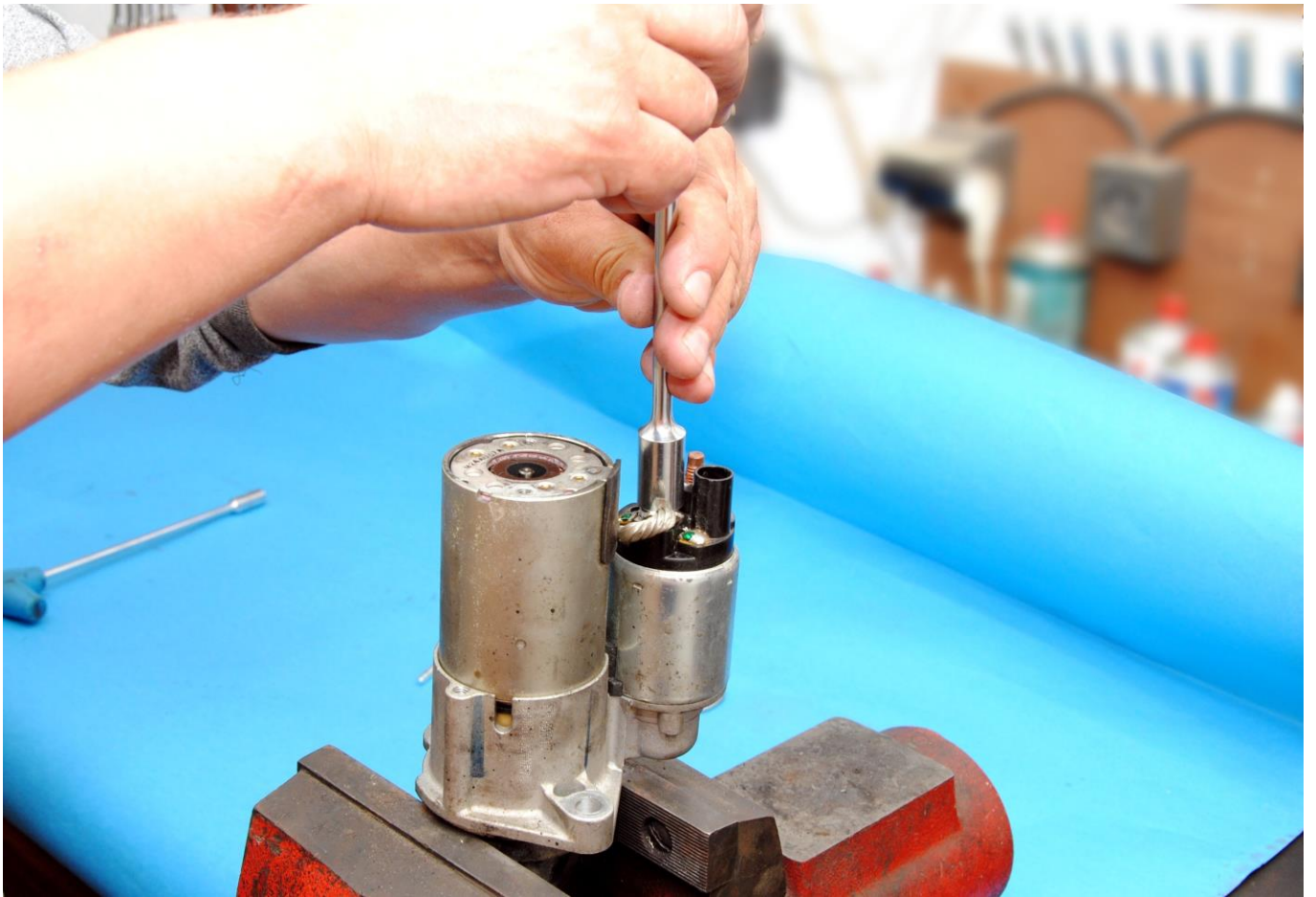
Obr. 4: Demontáž matice zajišťující vodič u kabelových svorek
