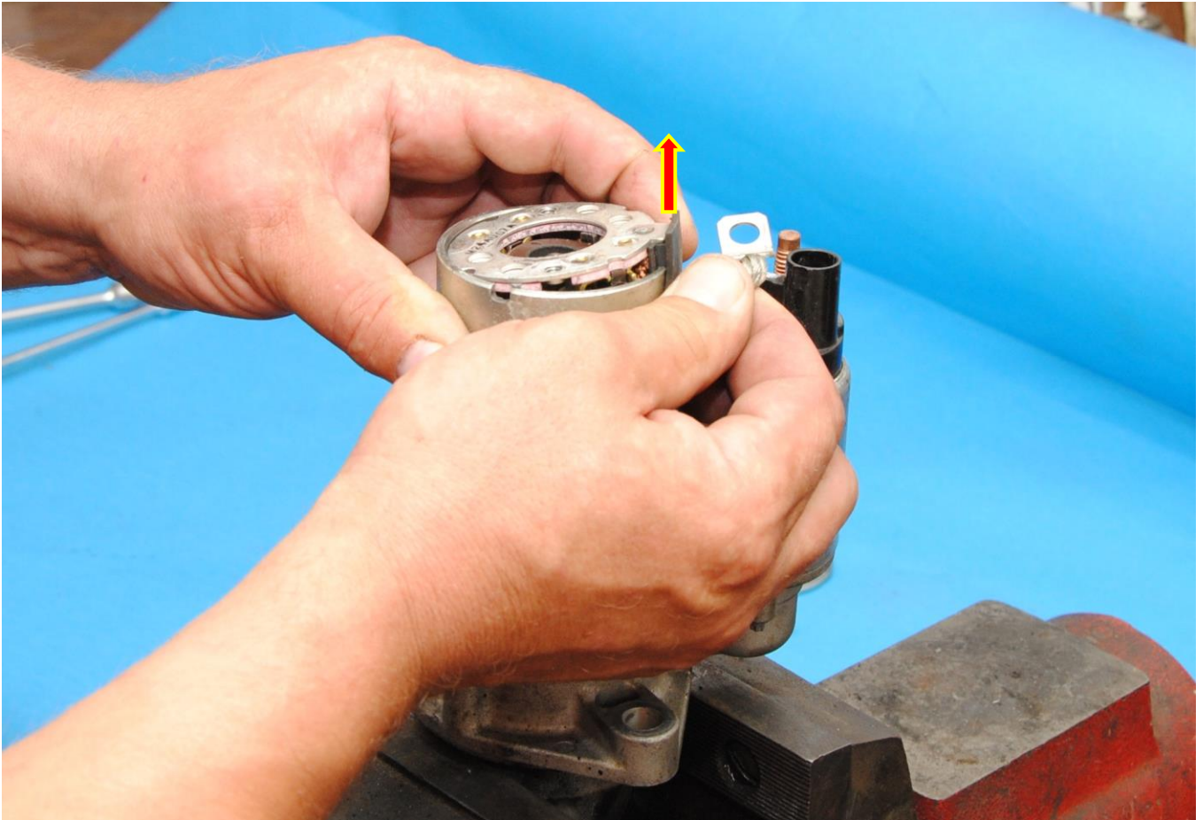
Obr. 5: Demontáž zadní části elektrického spouštěče s uhlíky
