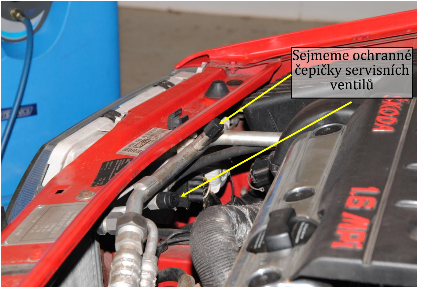
Obr. 2: Servisní ventily klimatizace
