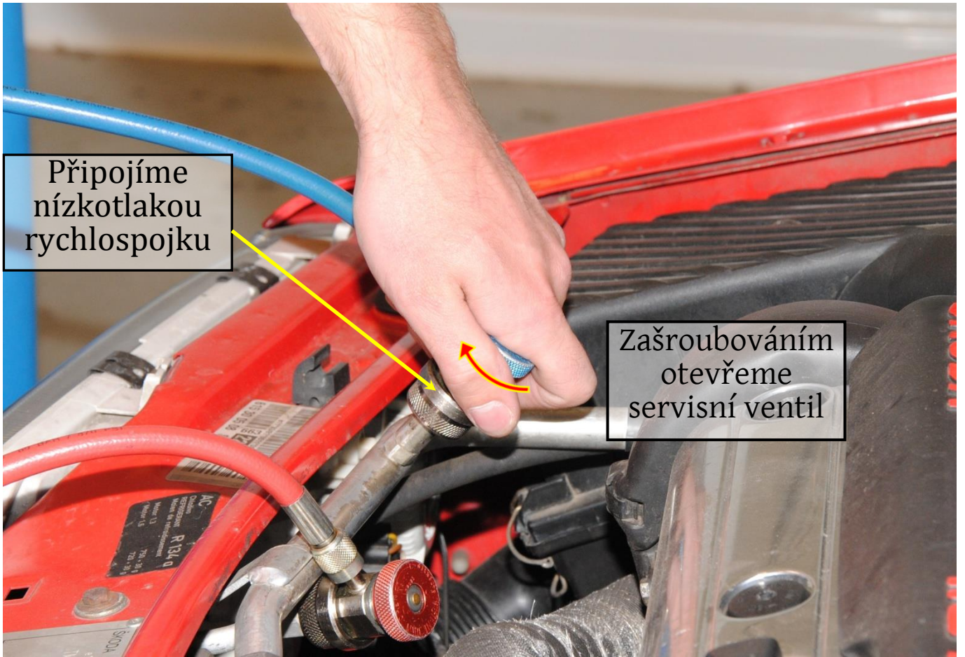
Obr. 5: Připojení nízkotlaké hadice
