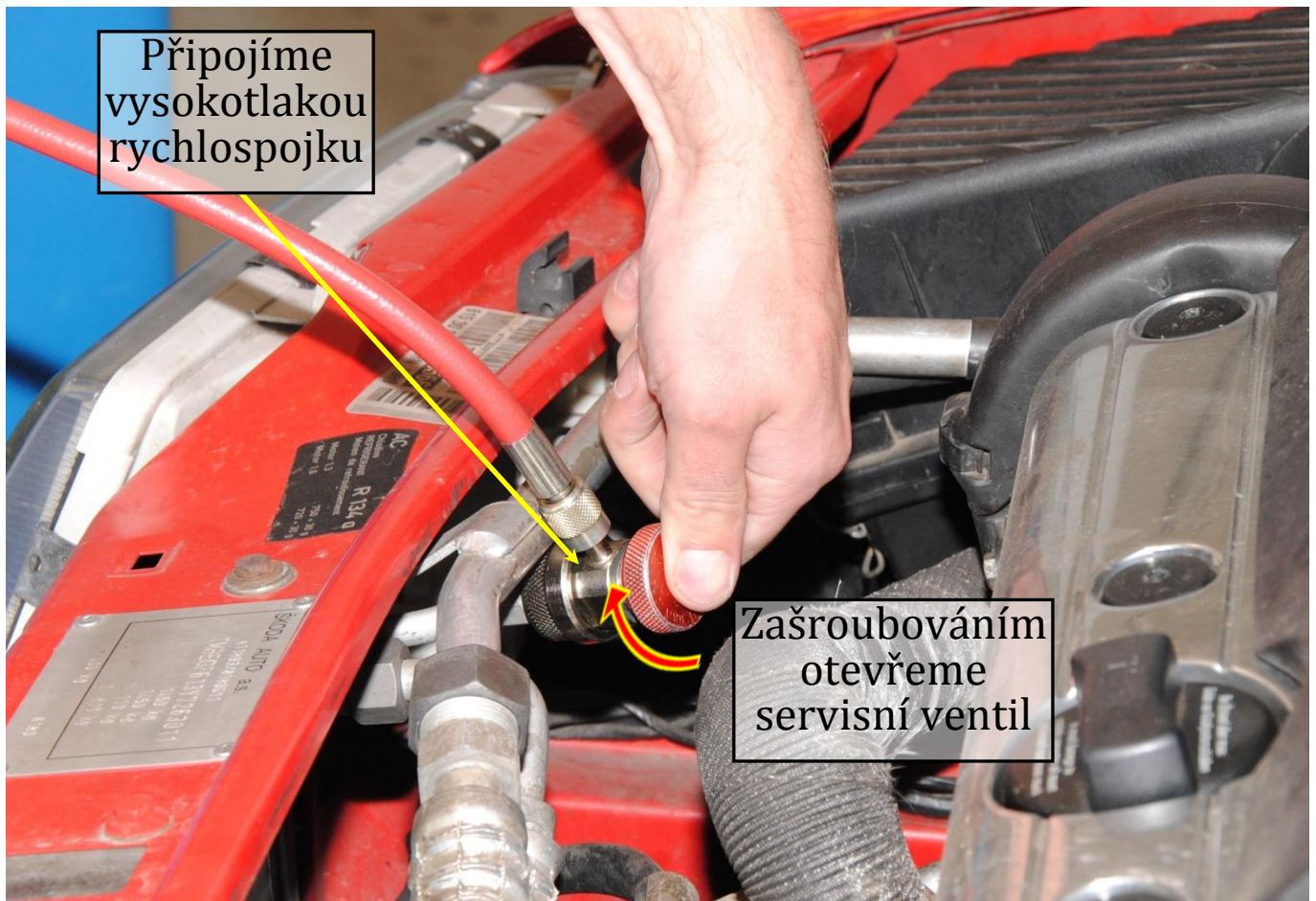
Obr. 4: Připojení vysokotlaké hadice
