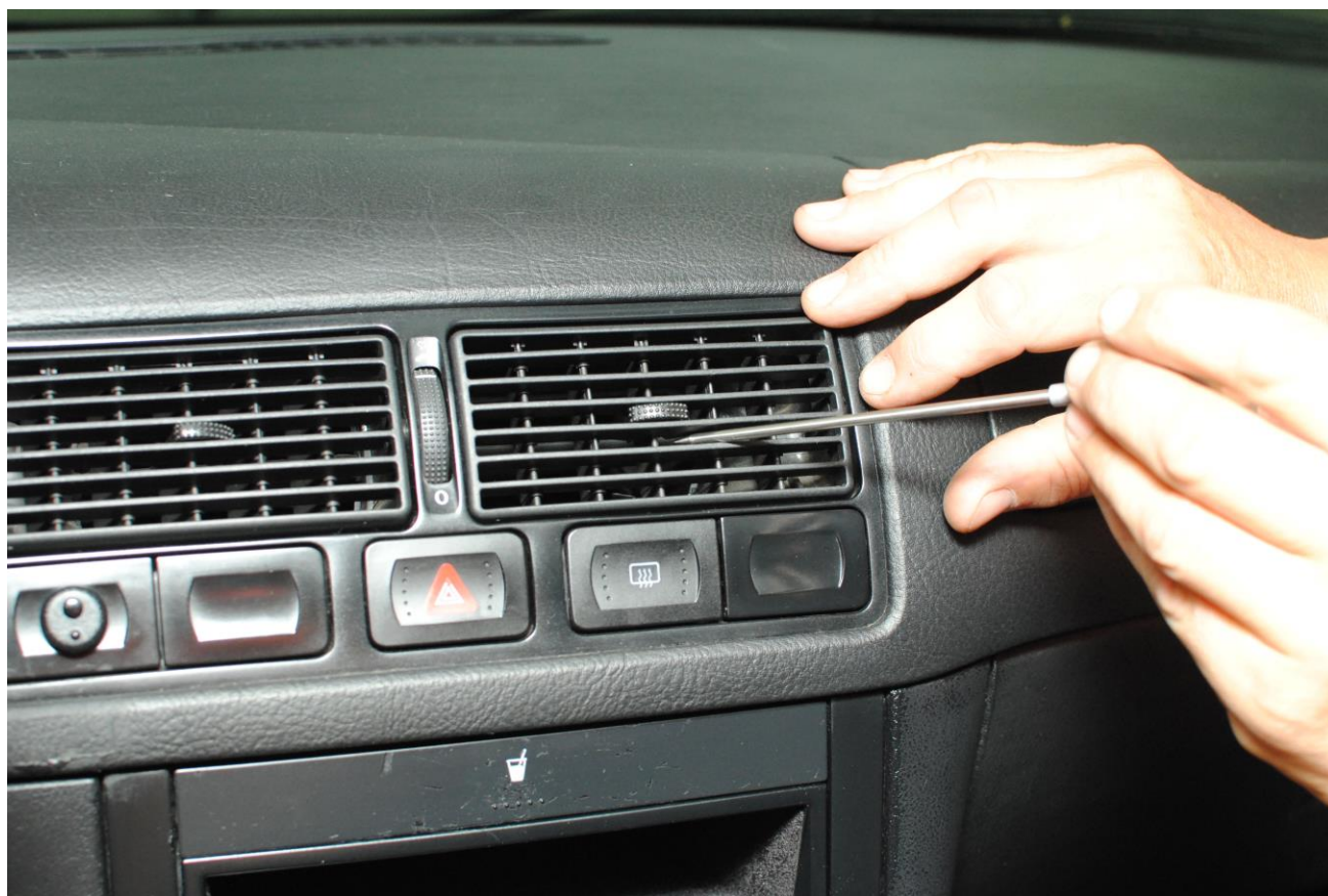
Obr. 3: Teploměr zasuneme do mřížky ventilace
