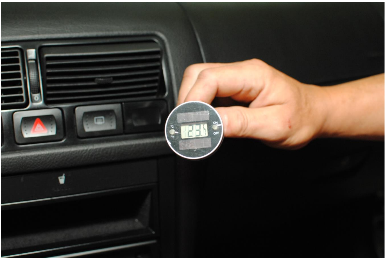
Obr. 1 : Teploměr teploty vzduchu klimatizace
