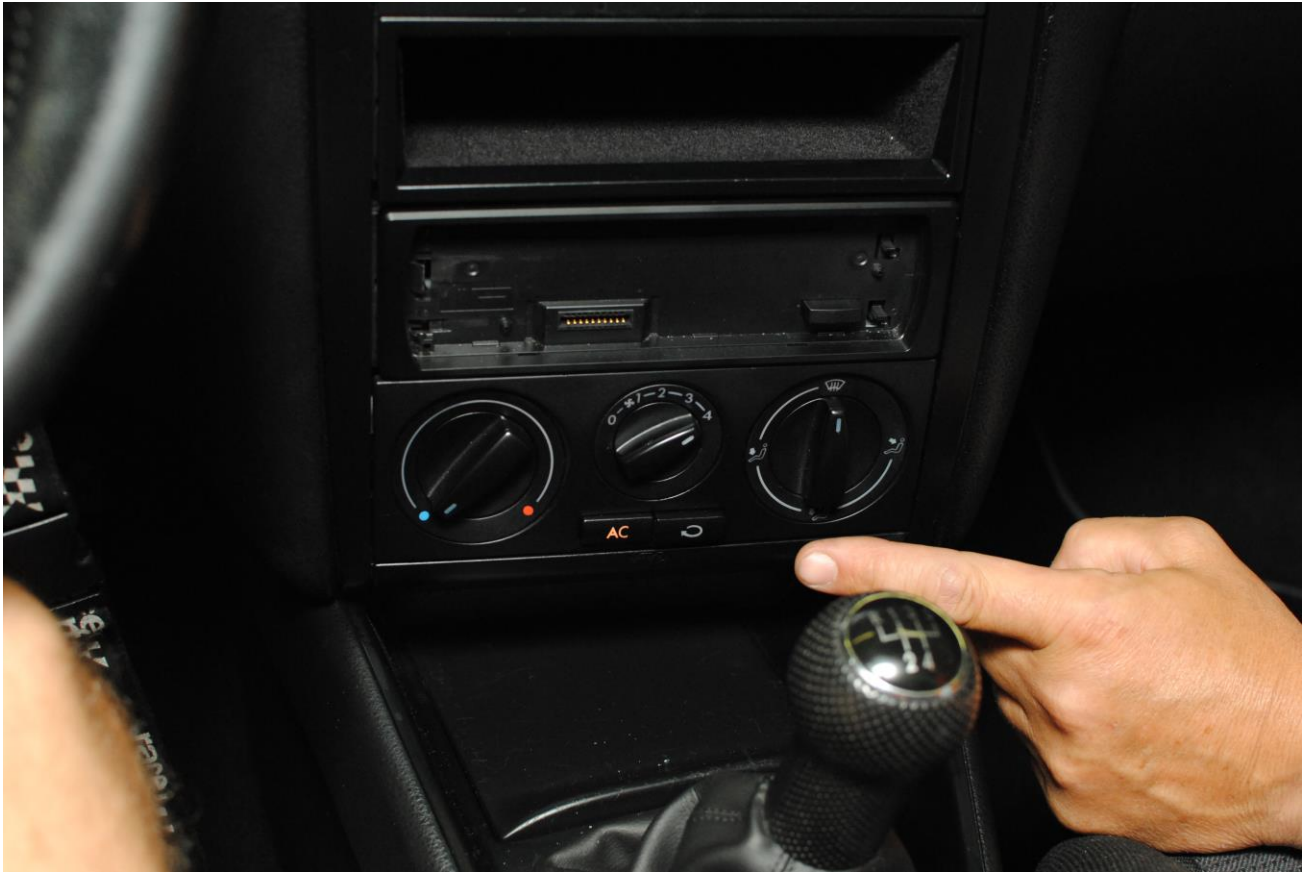
Obr. 7: Zapneme klimatizaci, nastavíme max. chlad a ventilátor na max. otáčky
