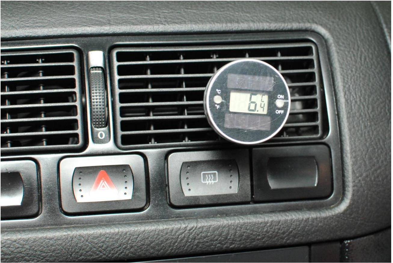
Obr. 9: Teplota by měla klesnout na teplotu okolo 5°C:
