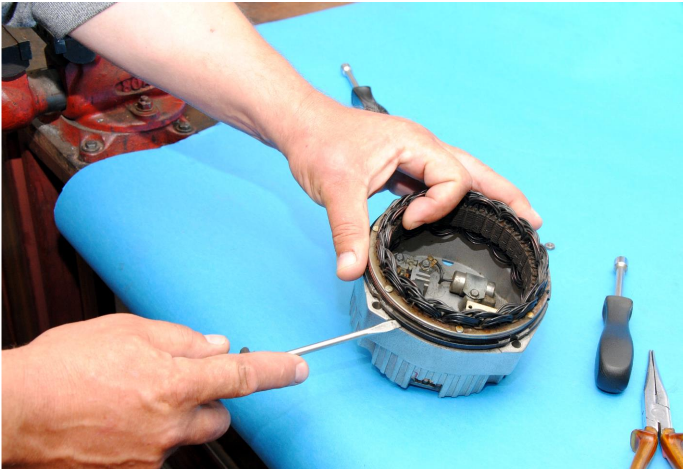
Obr. 8: Postupné uvolnění statorového vinutí
