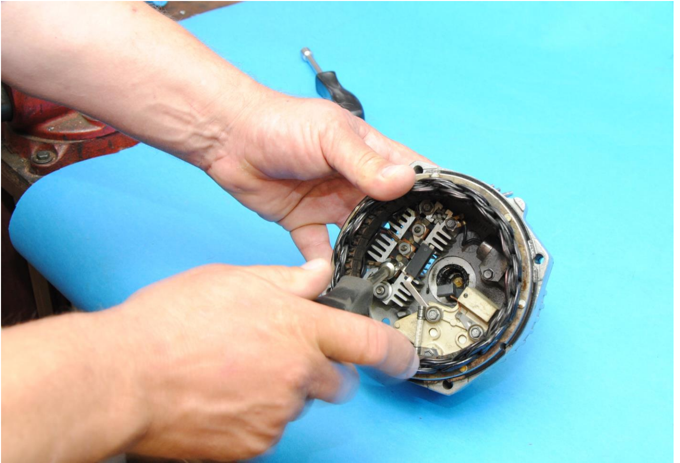
Obr. 7: Demontáž vodičů statorového vinutí z diodového můstku
