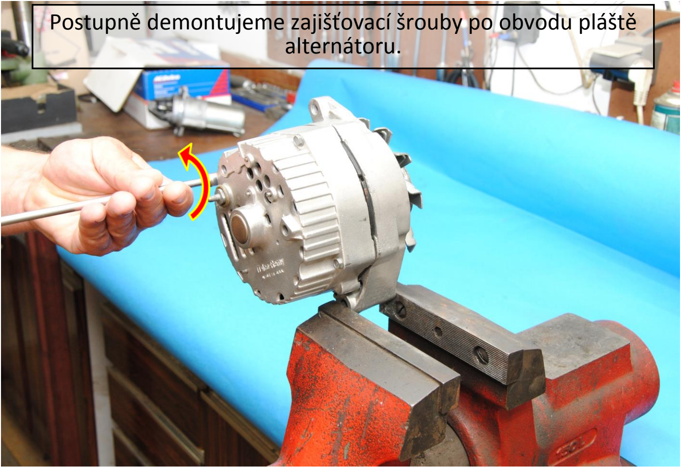
Obr. 3: Demontáž pláště alternátoru
