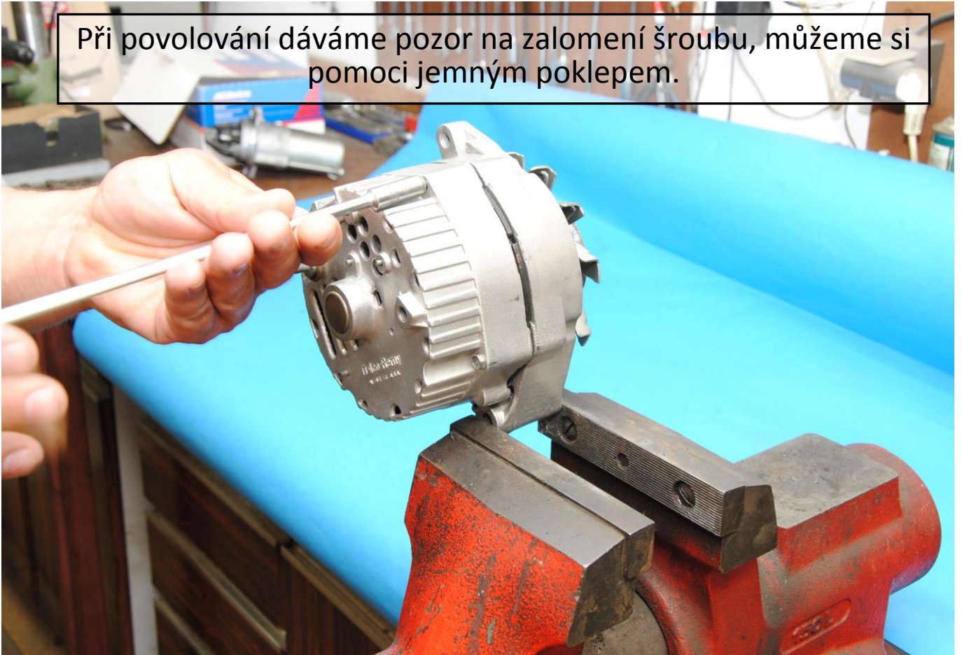
Obr. 4: Demontáž pláště alternátoru
